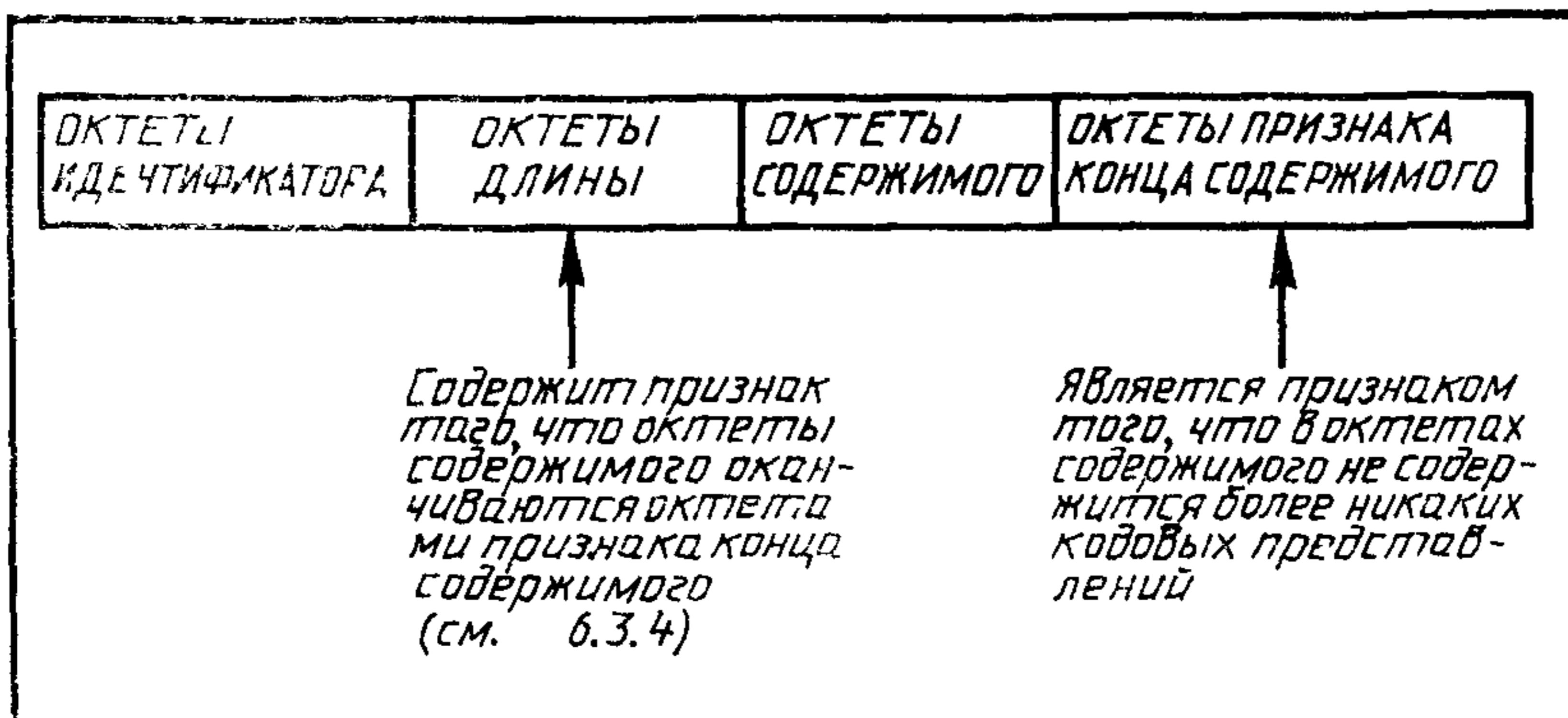
Рисунок 2 Один из вариантов составного кодового представления
