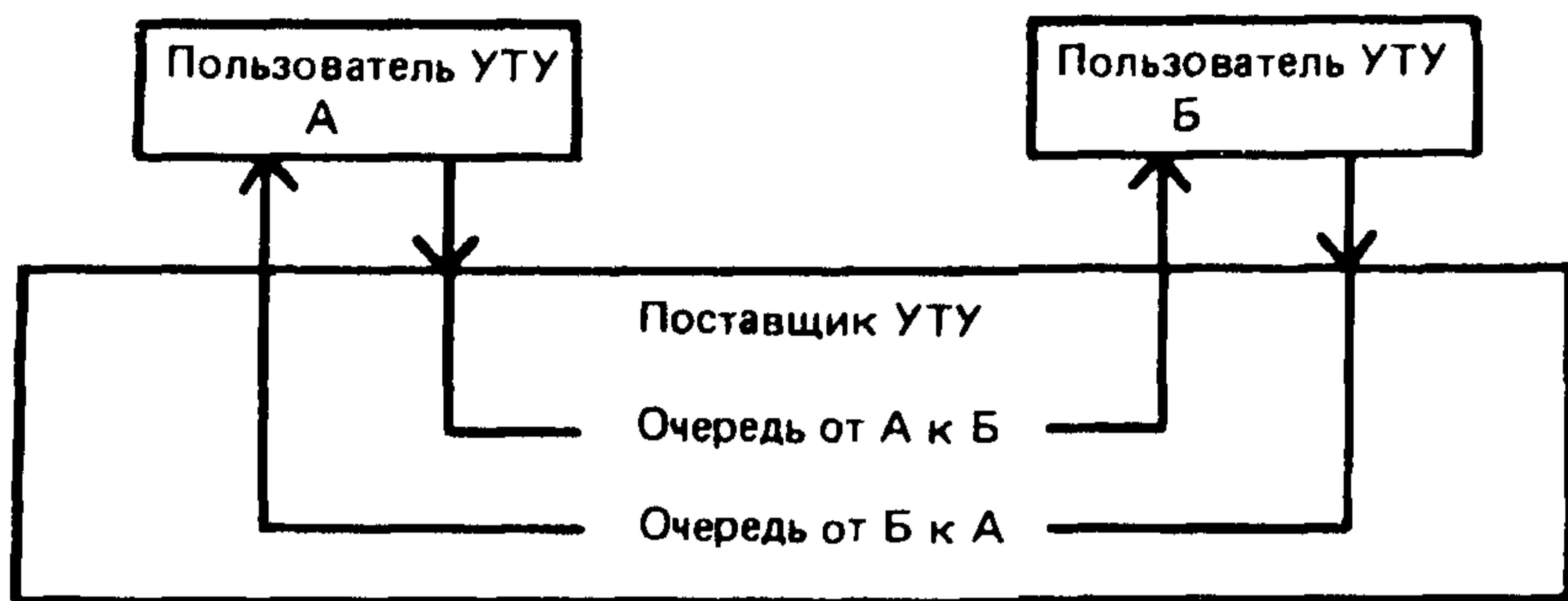
Рисунок 1 — Абстрактная модель соединения транспортного уровня
