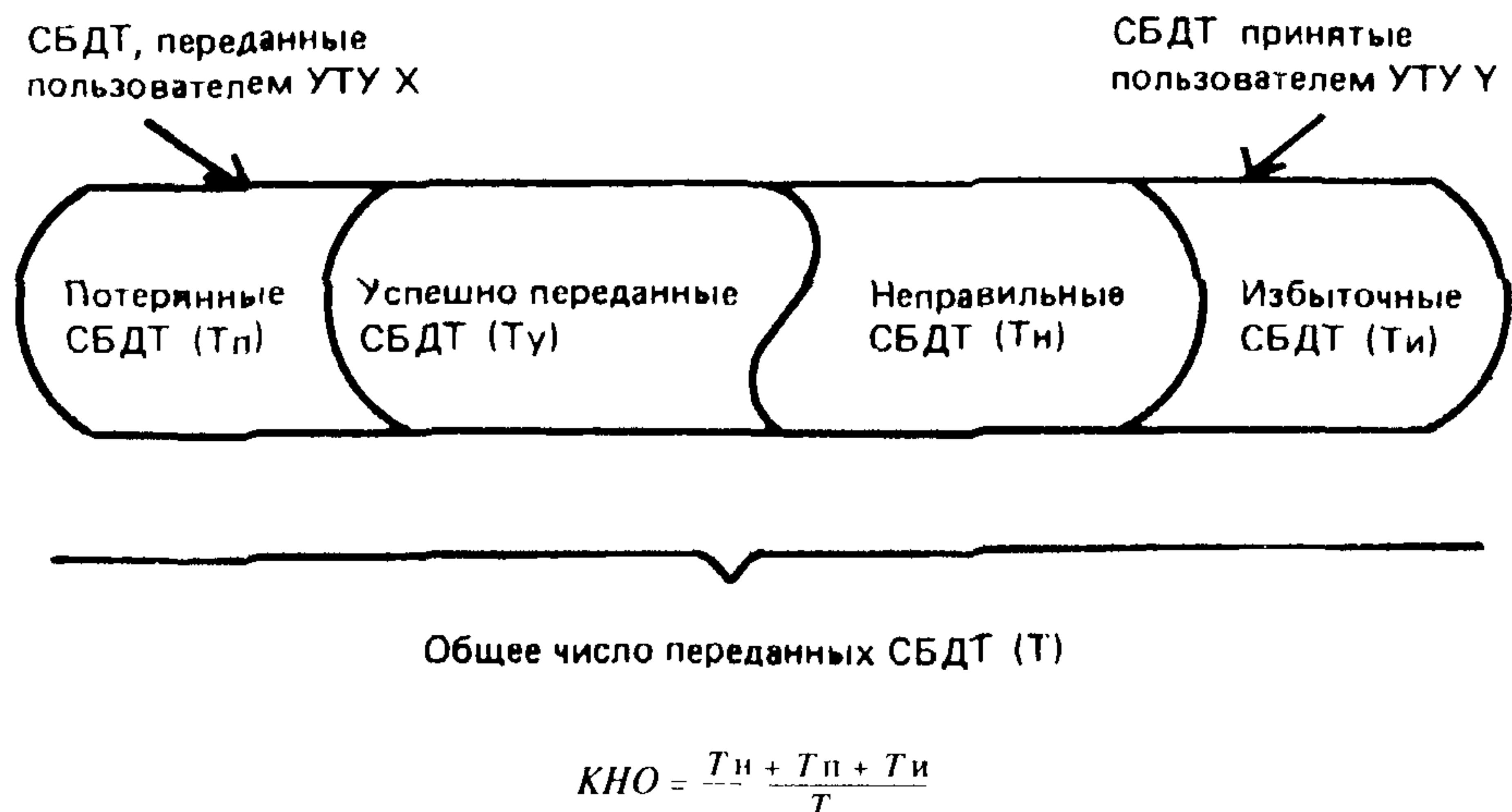
Рисунок 2 — Компоненты коэффициента необнаруженных ошибок
