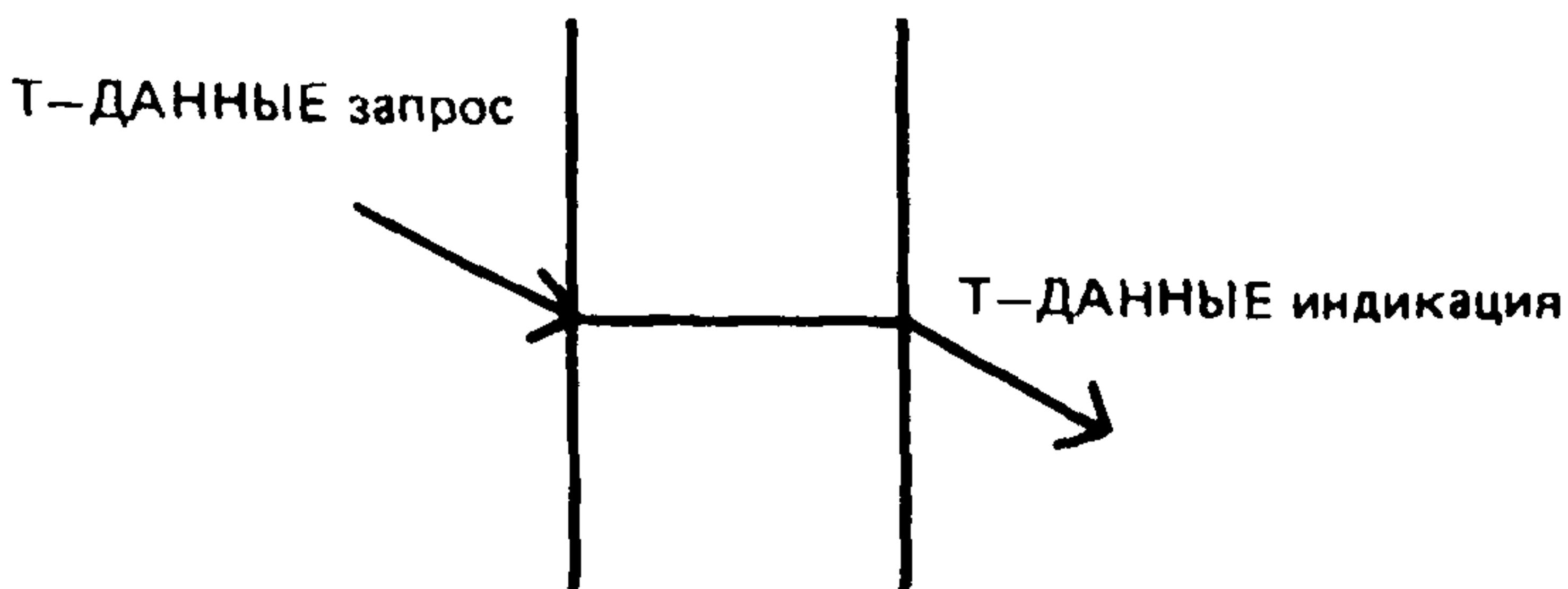
Рисунок 6 — Последовательность примитивов при успешной передаче данных
