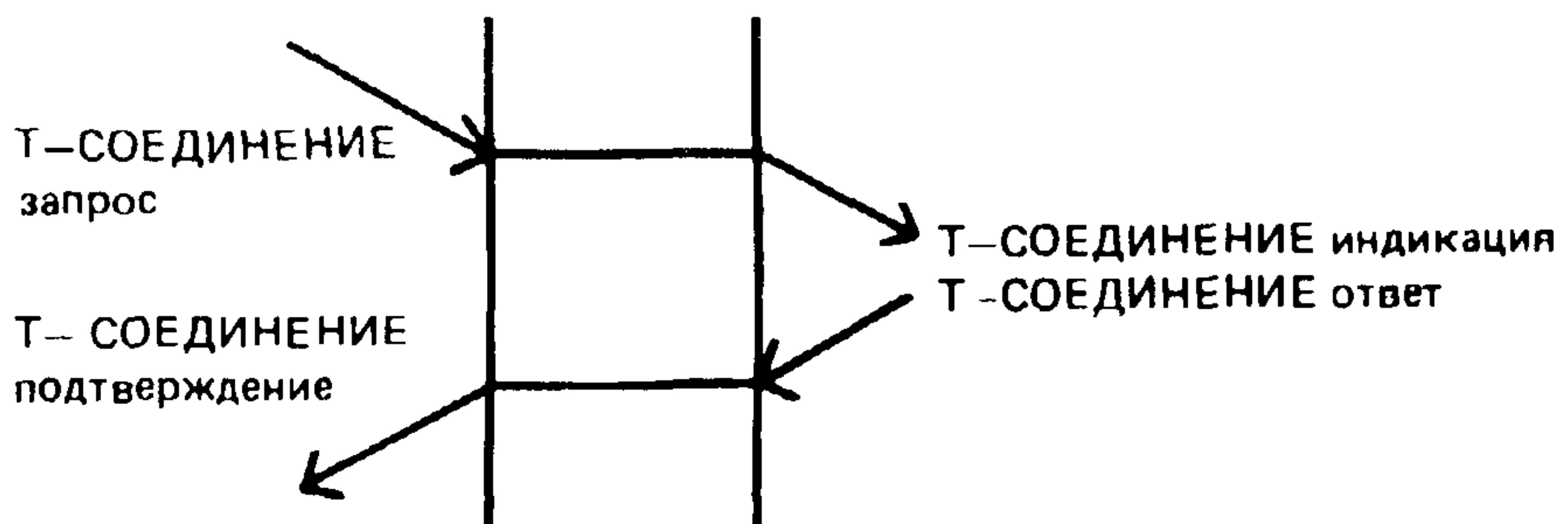
Рисунок 5 – Последовательность примитивов при успешном установлении СТУ
