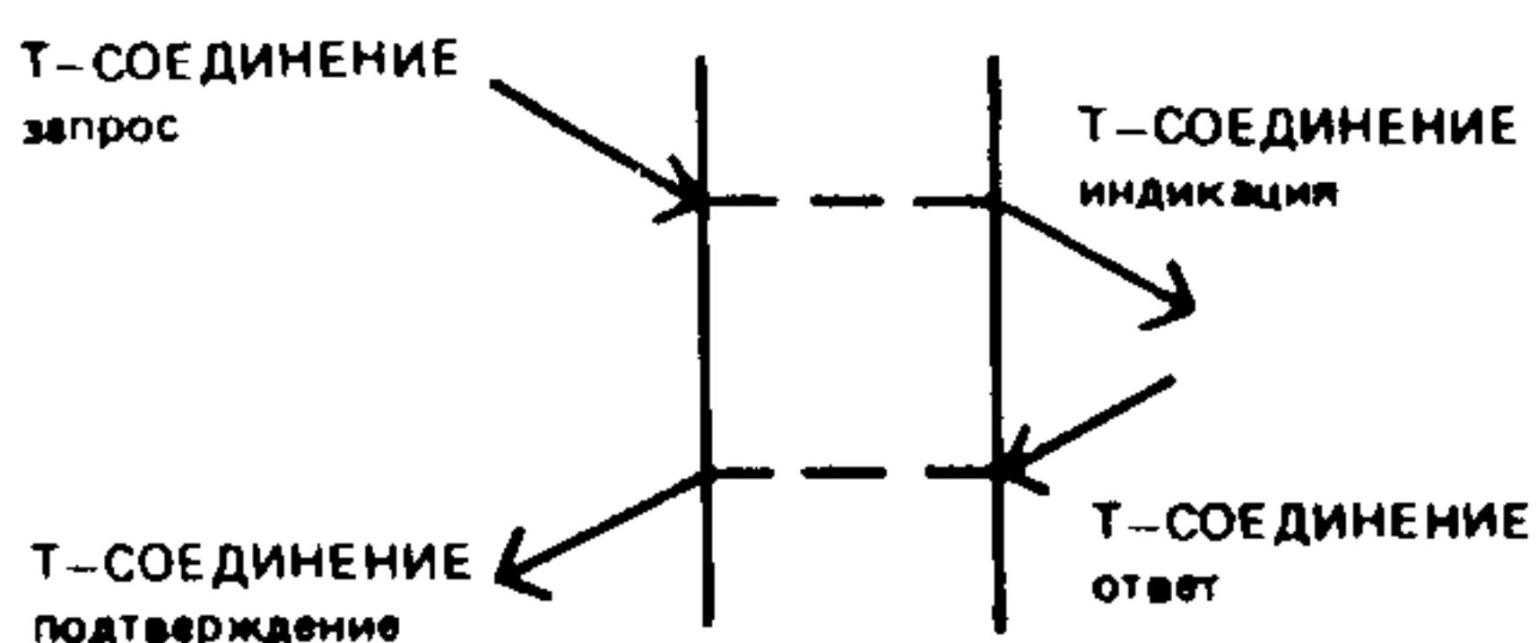
**Отклонение пользователем УТУ запроса на установление СТУ**
