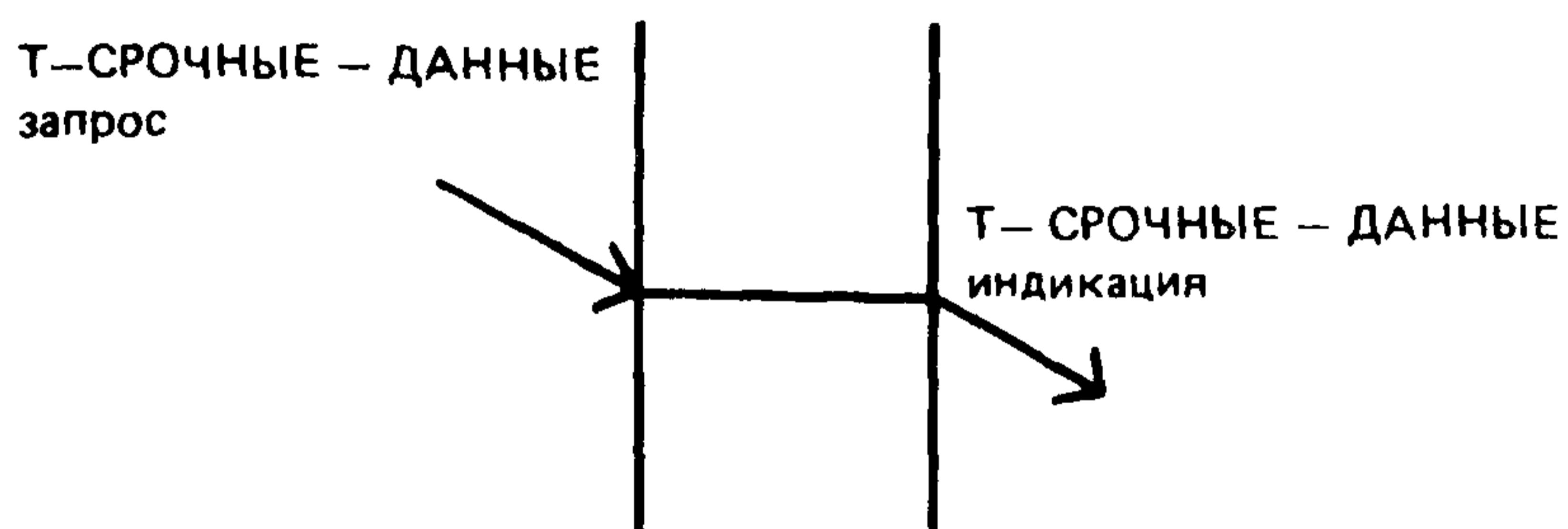
Рисунок 7 — Последовательность примитивов при успешной передаче срочных данных
