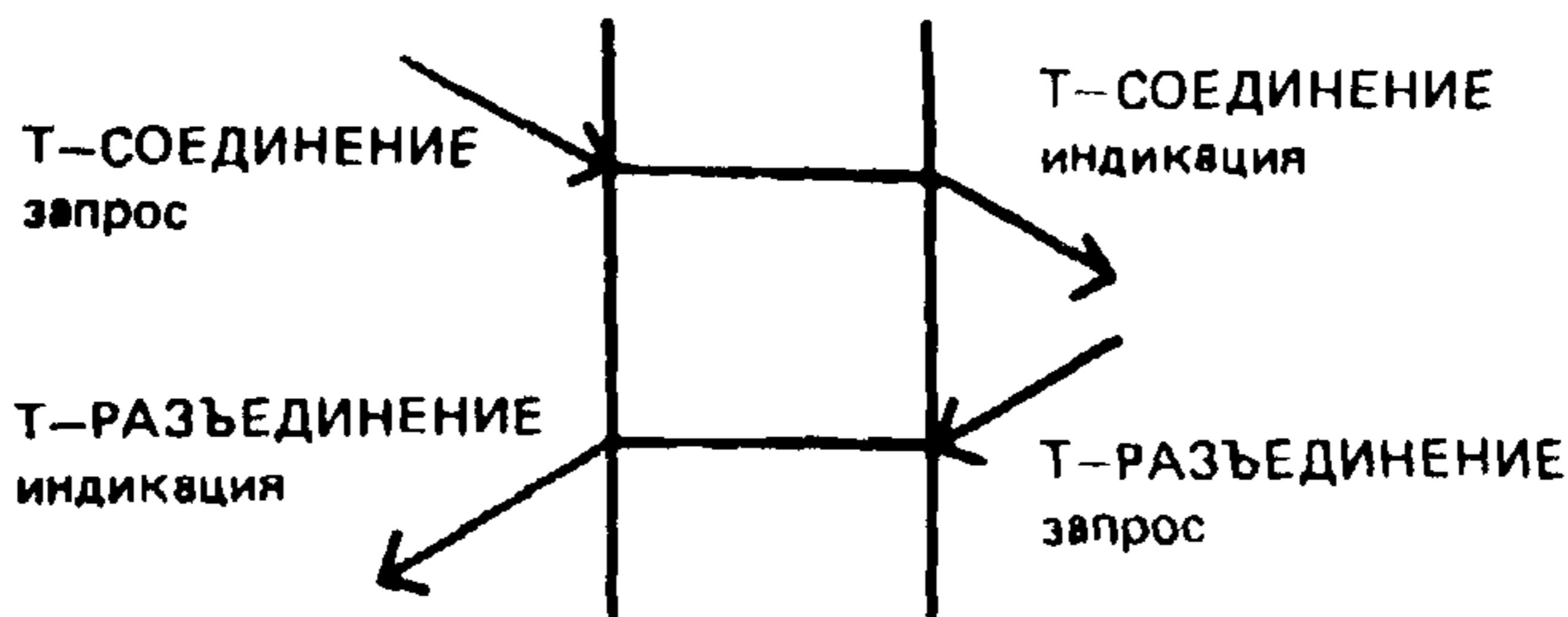
Рисунок 12 – Последовательность примитивов УТУ при отклонении пользователем УТУ попытки установления СТУ
