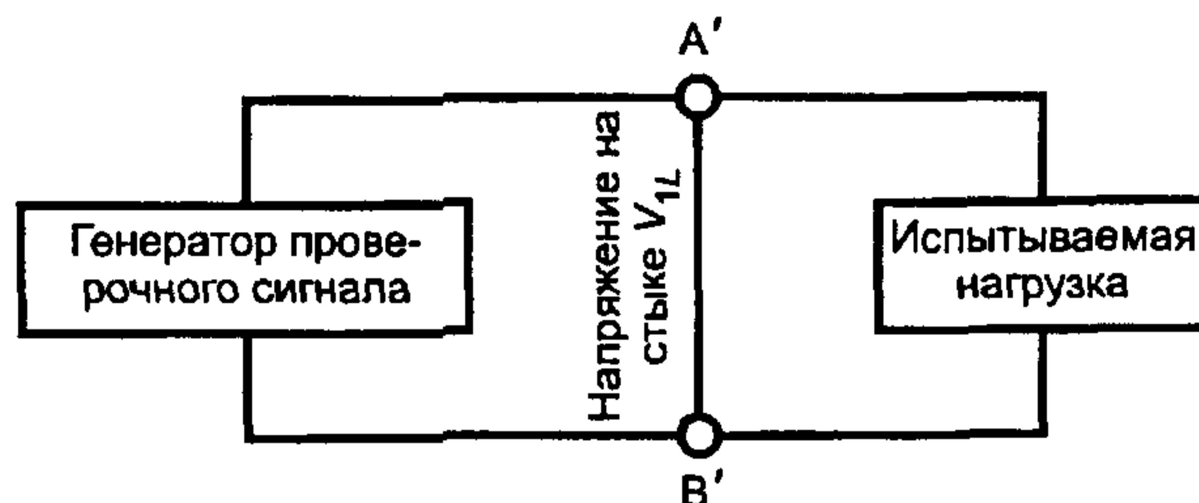
Рисунок 6 — Испытательная схема для измерения нагрузок по V.11
