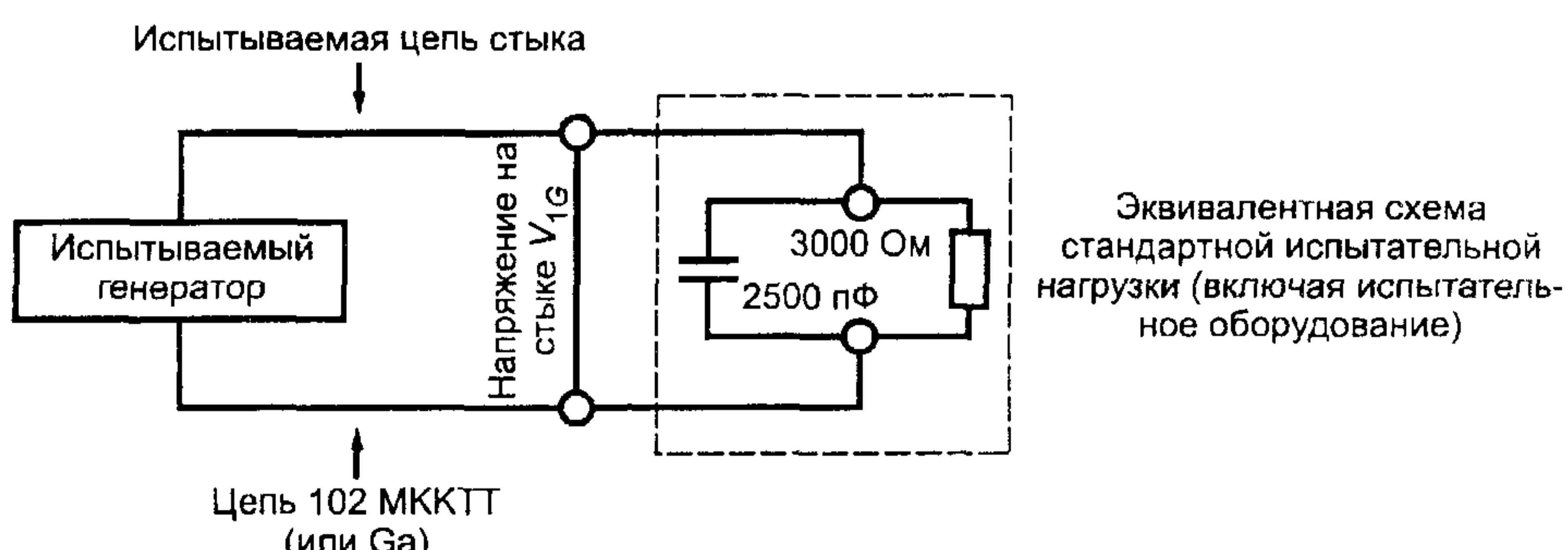
Рисунок 1 — Испытательная схема для генераторов по V.28
