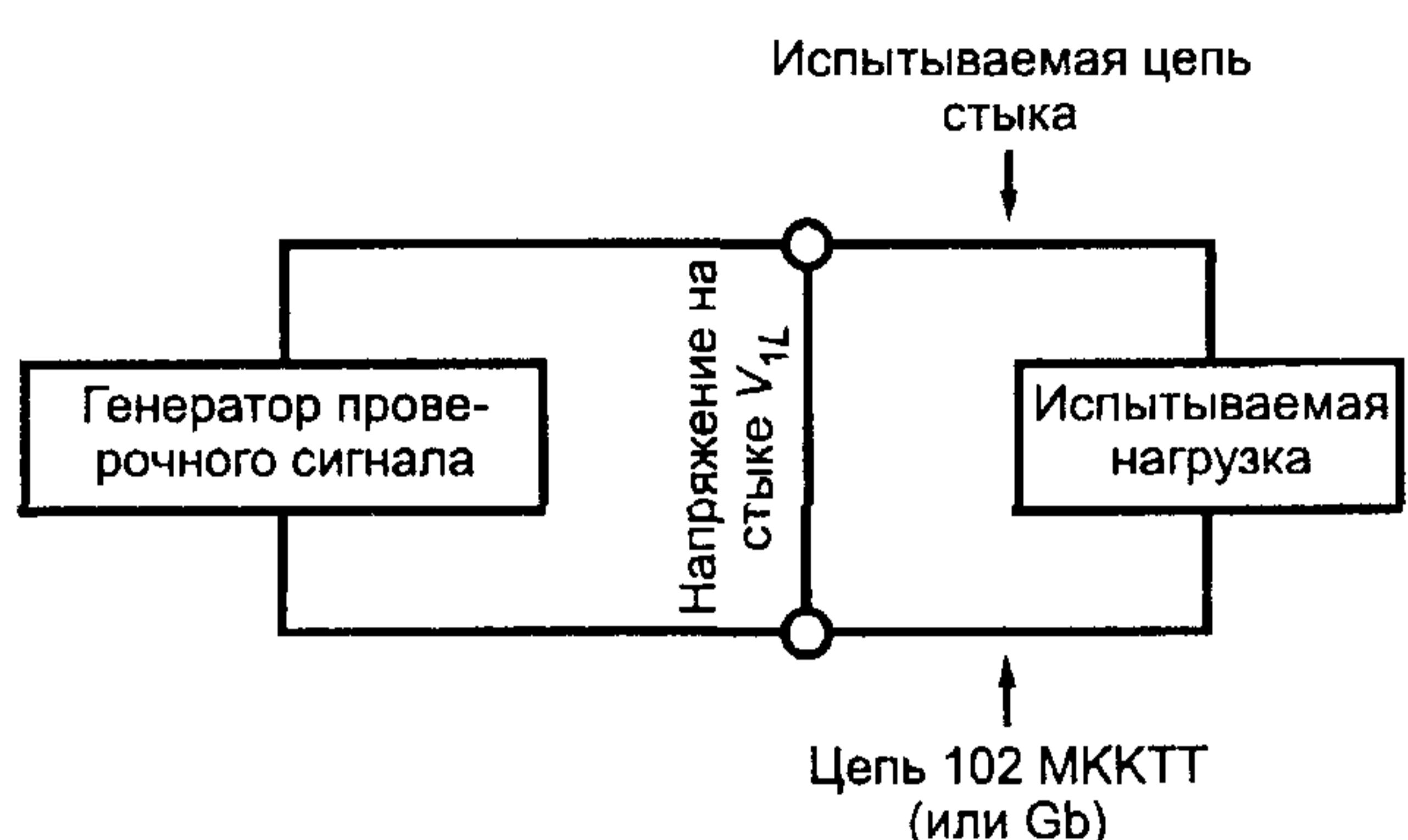
Рисунок 2 — Испытательная схема для нагрузки V.28
