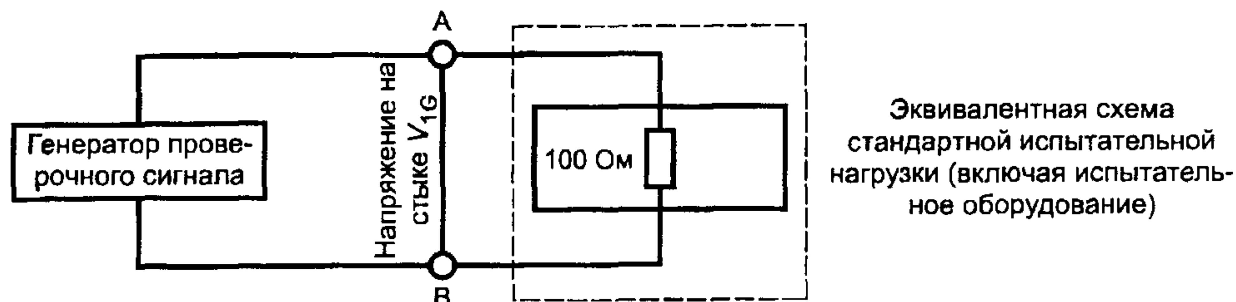
Рисунок 5 — Испытательная схема для измерения генераторов по V.11
