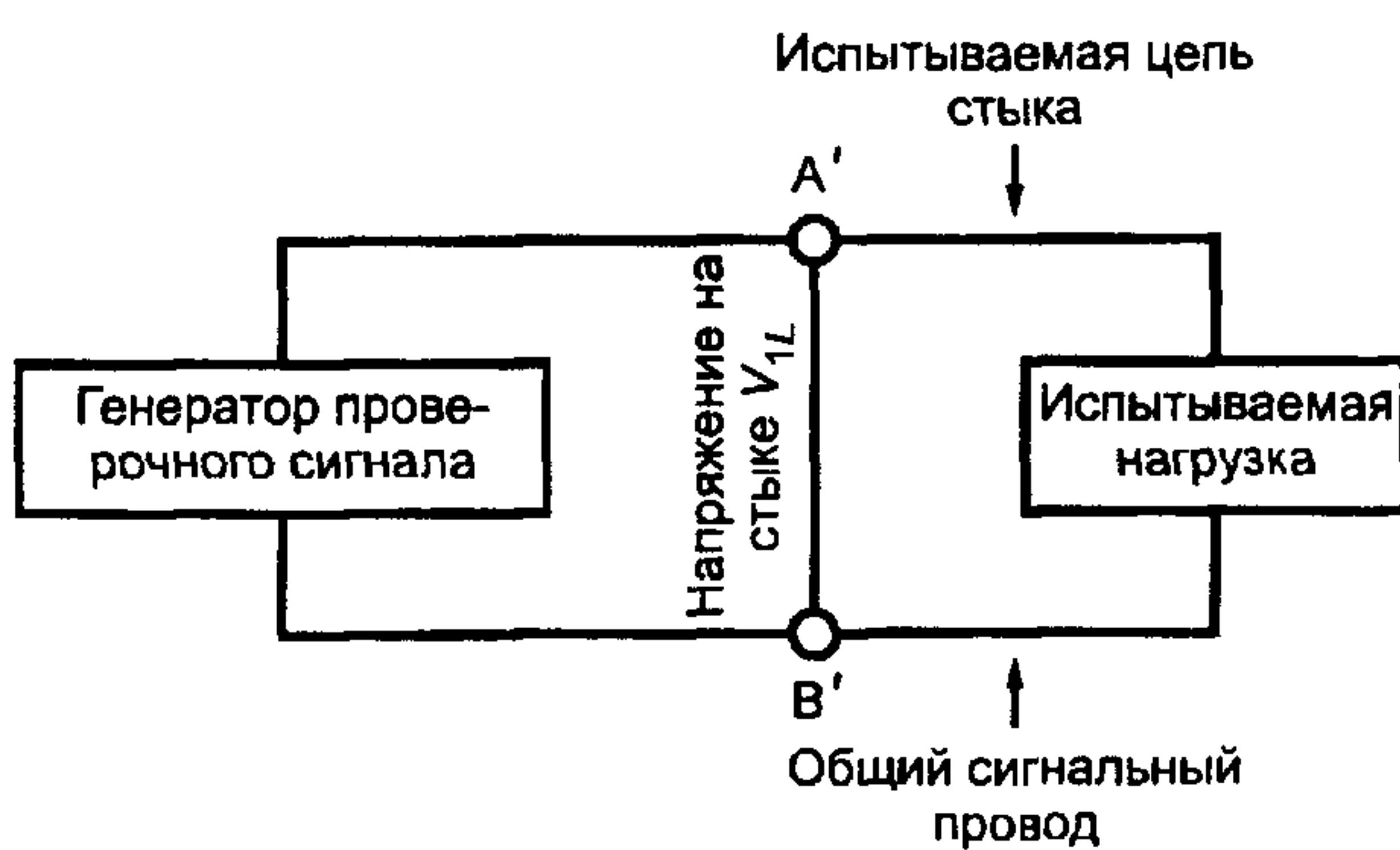
Рисунок 4 — Испытательная схема для измерения нагрузки V.10
