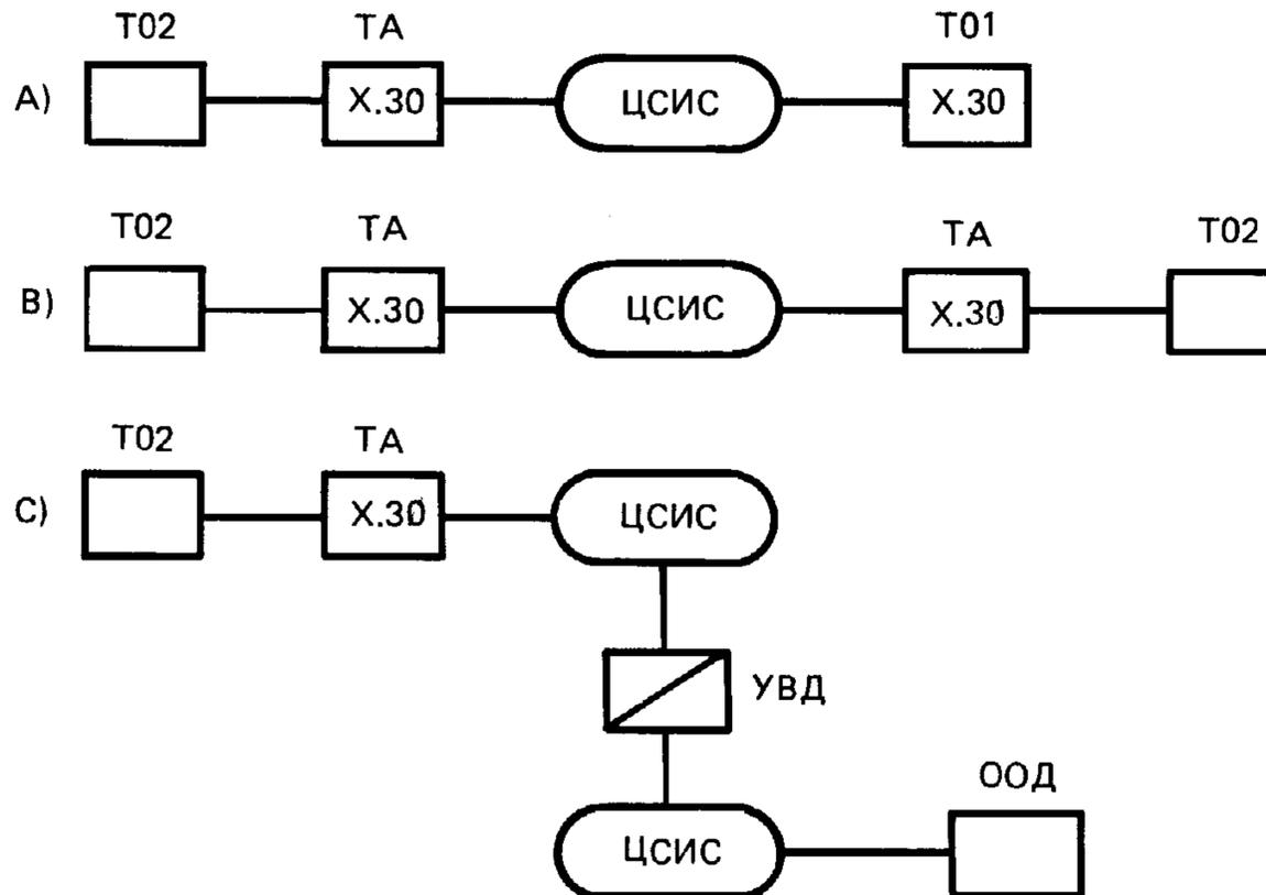
Сценарий А действителен только в том случае, если ТА обеспечивает для Т02 скорость передачи 64 кбит/с (класс обслуживания абонентов 19 согласно Рекомендации X.1). Для всех остальных классов обслуживания абонентов ЦСИС используется как центральная сеть при обеспечении услуг СДКК.
