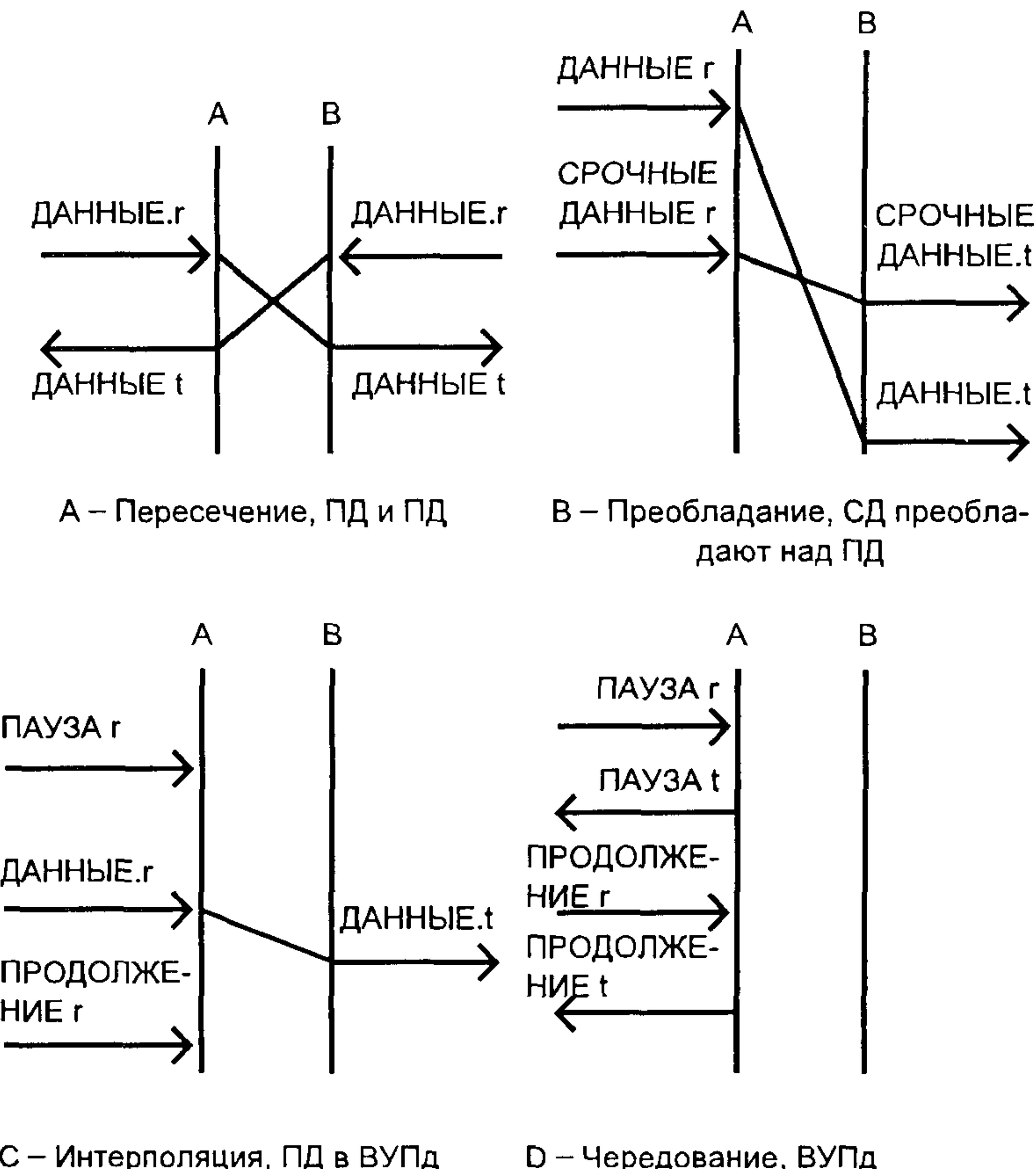
Рисунок 11 — Непрямые комбинации элементарных последовательностей
