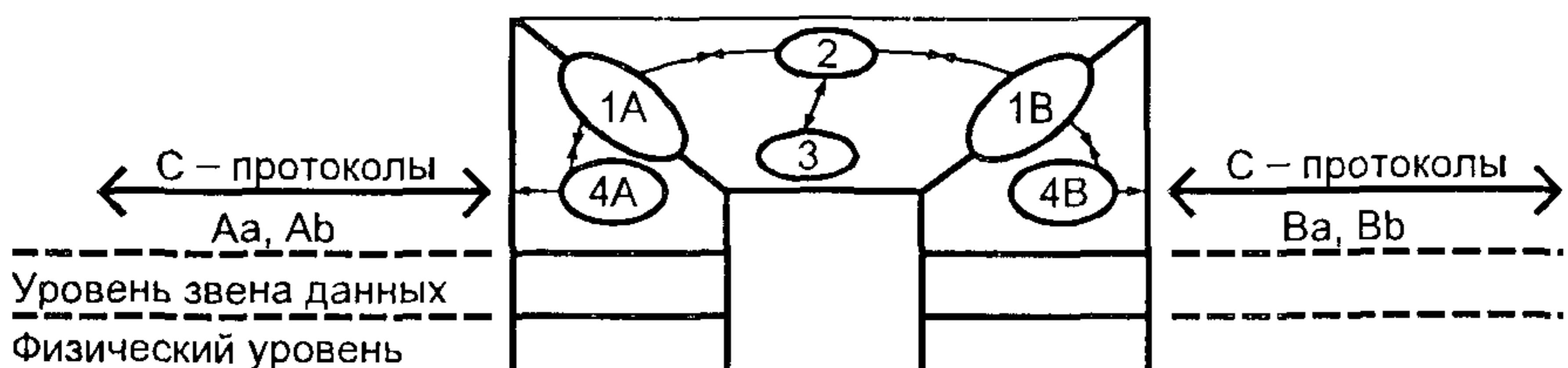
Рисунок 1 — Модель промежуточной системы
