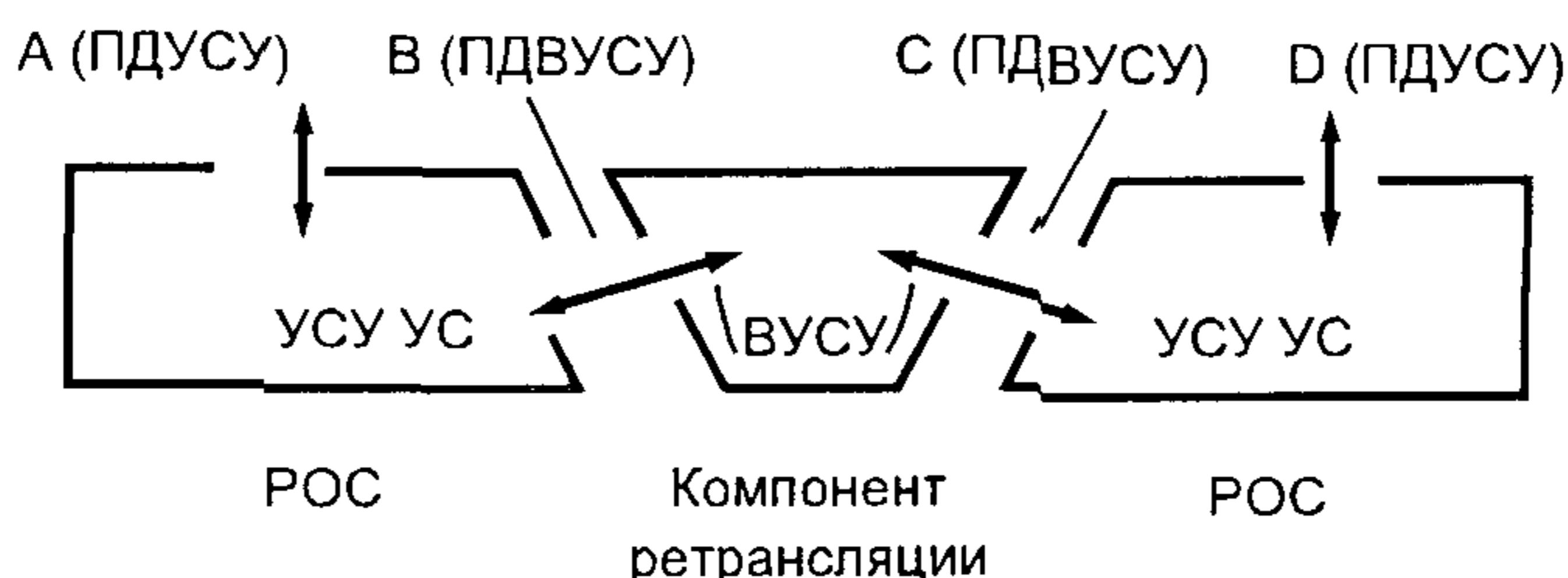
Рисунок С.2 — Модель ретрансляции на сетевом уровне
