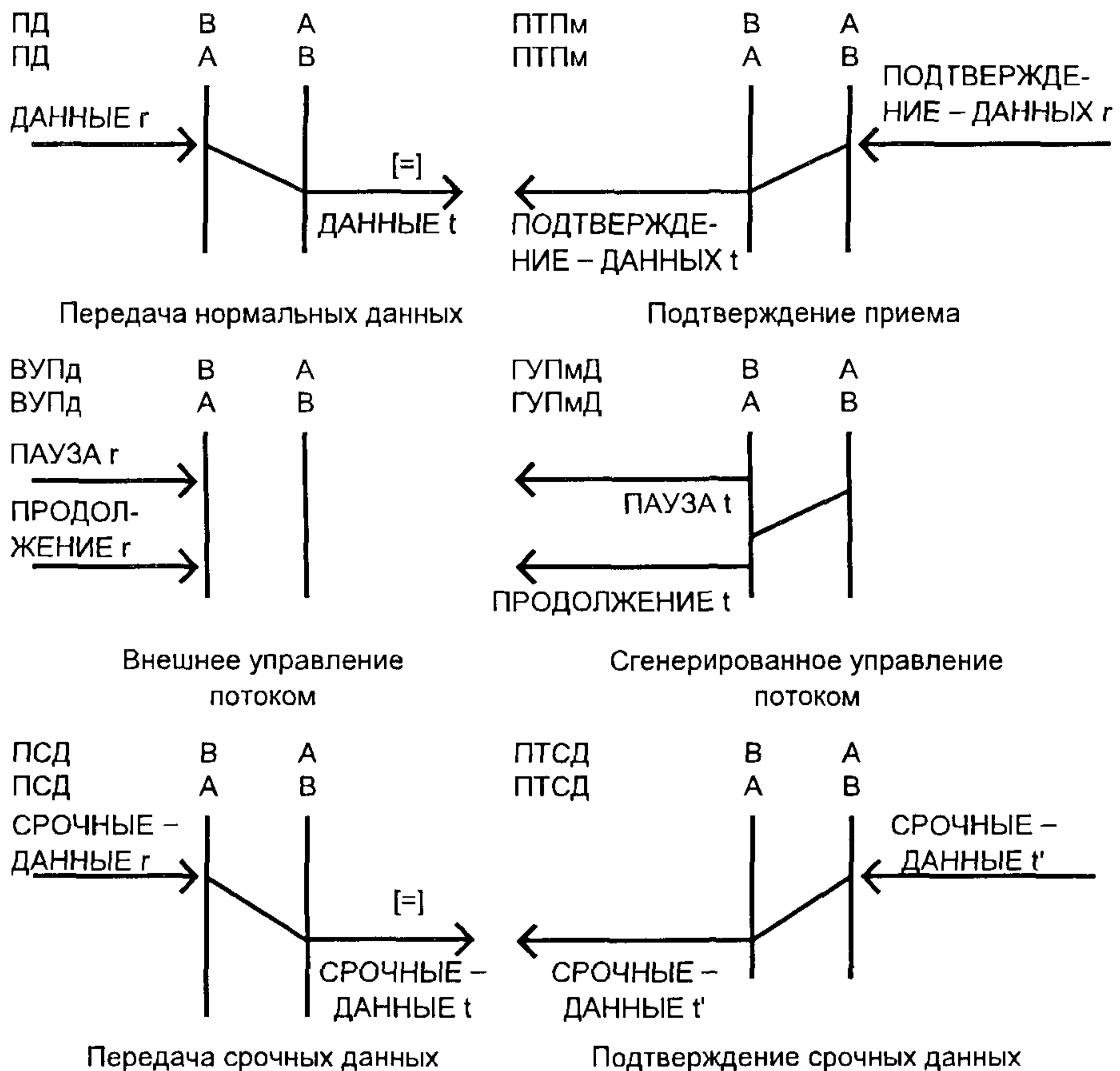
Рисунок 7 — Передача данных, подфаза «передача»
