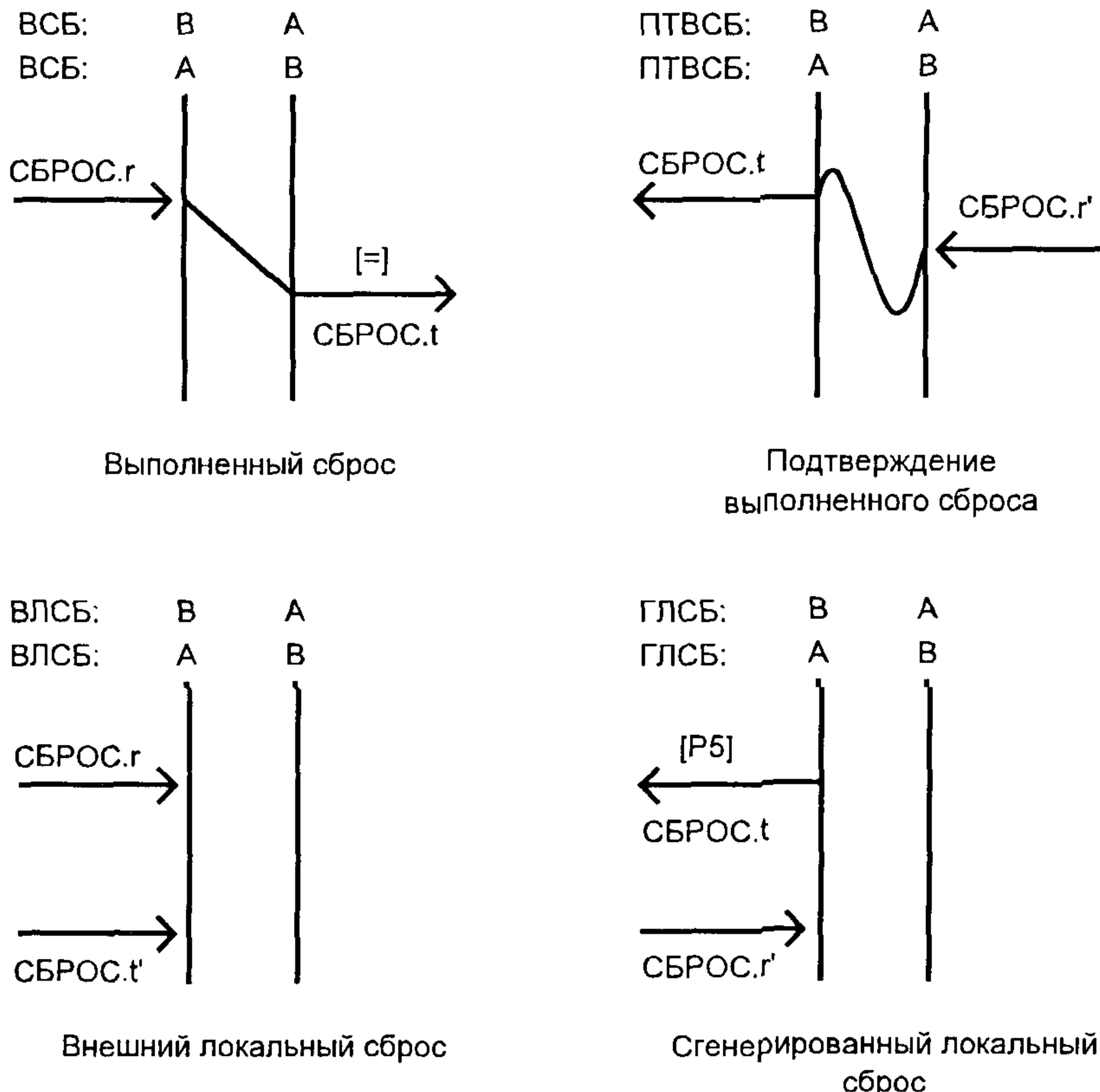
Рисунок 8 — Передача данных, подфаза «сброс»
