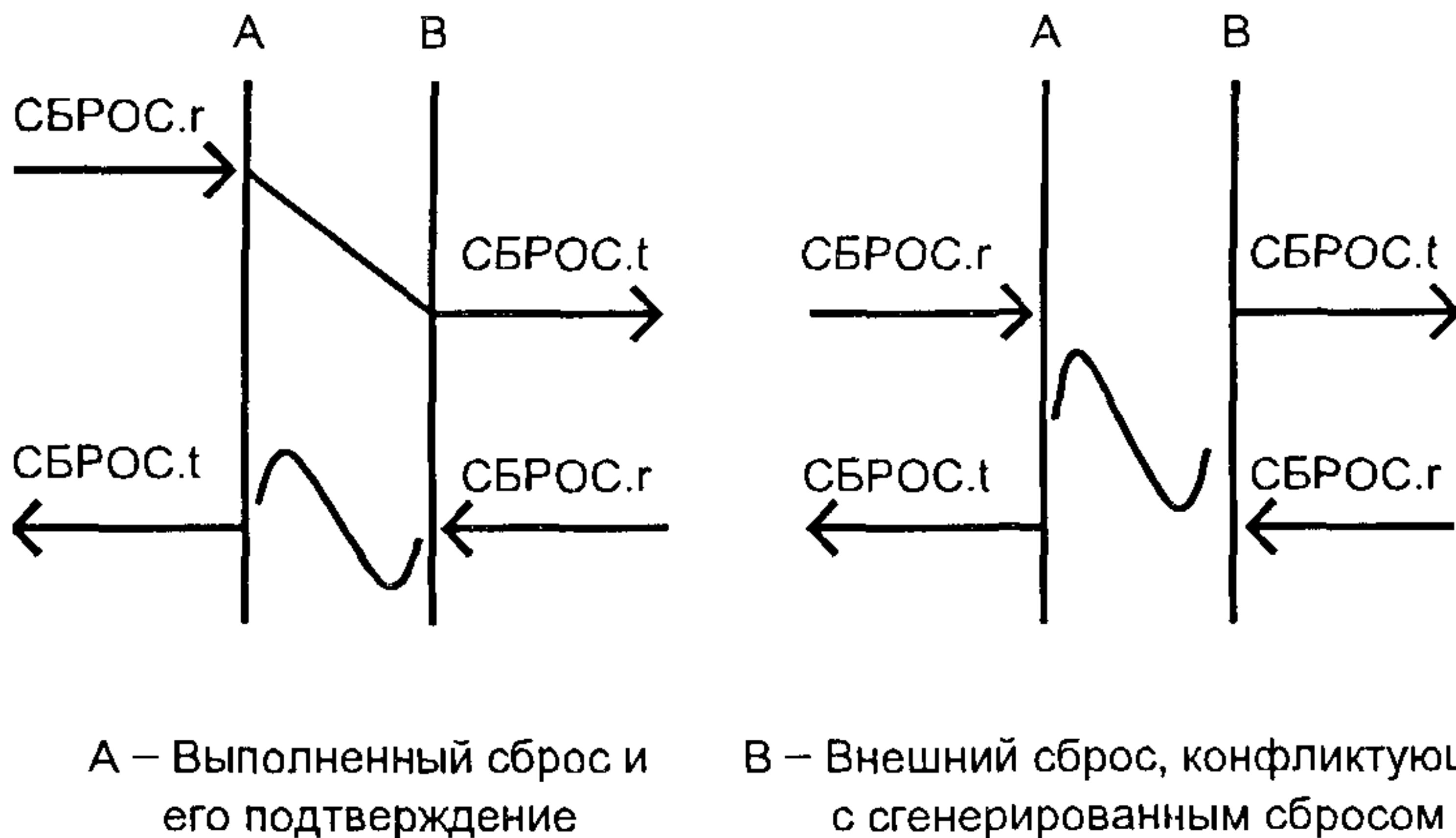
Рисунок 13 — Примеры базового сброса
