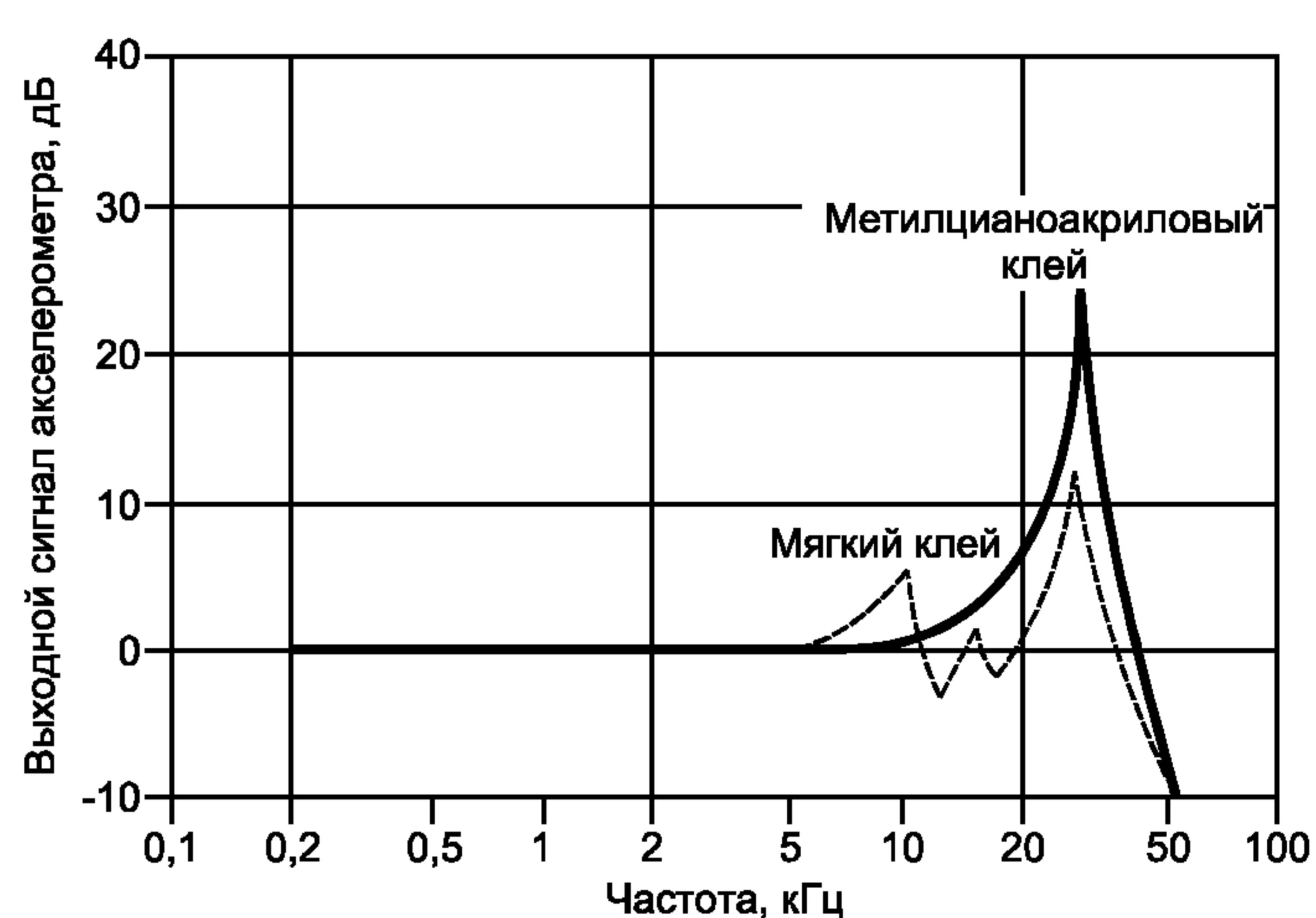
Рисунок 6 — Типичная частотная характеристика акселерометра при kleевом соединении
