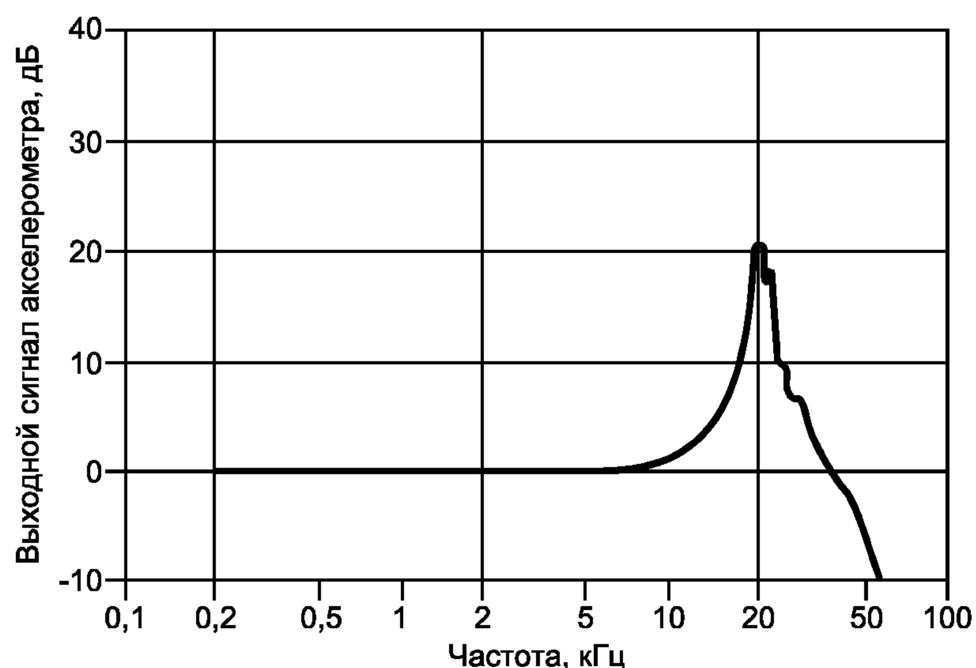
Рисунок 9 — Типичная частотная характеристика акселерометра на магните
