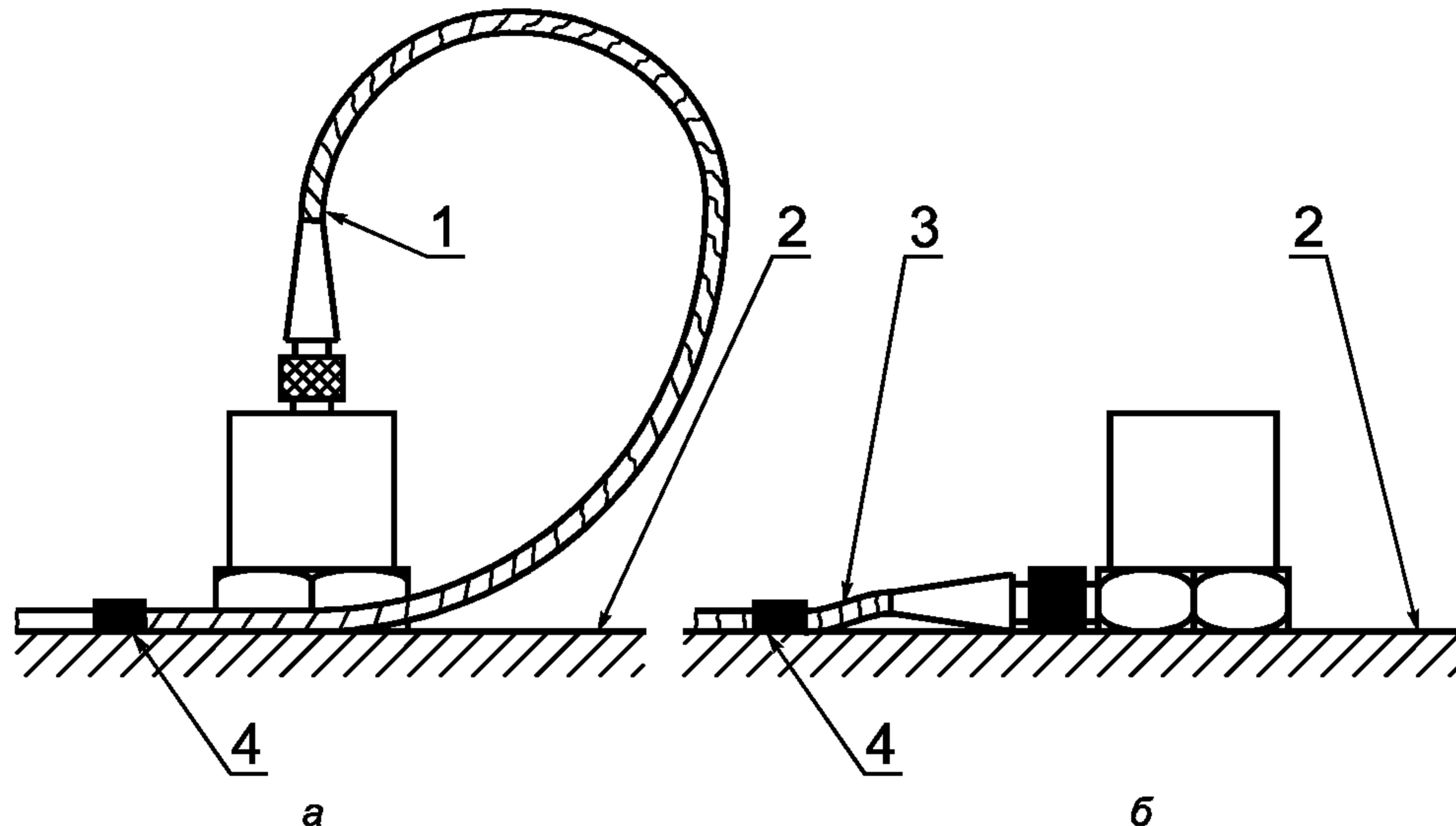
*a* — осевое соединение кабеля; *б* — радиальное соединение кабеля
