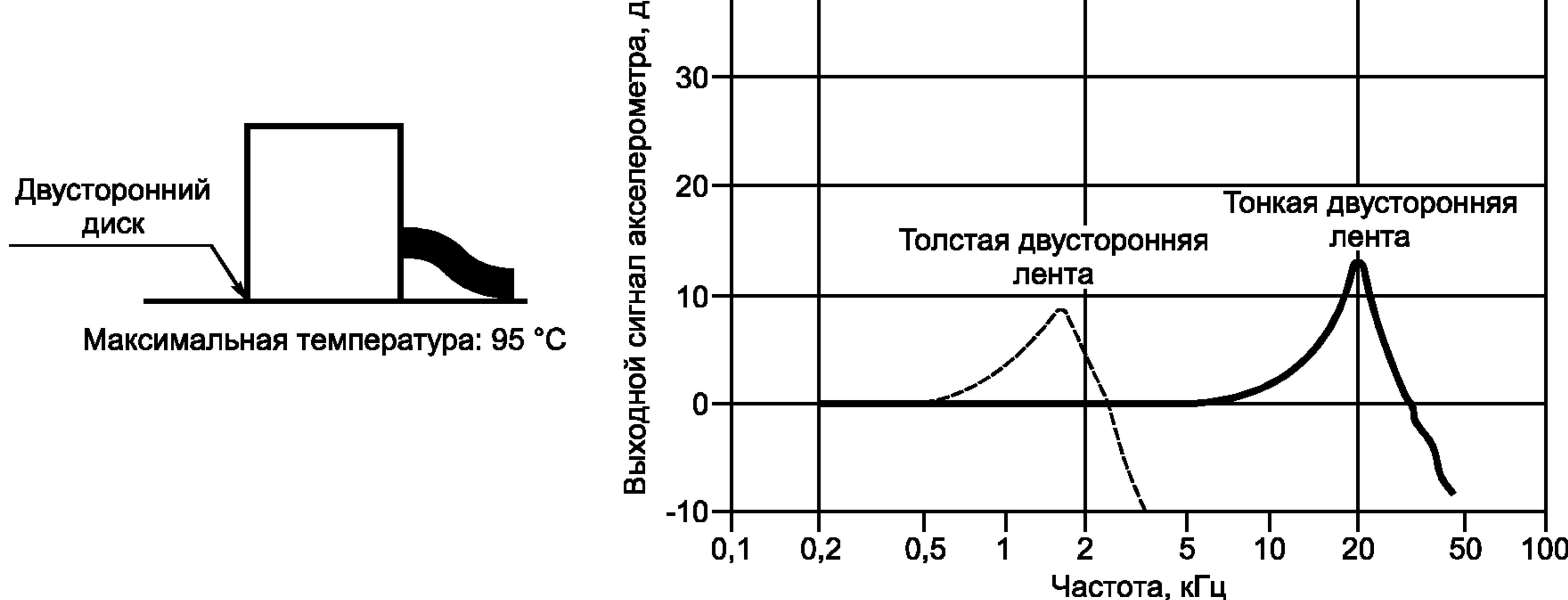
Рисунок 7 — Типичная частотная характеристика акселерометра, установленного с помощью ленты с двусторонней kleющей поверхностью
