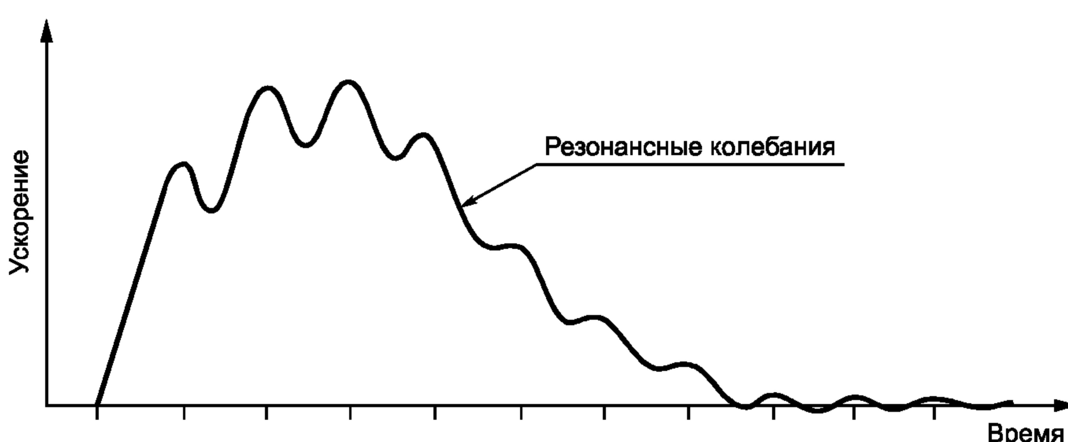
Рисунок 4 — Отклик акселерометра на удар
