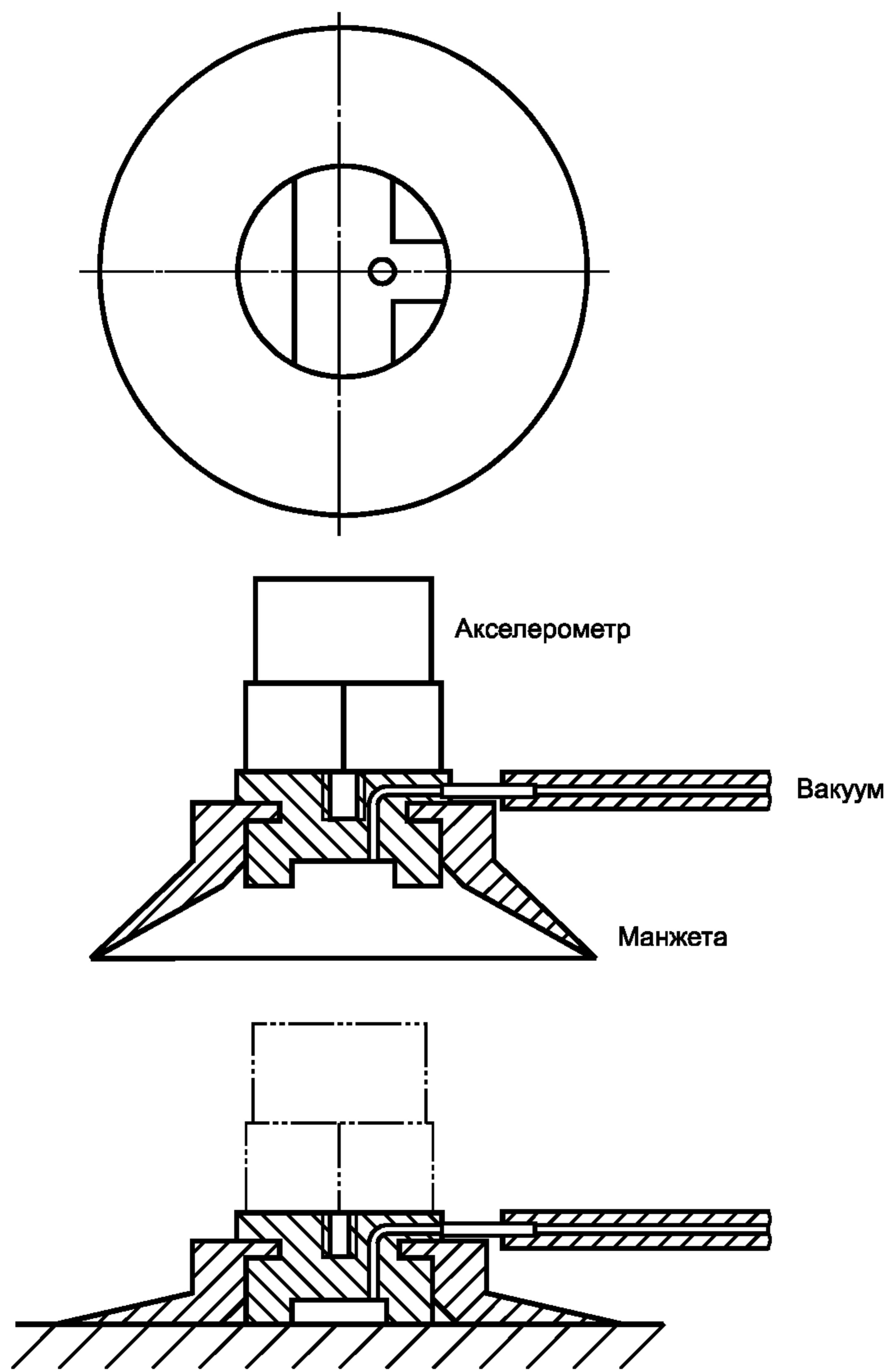
Рисунок 11 — Вакуумное крепление
