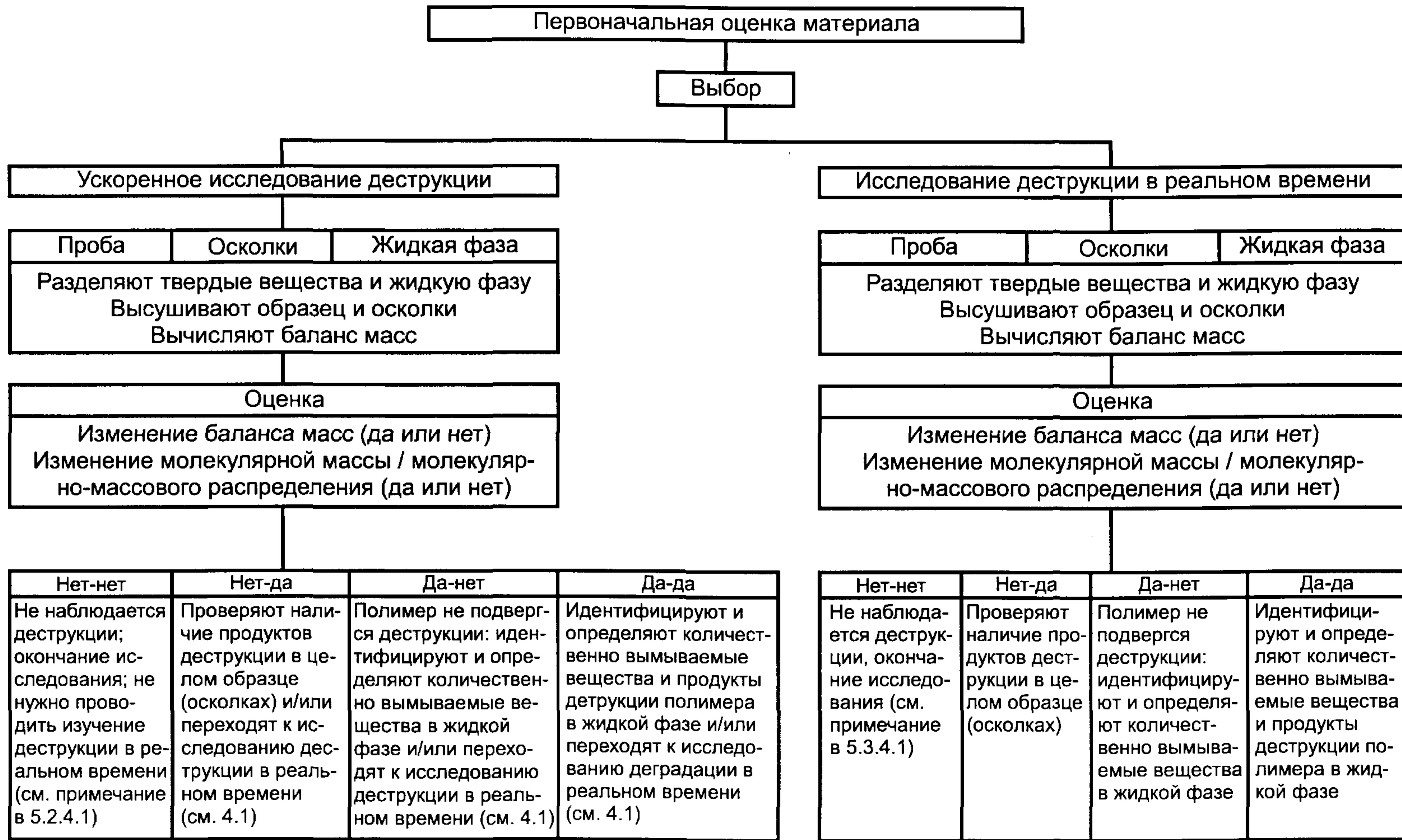
Рисунок 1 — Последовательность этапов исследования
