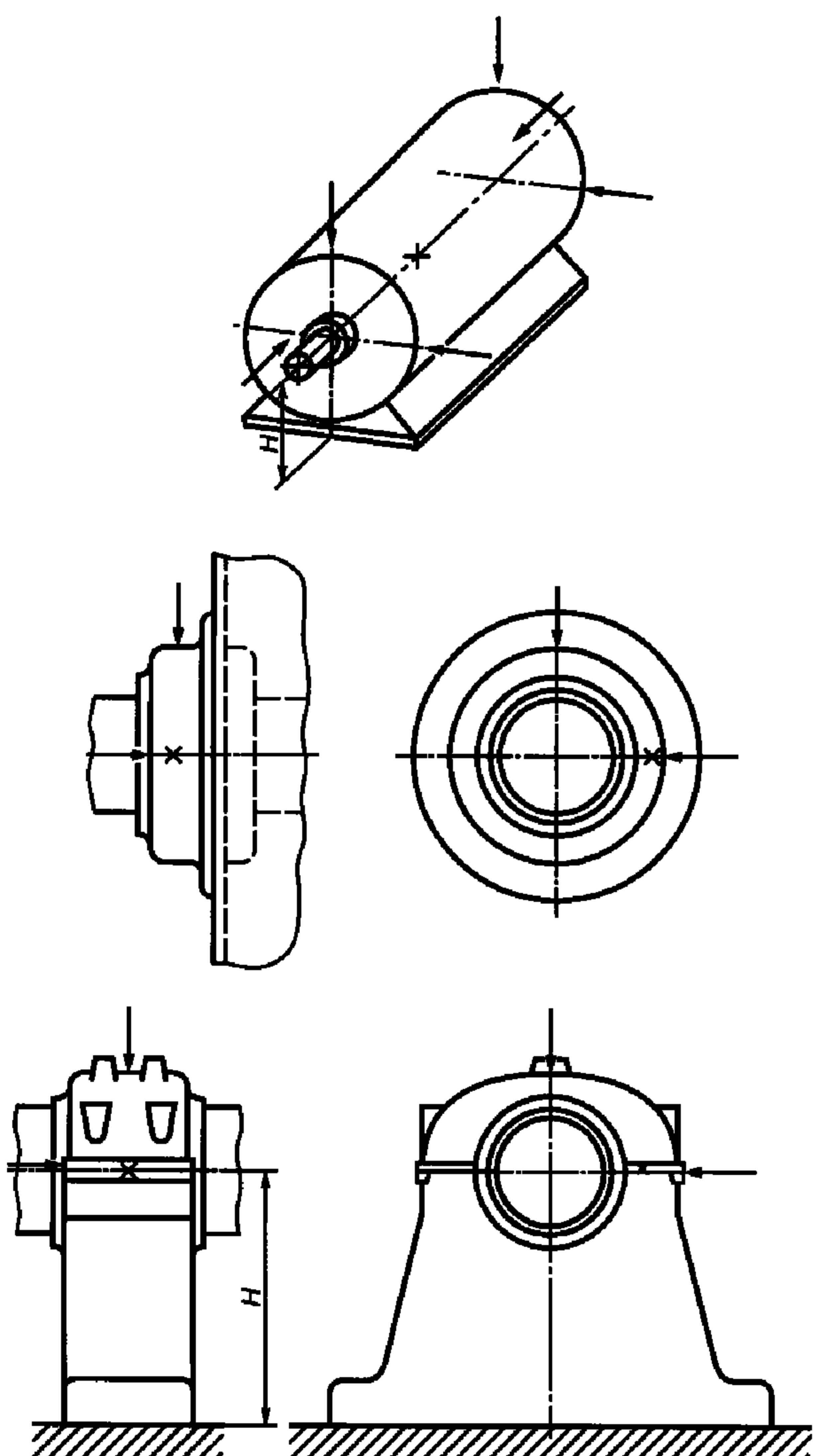
Рисунок 1 — Расположение точек измерений
