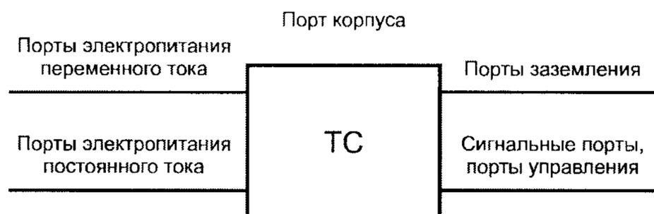
Рисунок 1 — Примеры портов ТС
