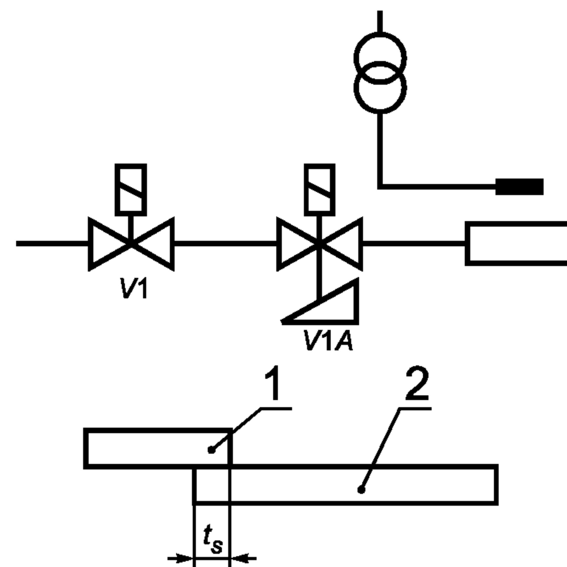
*V1* — основной предохранительный отсечной газовый клапан; *V1A* — основной предохранительный отсечной газовый клапан медленного открытия;  $t_s$  — время безопасности; 1 — зажигание; 2 — основная горелка
