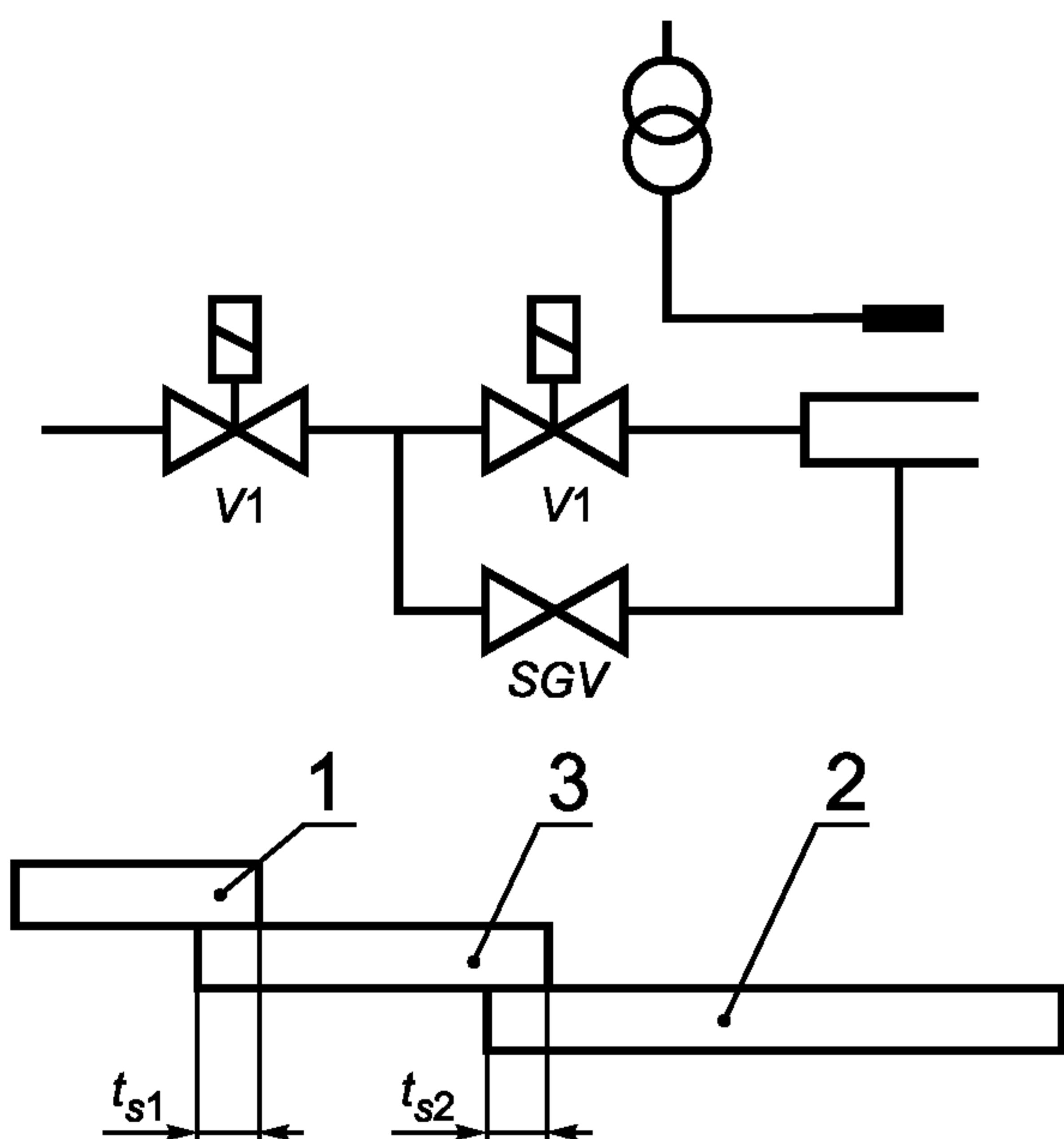
*V1* — основной предохранительный газовый отсечной клапан; *SGV* — предохранительный отсечной клапан подачи пускового газа;  $t_{s1}$  — первое время безопасности;  $t_{s2}$  — второе время безопасности; 1 — зажигание; 2 — основная горелка; 3 — пусковой газ
