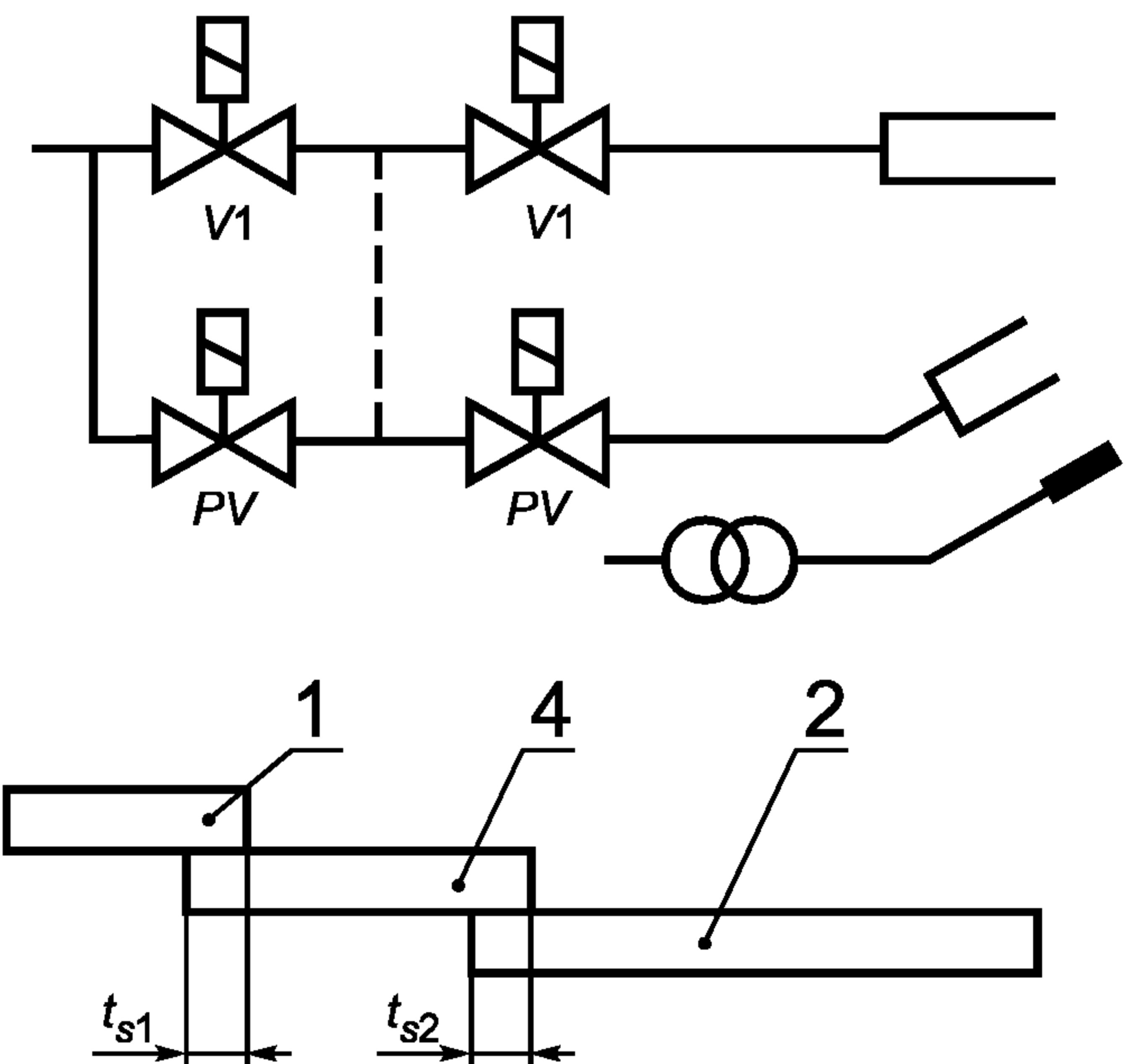
*V1* — основной предохранительный газовый отсечной клапан; *PV* — предохранительный отсечной клапан запальной горелки;  $t_{s1}$  — первое время безопасности;  $t_{s2}$  — второе время безопасности; 1 — зажигание; 2 — основная горелка; 4 — пилот
