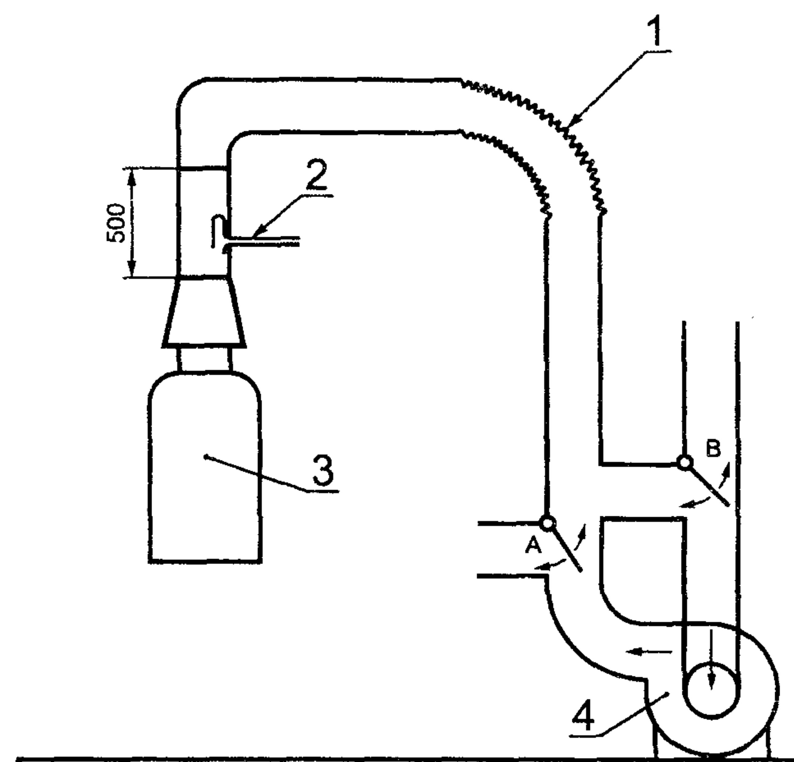
Рисунок 2 — Испытание аппарата при особых условиях тяги
