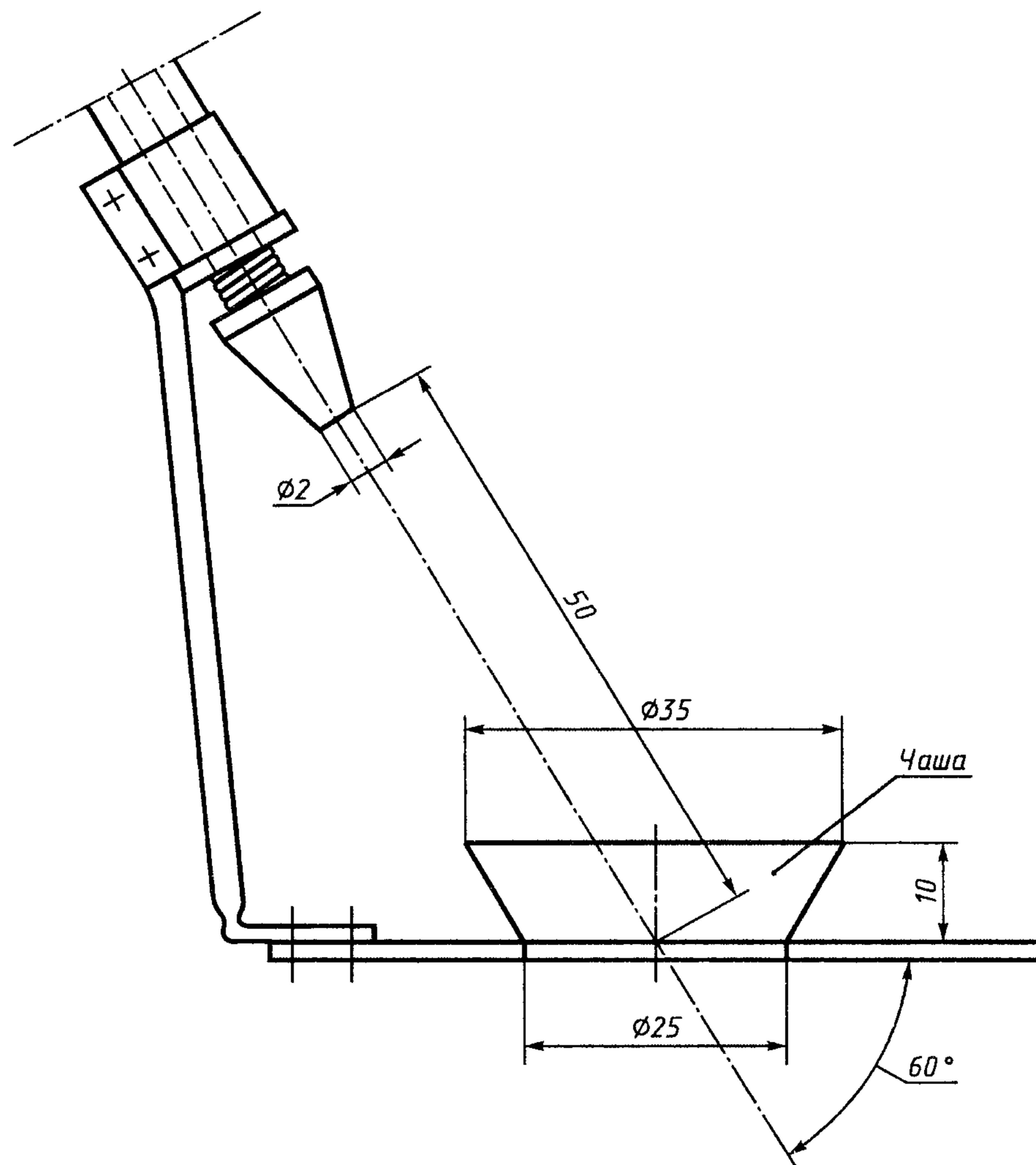
Рисунок 101 — Аппарат для разбрызгивания
