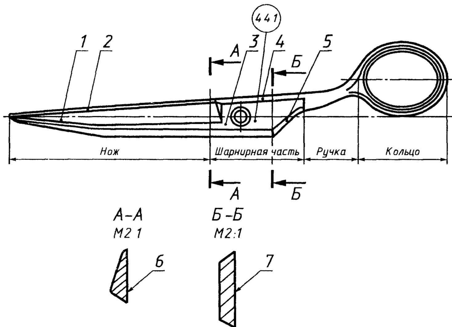
1 — наружная поверхность ножа, 2 — фаска лезвия, 3 — внутренняя поверхность ножа, 4 — наружная поверхность шарнирной части, 5 — боковая грань шарнирной части, 6 — внутренняя поверхность шарнира, 7 — задняя грань шарнирной части
