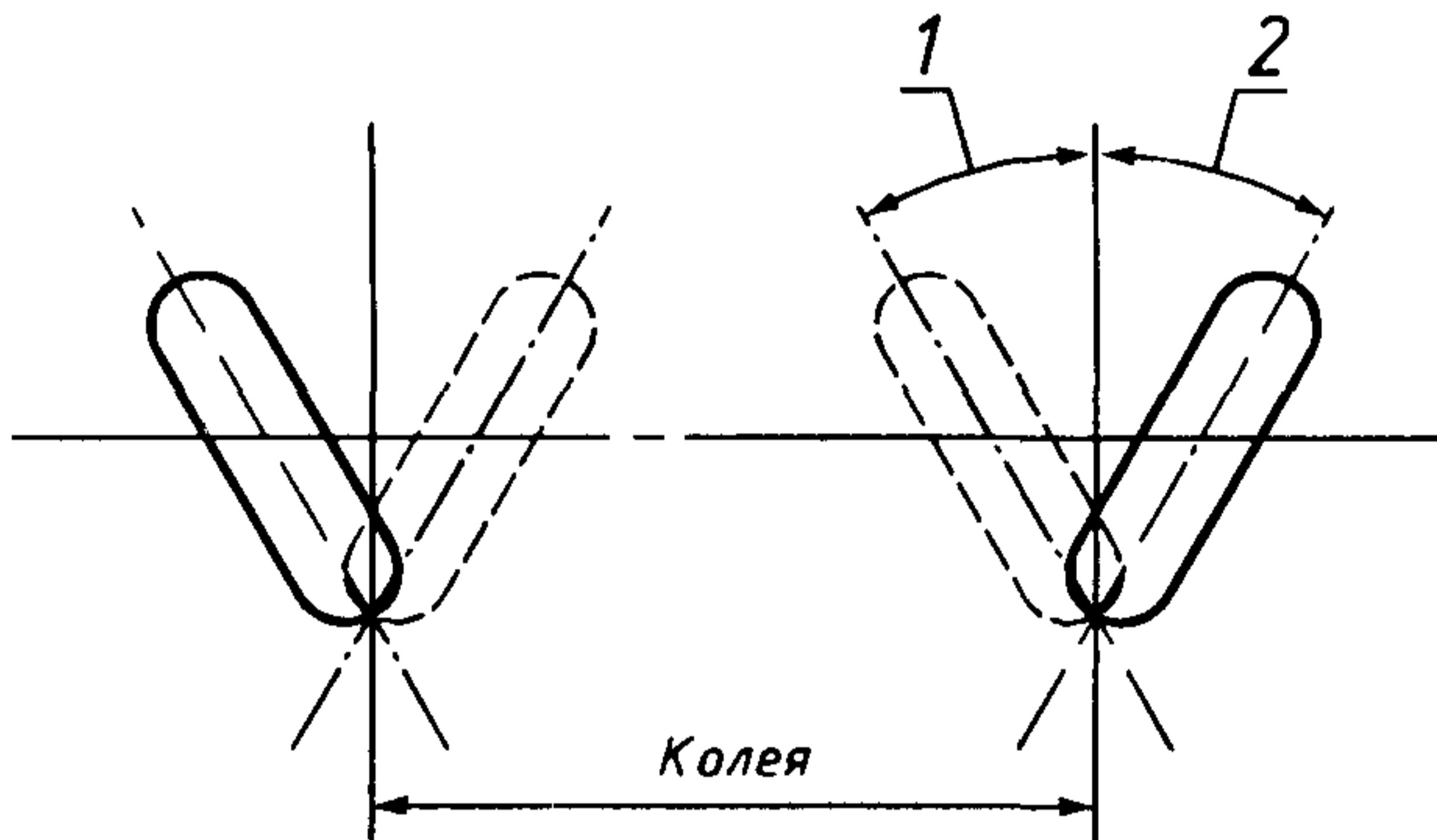
1 — отрицательный угол раз渲а; 2 — положительный угол раз渲а
