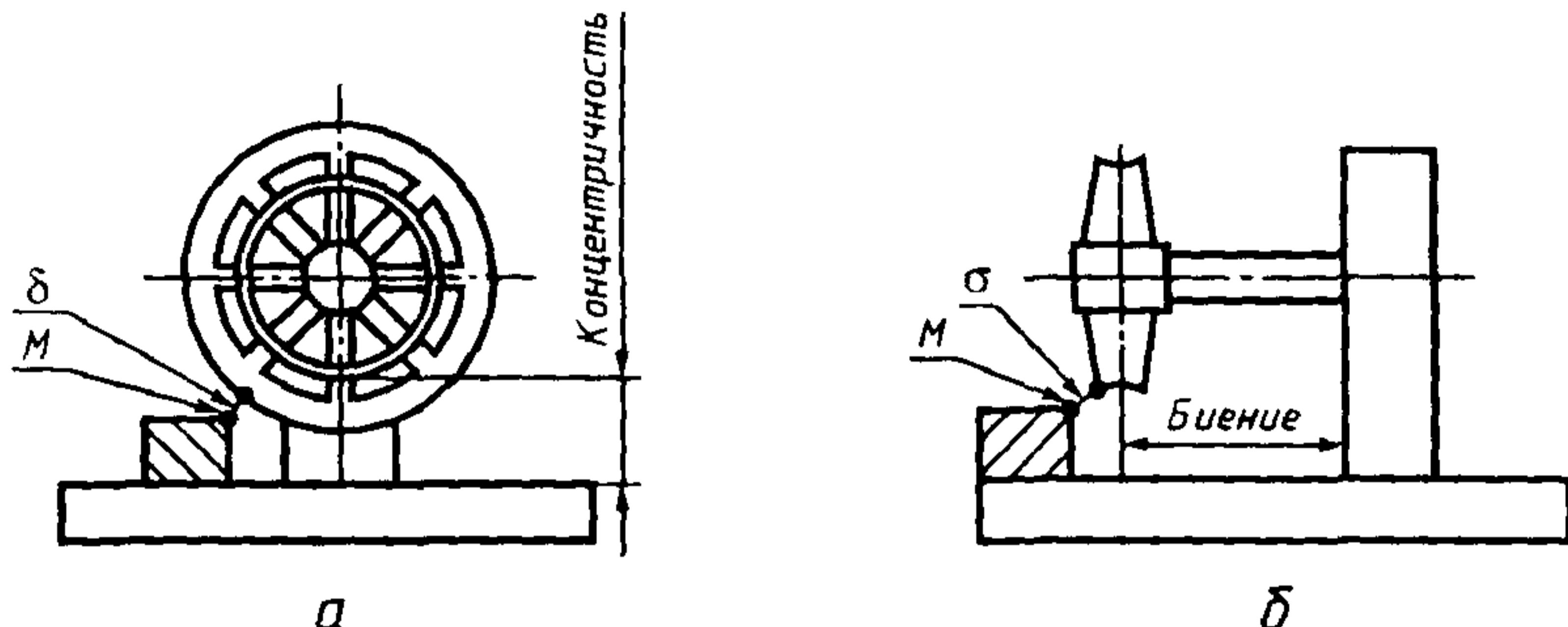
Рисунок Б.3 — Концентричность и биение колеса
