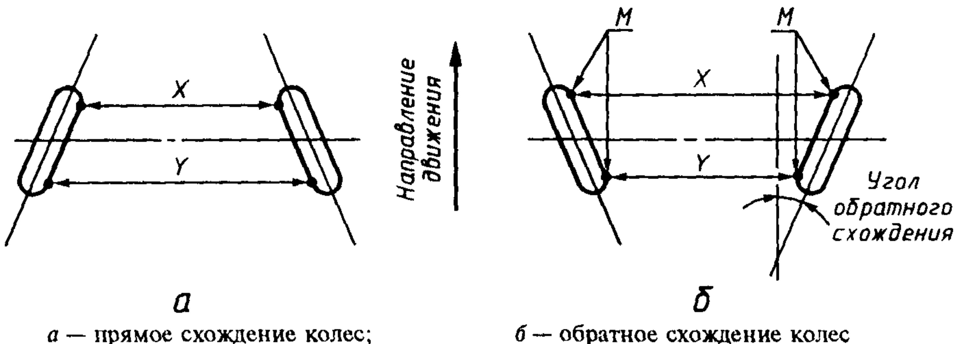
Рисунок Б.2 — Схождение колес
