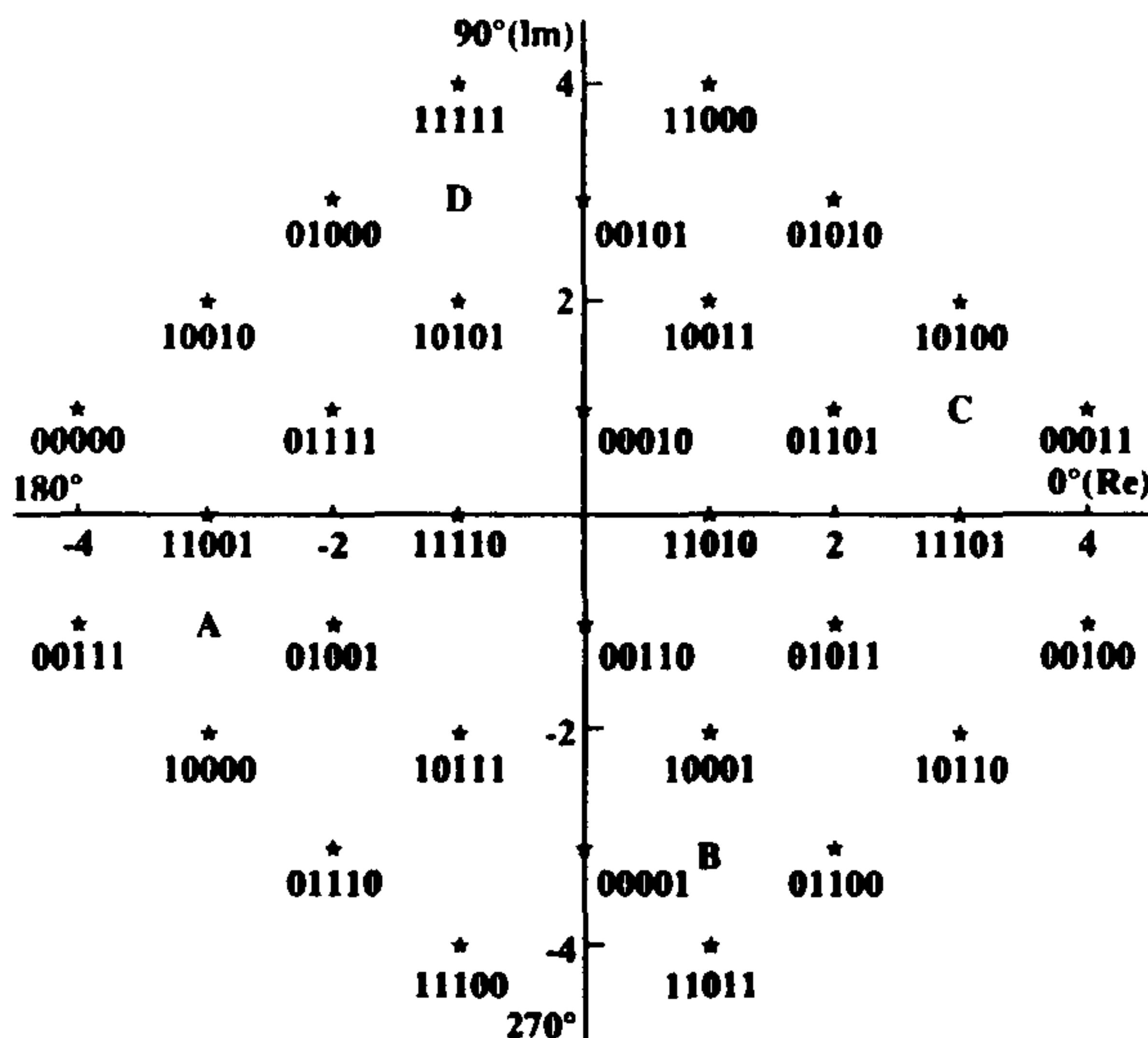
Двоичные числа относятся к Y0n, Y1n, Y2n, Q3n, Q4n. А, В, С, Д используются при работе на скорости 4800 бит/с и при настройке.
