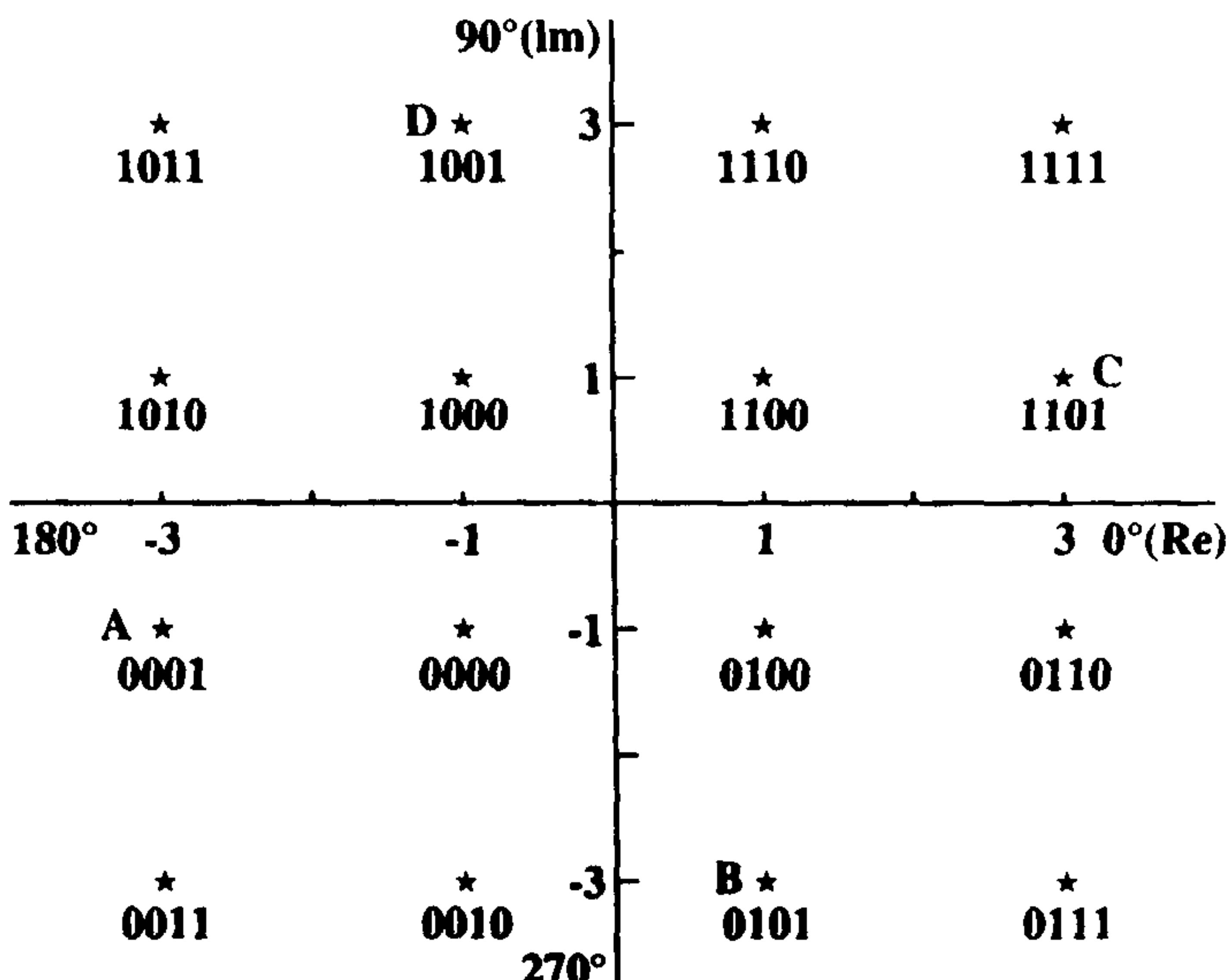
Двоичные числа относятся к Y1n, Y2n, Q3n, Q4n. А, В, С, Д используются при работе на скорости 4800 бит/с и при настройке.
