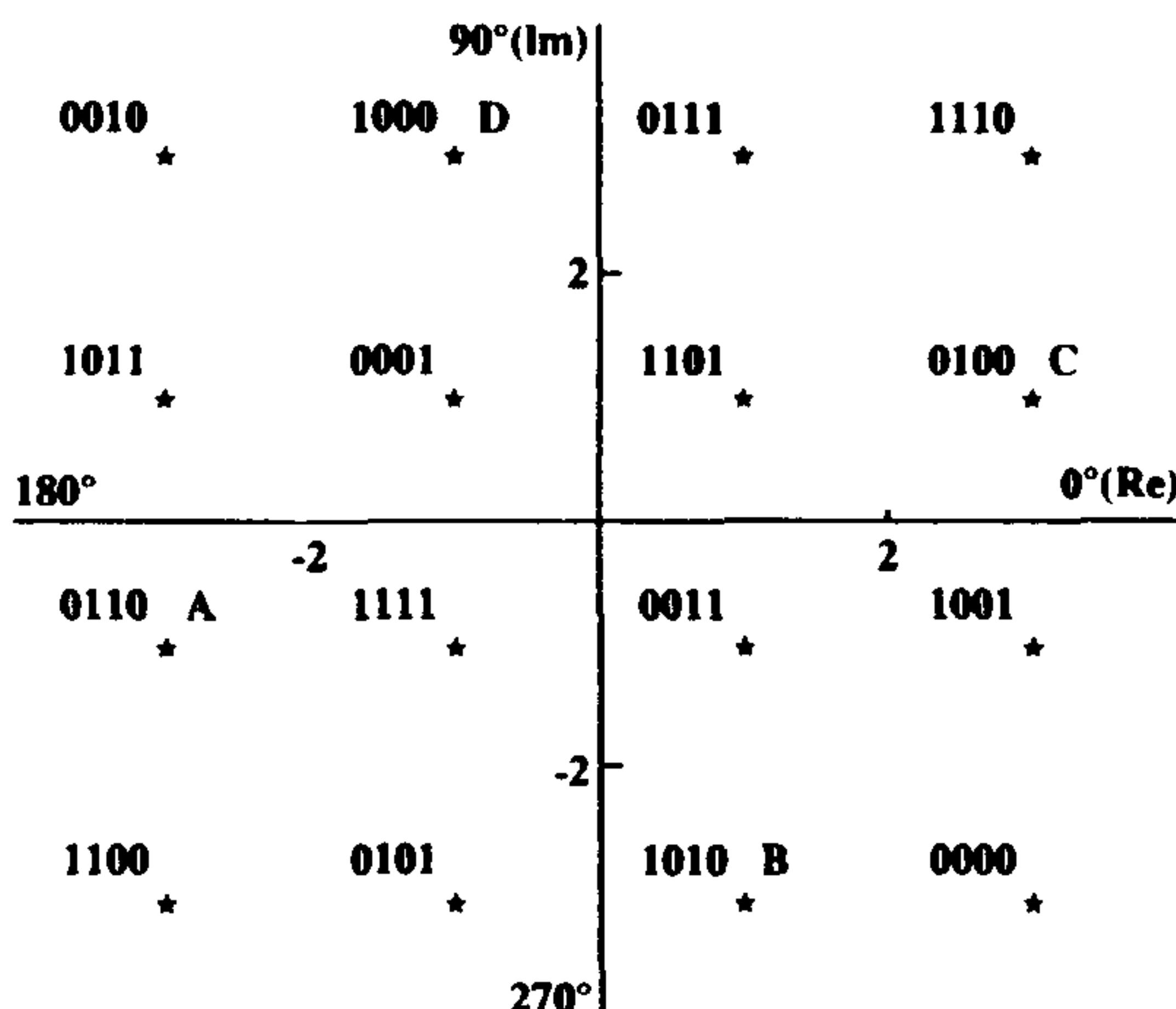
Двоичные числа относятся к Y0n, Y1n, Y2n, Y3n, А, В, С, Д относятся к элементам синхронизирующего сигнала.
