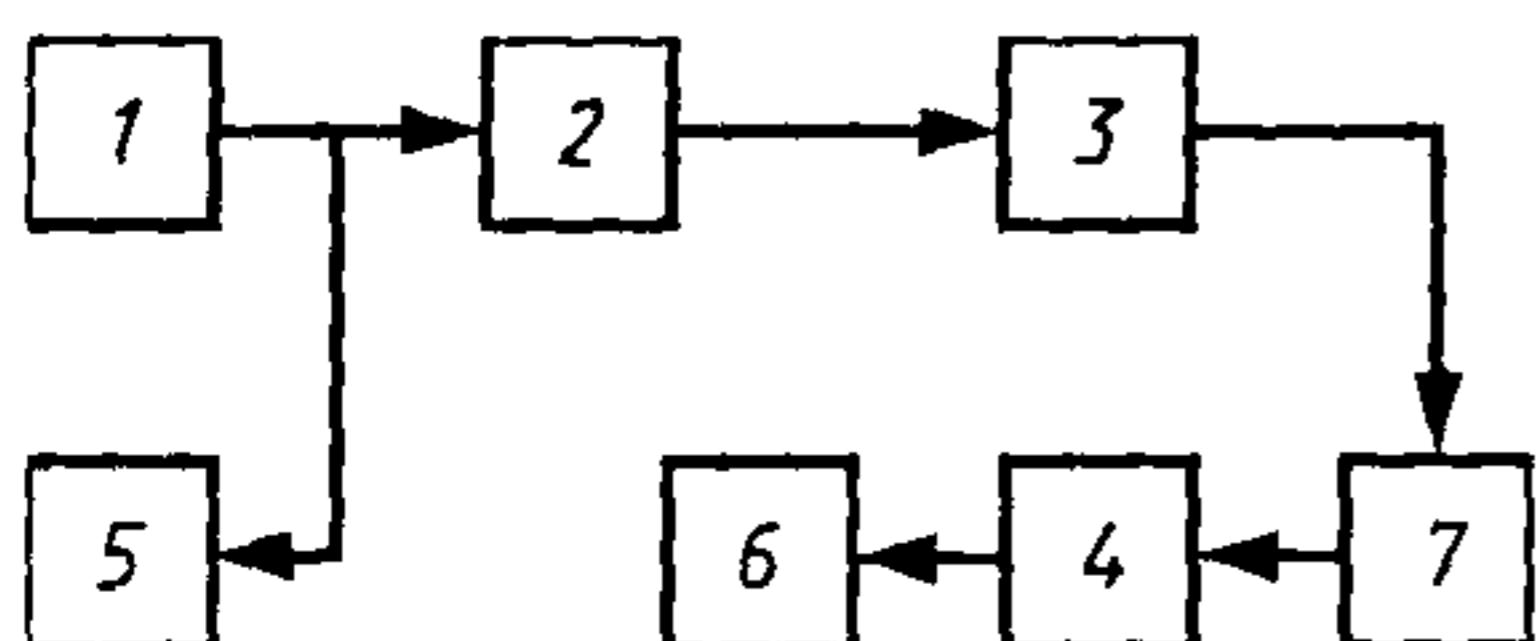
1 — генератор сигналов НЧ по 628, 2 — передатчик, 3 — эквивалент антенны по 623, 4 — девиометр по 629, 5 — вольтметр НЧ по 6210, 6 — измеритель нелинейных искажений по 6212, 7 — фильтр подавления несущей изображения
