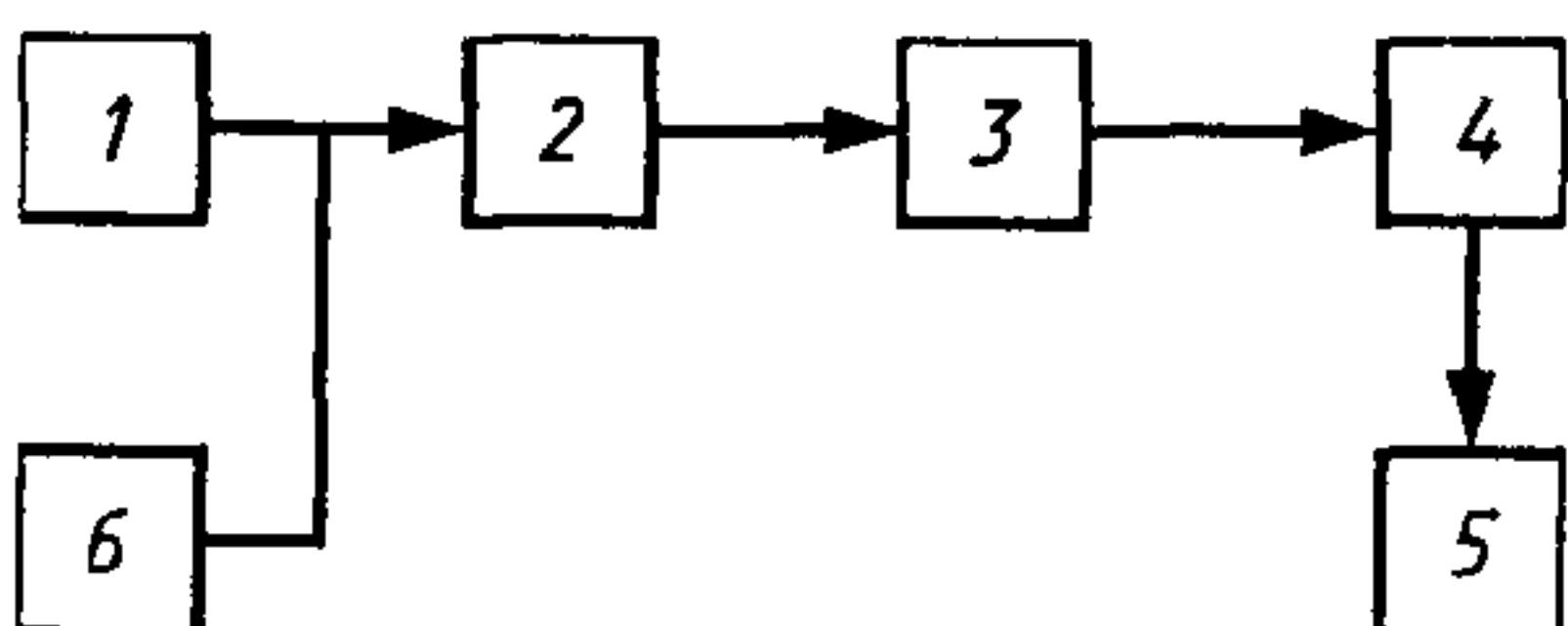
1 — генератор сигналов НЧ по 6.2.8; 2 — передатчик; 3 — эквивалент антенны по 6.2.3; 4 — девиометр по 6.2.9; 5 — измеритель нелинейных искажений по 6.2.12; 6 — вольтметр НЧ по 6.2.10
