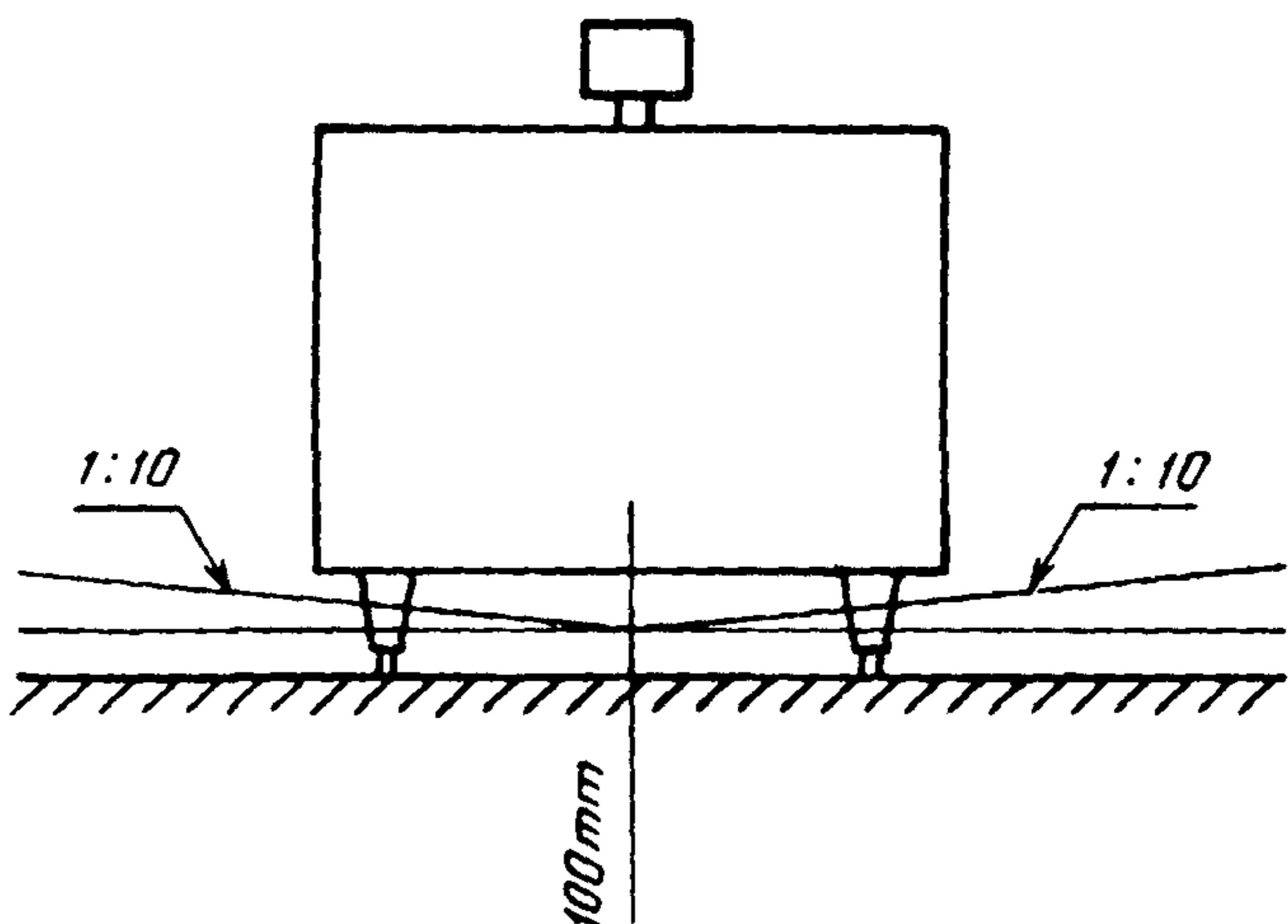
Рисунок 1 — Зазор между резервуаром и полом
