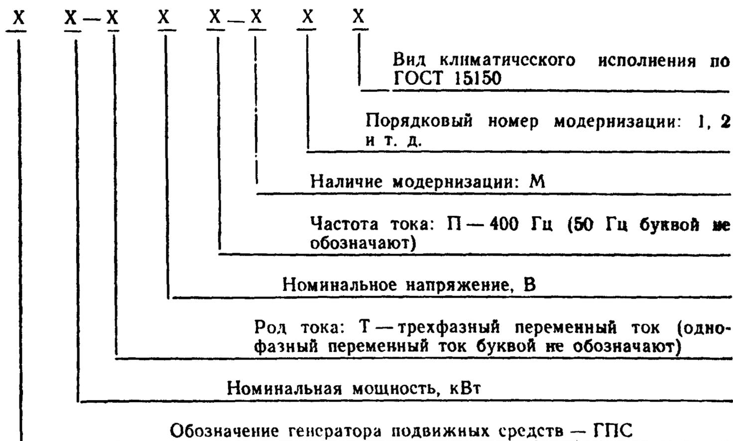
Пример условного обозначения ГПС мощностью 4 кВт, трехфазного тока, напряжением 230 В, частотой 50 Гц, вида климатического исполнения УХЛ1:
