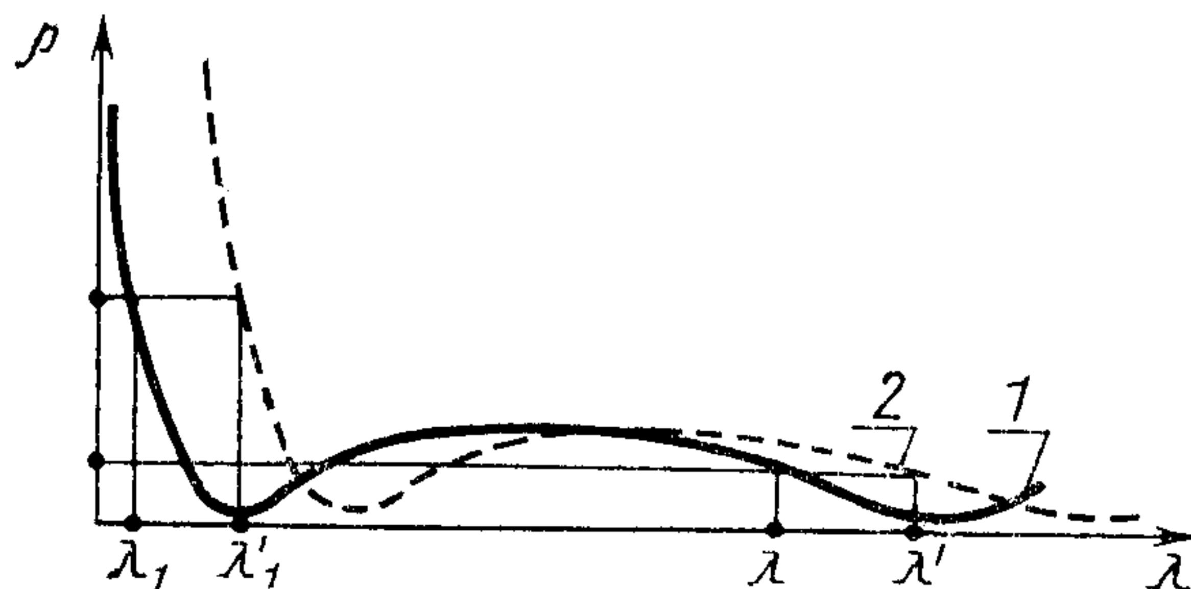
1 — кривая спектрального коэффициента отражения; 2 — перемещенная кривая спектрального коэффициента отражения
