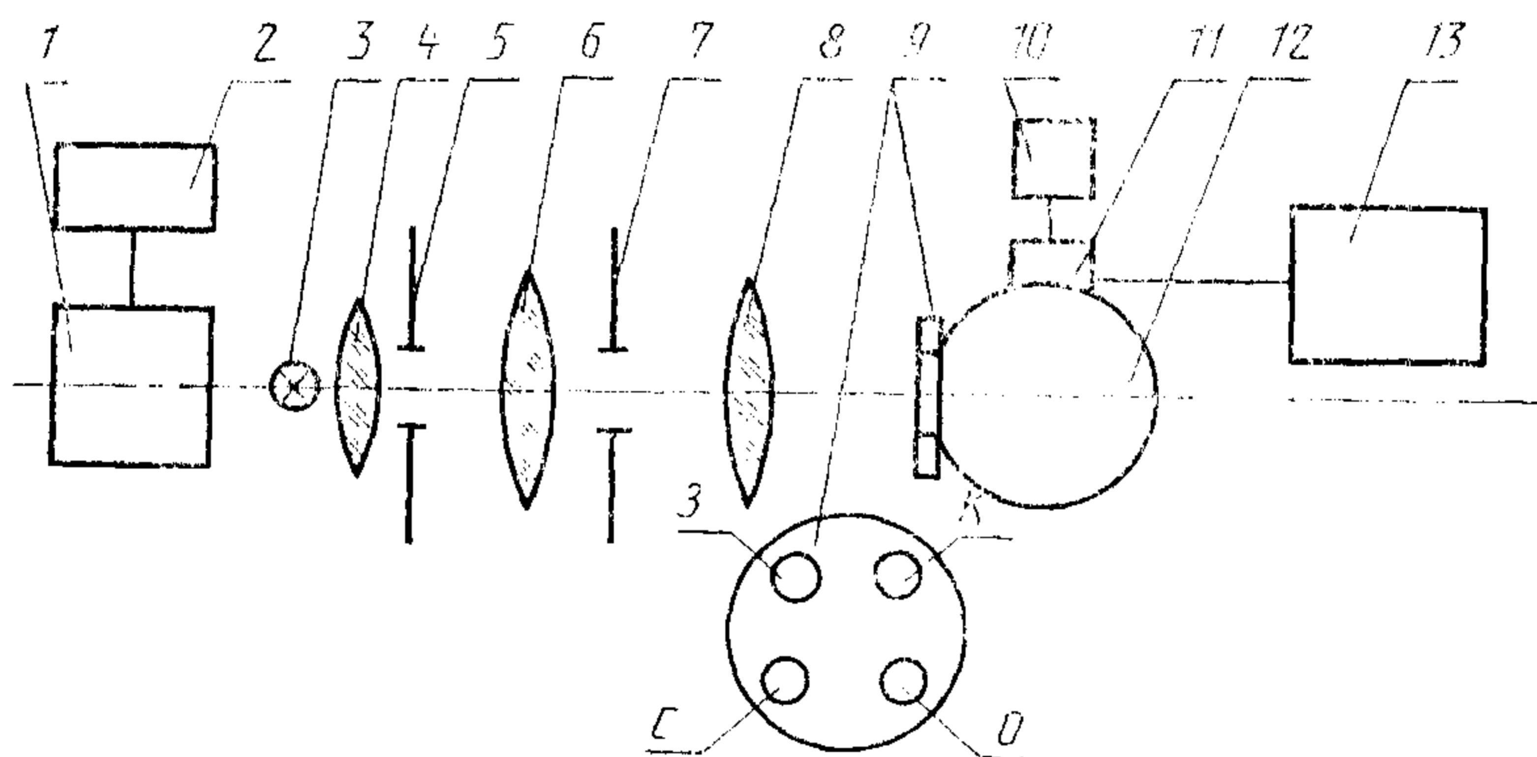
1 — стабилизатор напряжения; 2 — контрольный вольтметр (амперметр);
