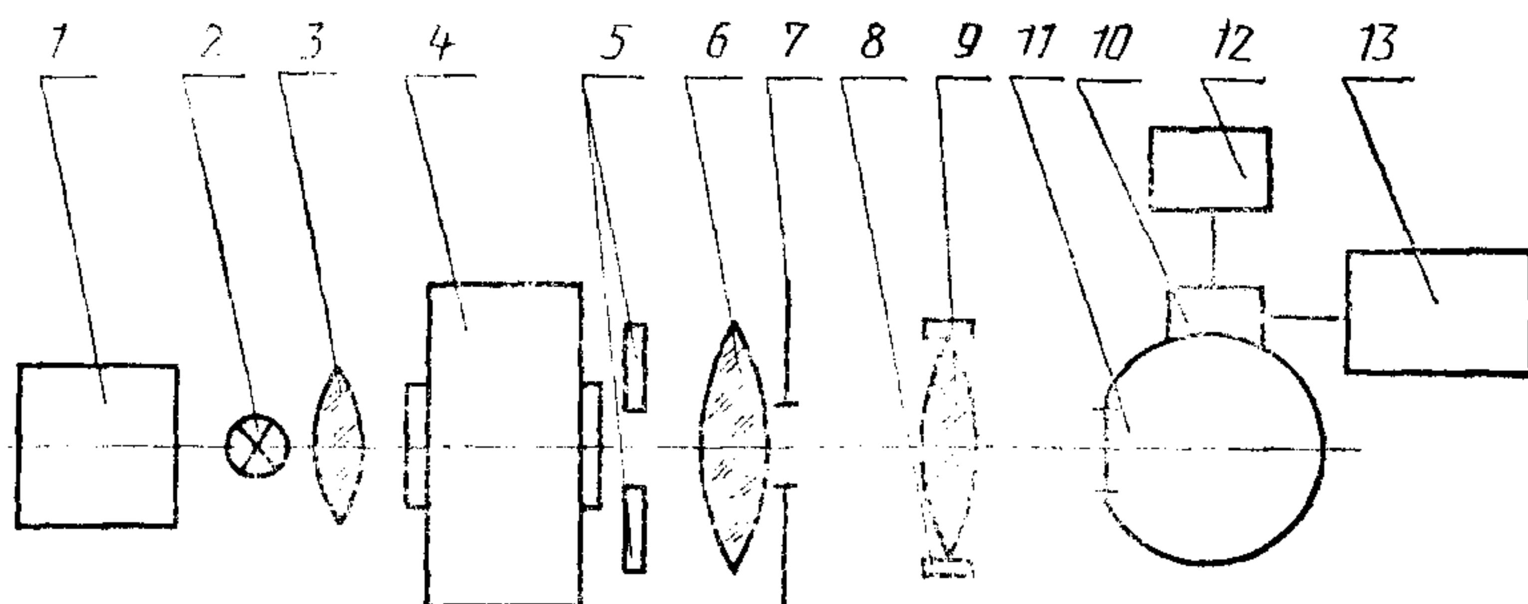
1 — стабилизатор напряжения; 2 — лампа накаливания; 3 — конденсор; 4 — монохроматор (или интерференционный светофильтр); 5 — светофильтры для устранения влияния вредного рассеянного света; 6 — коллиматор; 7 — диафрагма; 8 — объективодержатель; 9 — испытуемый объектив; 10 — фотоприемник; 11 — фотометрический шар; 12 — измерительный прибор; 13 — высоковольтный стабилизатор напряжения
