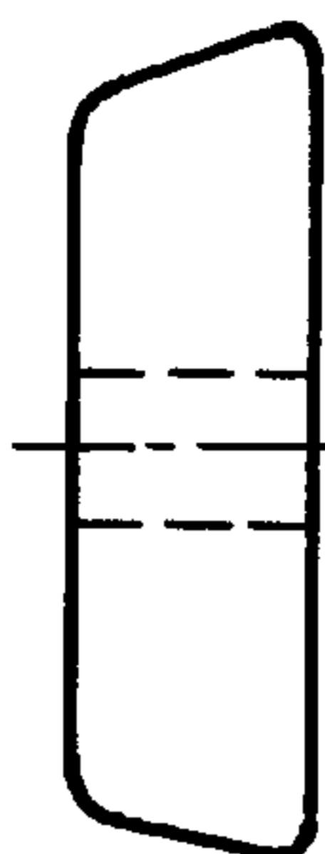
44 нетермоупрочненная накладка: Рельсовая накладка в горячекатаном состоянии.
