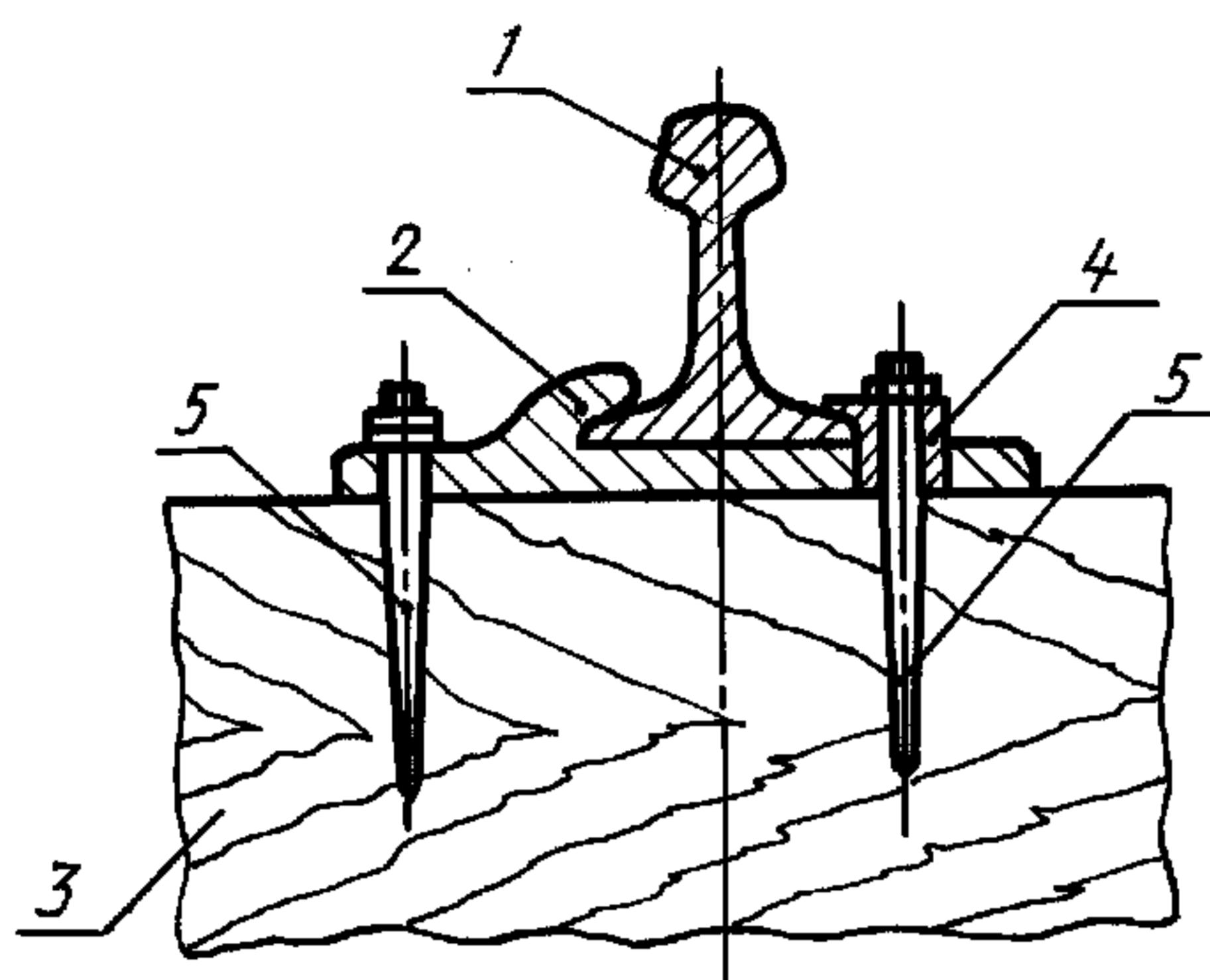
1 — рельс; 2 — подкладка полураздельного скрепления; 3 — шпала деревянная;
