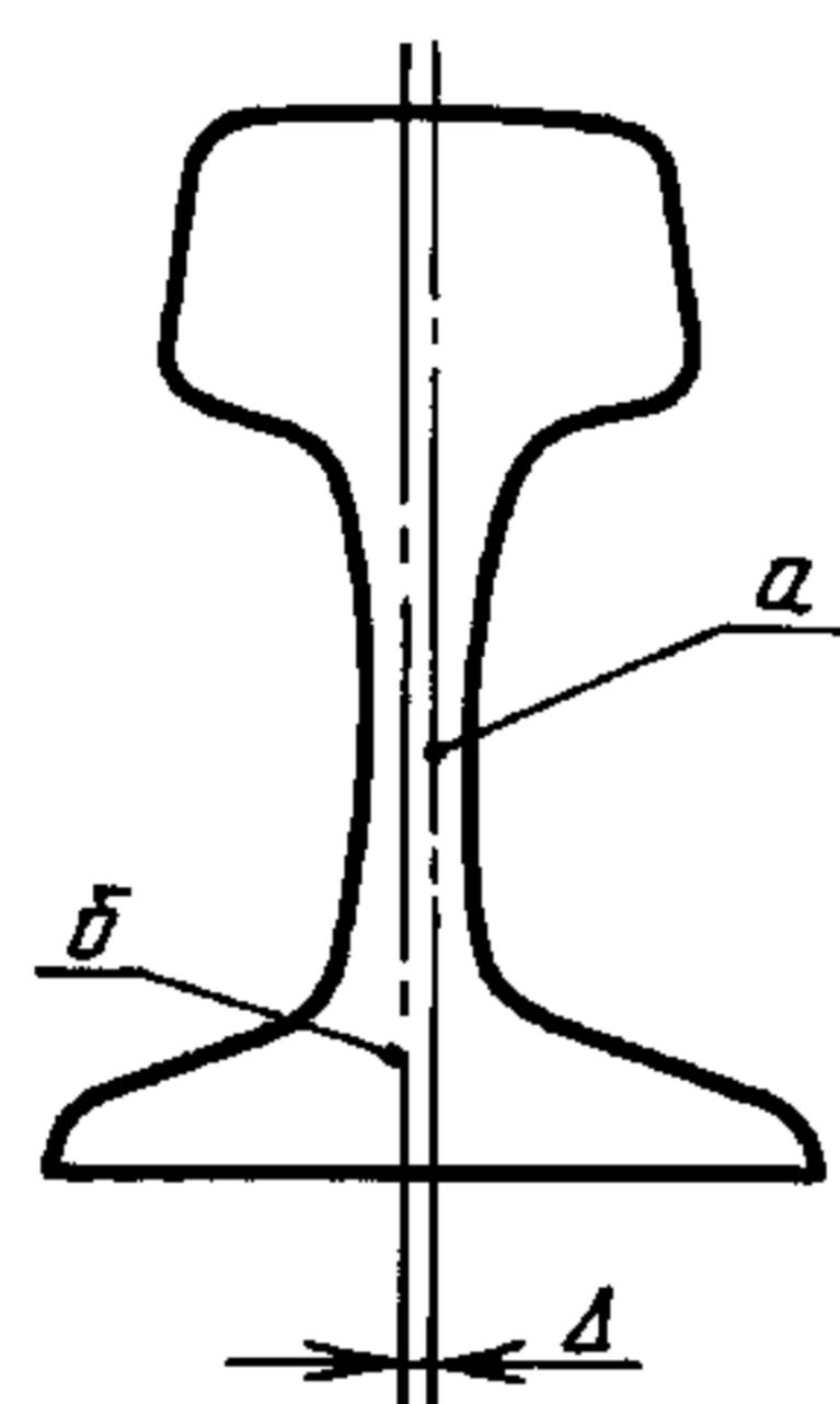
$\Delta$  — отклонение вертикальной оси шейки относительно вертикальной оси подошвы, принятой за базу, мм; *a* — вертикальная ось шейки; *b* — вертикальная ось подошвы
