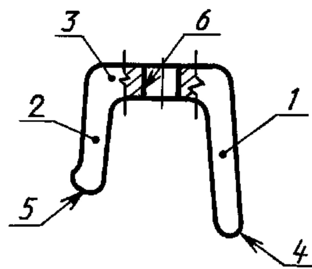
1 — длинная ножка клеммы; 2 — короткая ножка клеммы; 3 — полка клеммы; 4 — торец длинной ножки клеммы; 5 — торец короткой ножки клеммы; 6 — клеммно-болтовое отверстие
