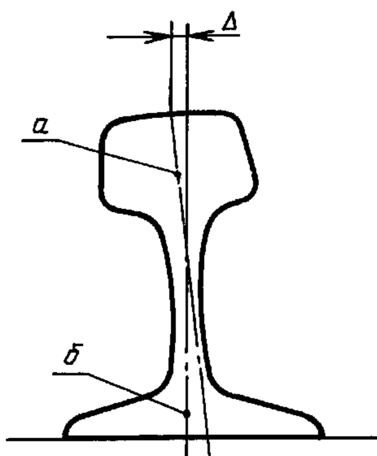
$\Delta$  — отклонение вертикальной оси головки относительно вертикальной оси подошвы, принятой за базу, мм; *a* — вертикальная ось головки; *b* — вертикальная ось подошвы
