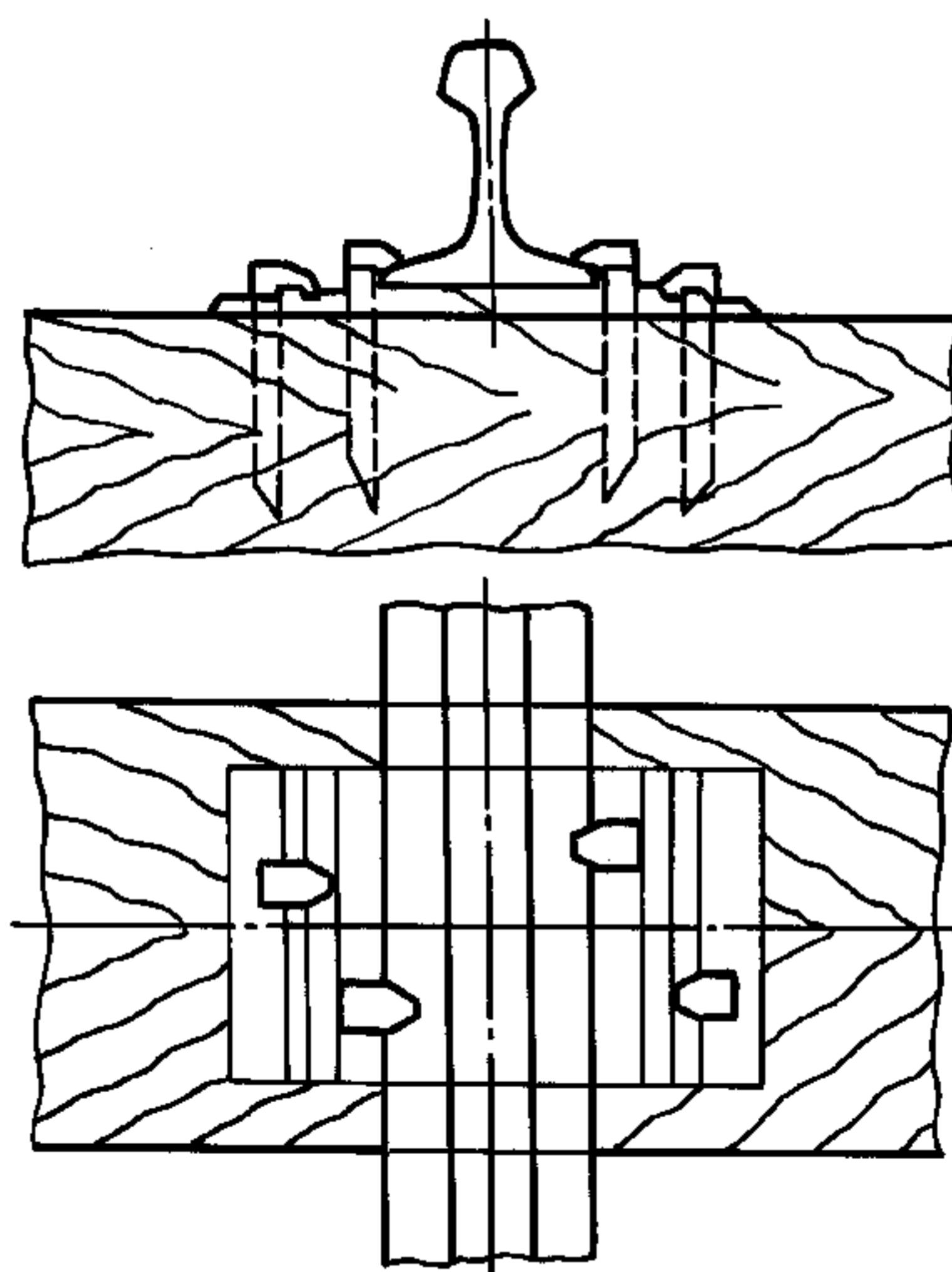
**П р и м е ч а н и е —** Смешанное рельсовое скрепление — это промежуточное рельсовое скрепление, с помощью которого рельс через подкладки соединяется непосредственно с опорами, кроме того, подкладки дополнительно крепятся к опорам.
