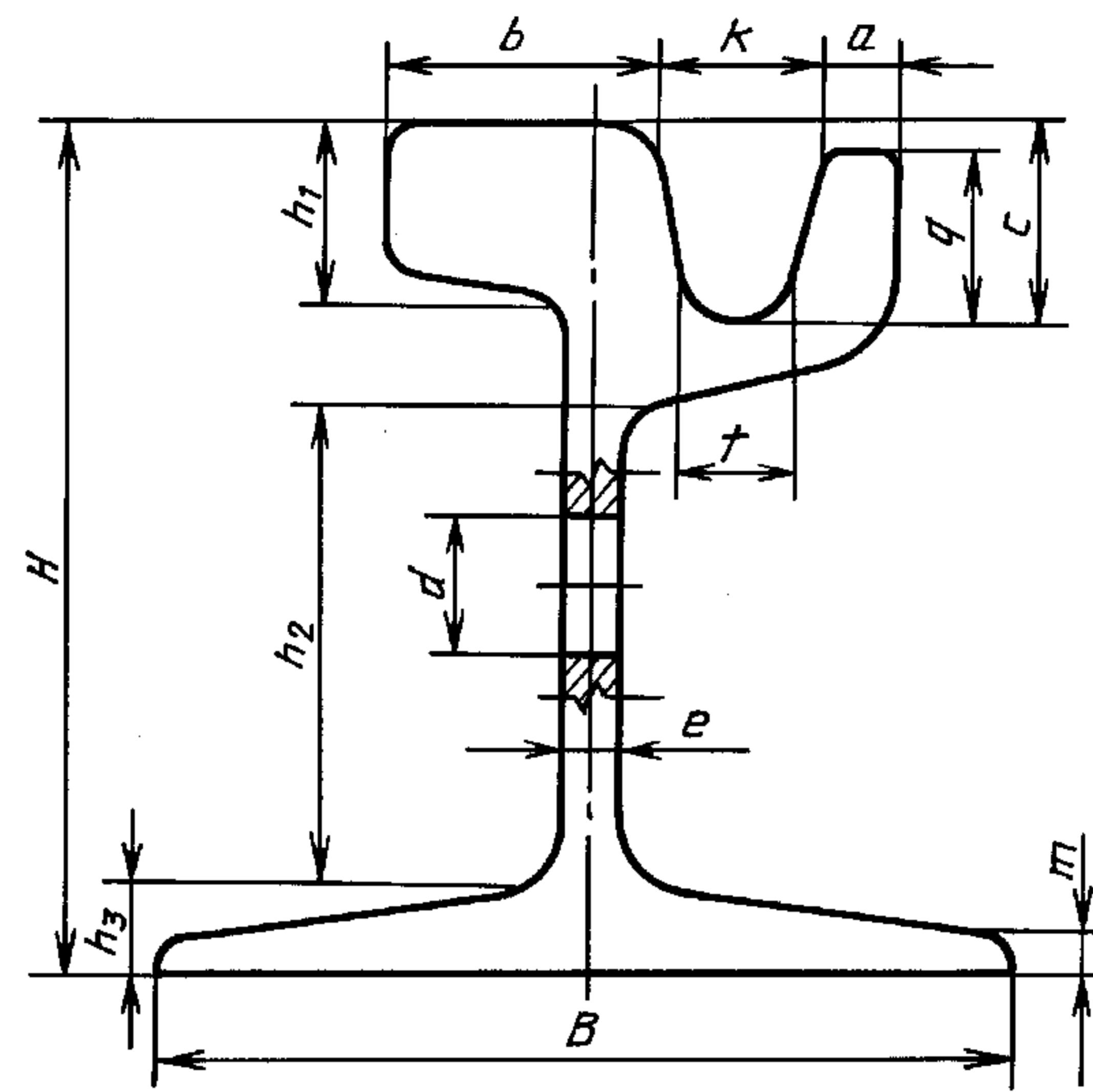
Рисунок 5 — Основные размеры желобчатого рельса
