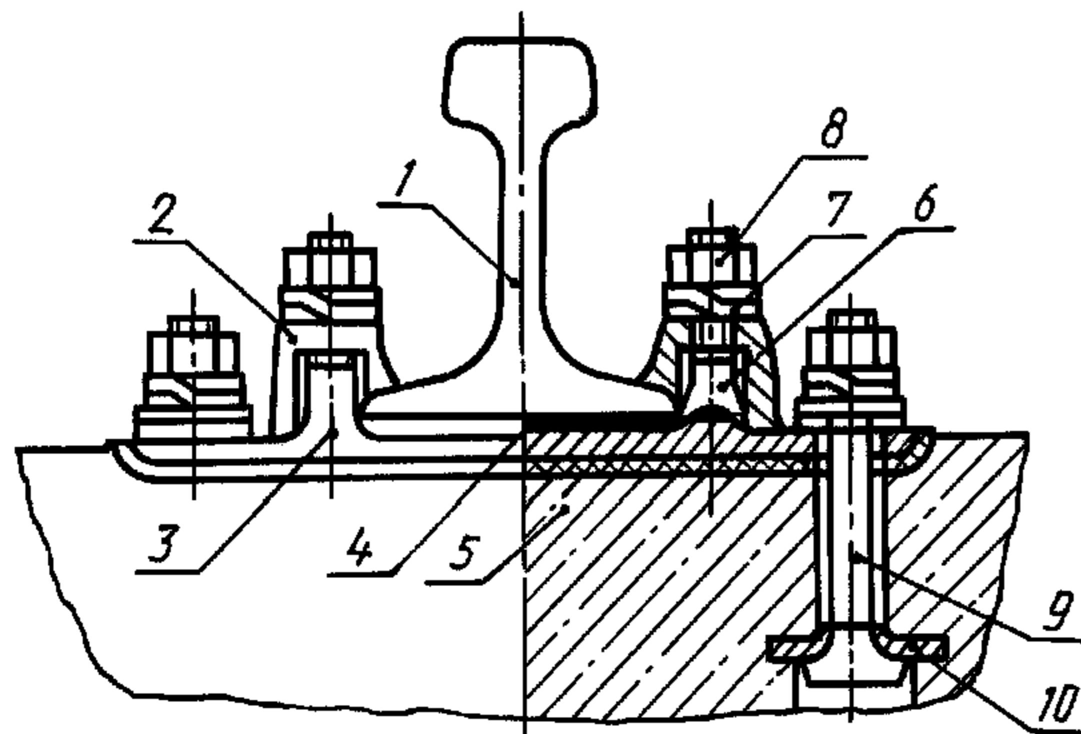
1 — рельс; 2 — клемма; 3 — подкладка раздельного скрепления; 4 — подрельсовая прокладка; 5 — прокладка под подкладку; 6 — клеммный болт; 7 — двухвитковая шайба; 8 — гайка; 9 — закладной болт;
