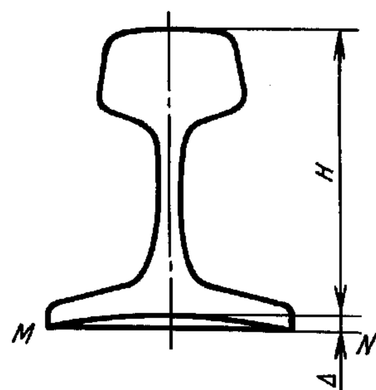
$\Delta$  — предельное отклонение вогнутости подошвы, мм;  $MN$  — линия прилегающей плоскости
