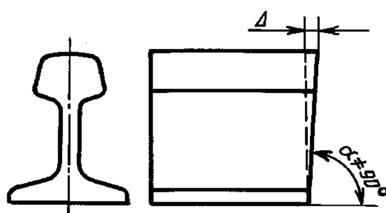
$\Delta$  — косина торца рельса, мм
