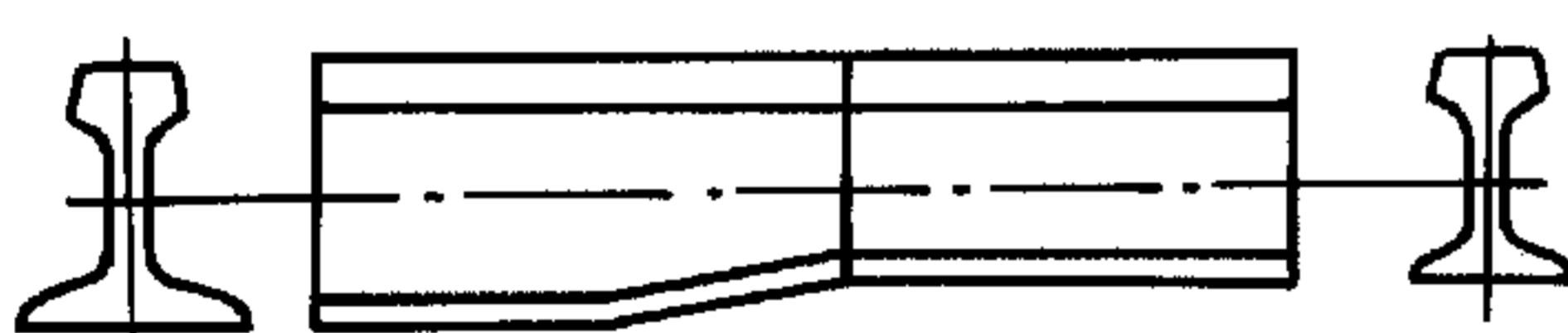
**22 переходной рельс:** Специальный рельс стандартной длины, сваренный из двух рельсов разных типов
