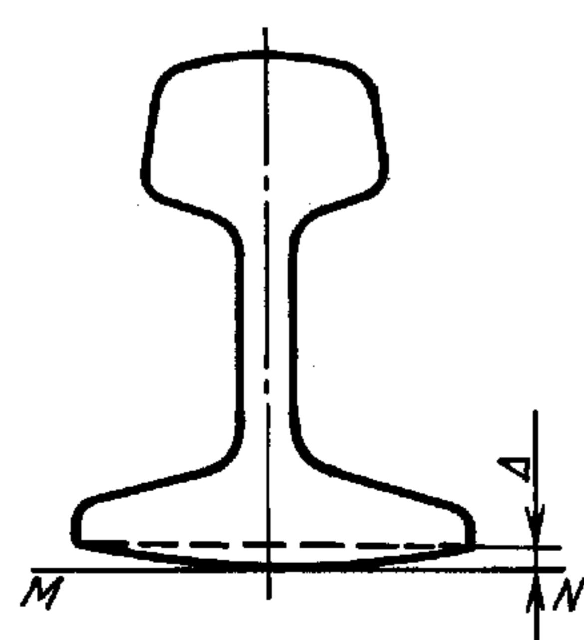
$\Delta$  — отклонение выпуклости подошвы, мм; *MN* — касательная горизонтальная плоскость
