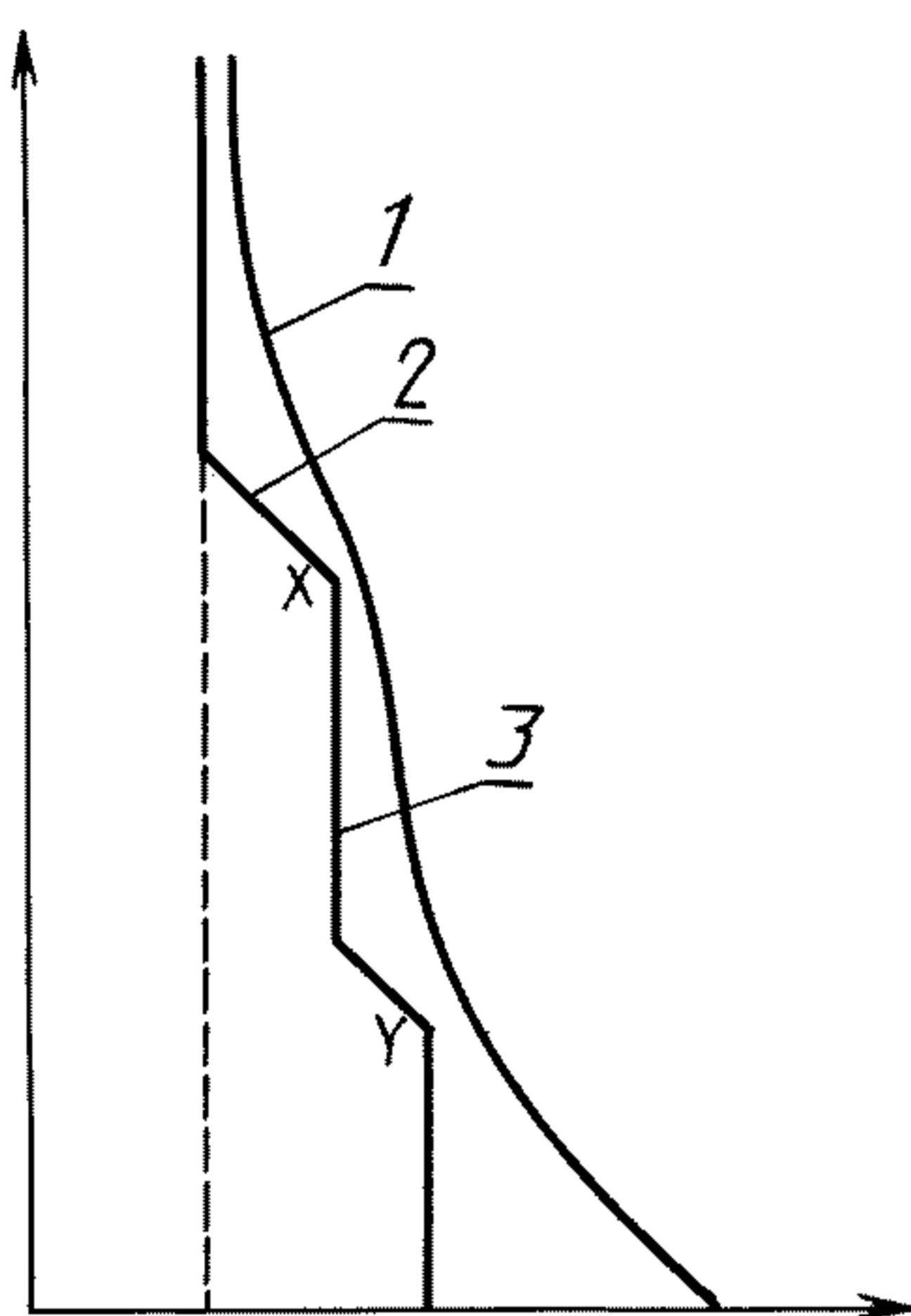
1 — предугловая характеристика; 2 — прямая постоянного значения  $I^2t$ ; 3 — условная кривая перегрузок
