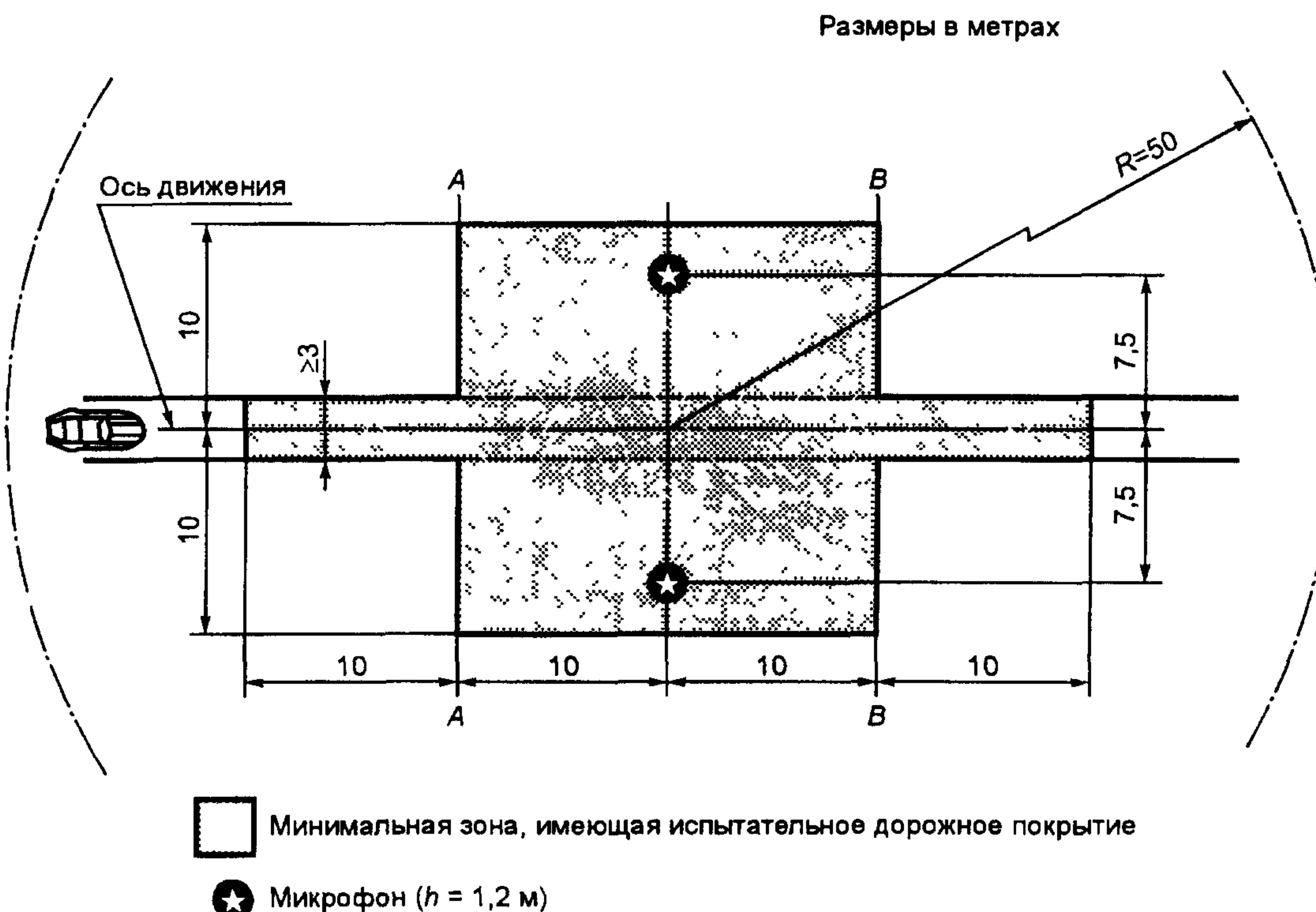
Рисунок 1 — Минимальные требования в отношении зоны с испытательным покрытием
