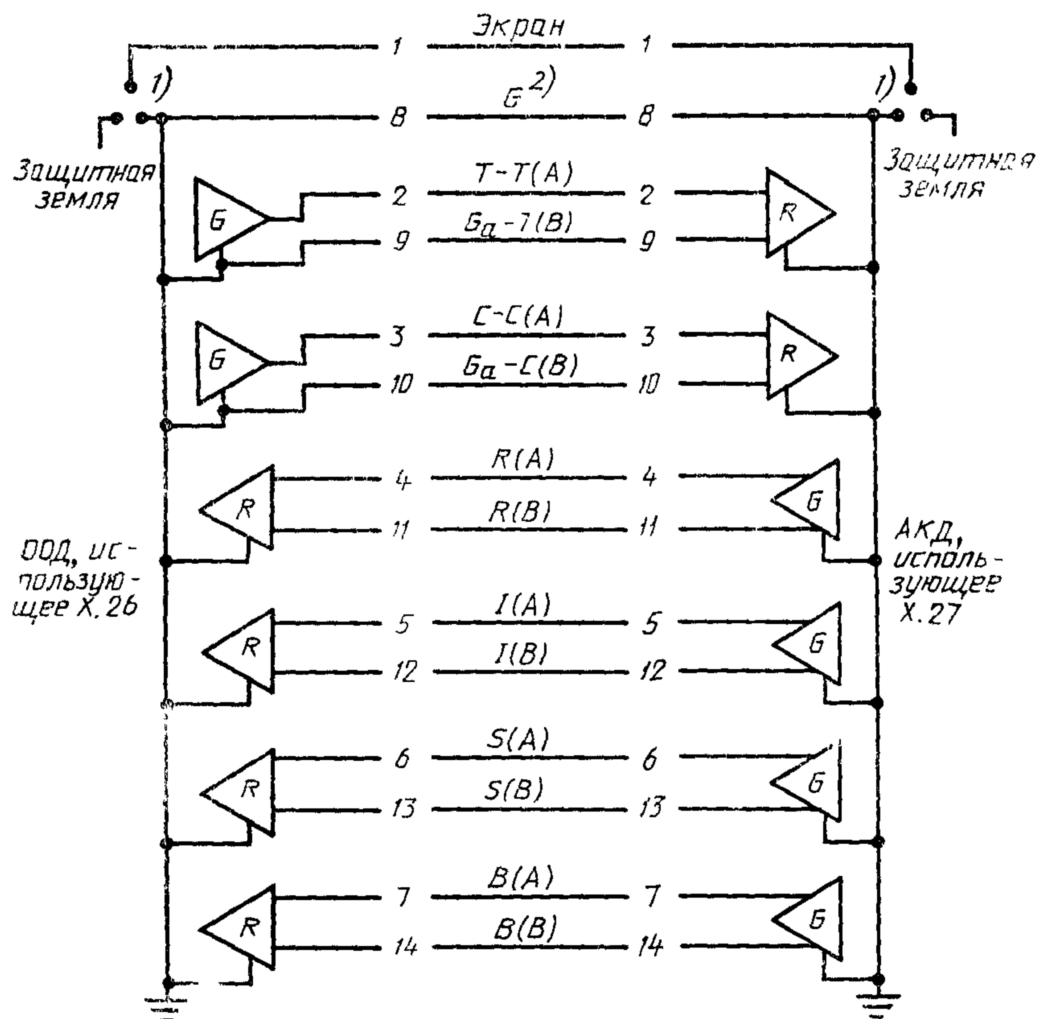
1) Контакт 1 предназначен для соединения экранов между спаренными частями экранированного интерфейсного кабеля. Экран может быть подсоединен либо к защитной земле, либо к сигнальной земле на стороне ООД или АКД, или на обеих сторонах в соответствии с национальными правилами.
