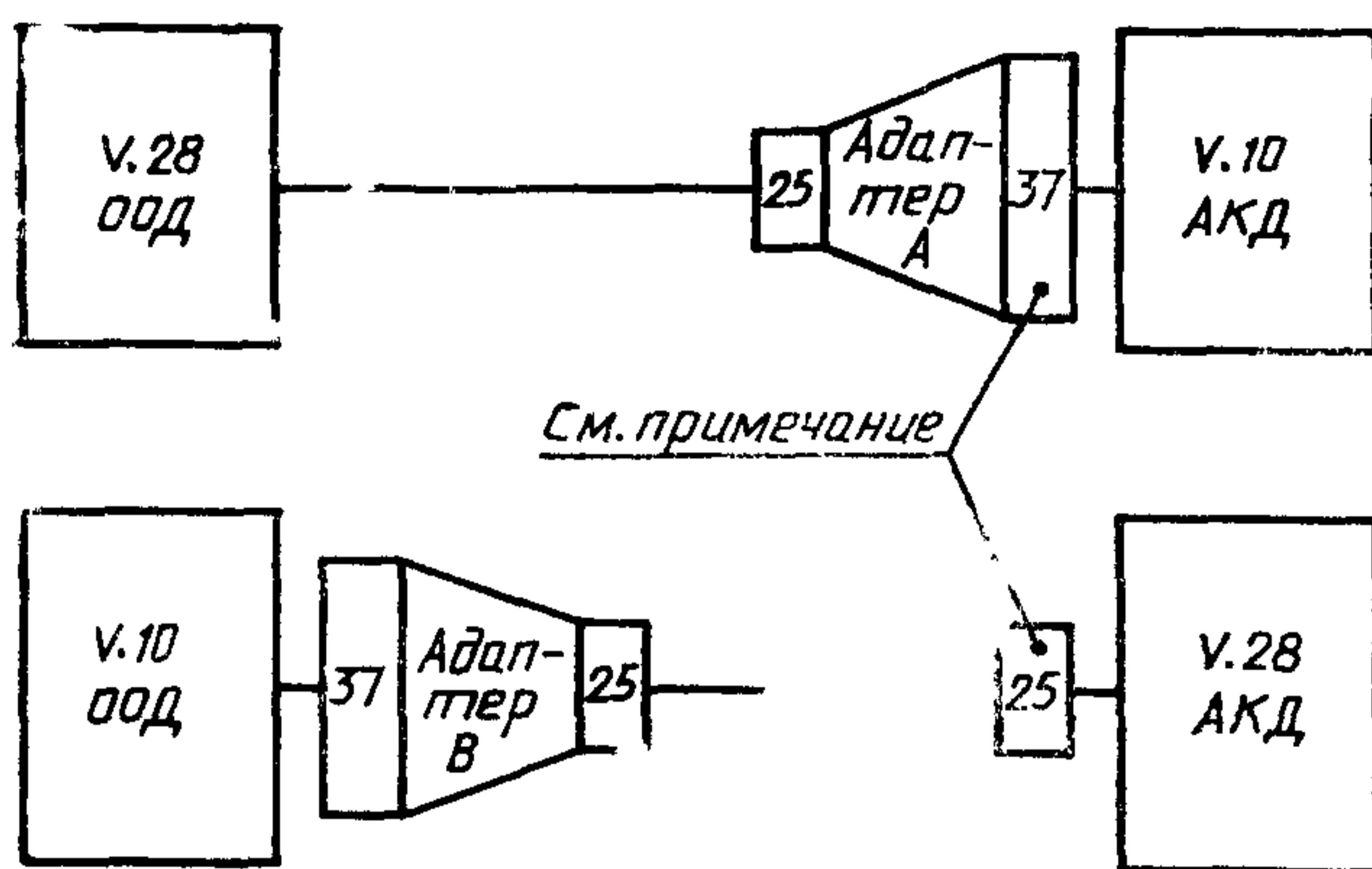
**Примечание** — Рекомендация V.24 МККТТ определяет, что соединитель обязательно должен быть физически подключен к АКД
