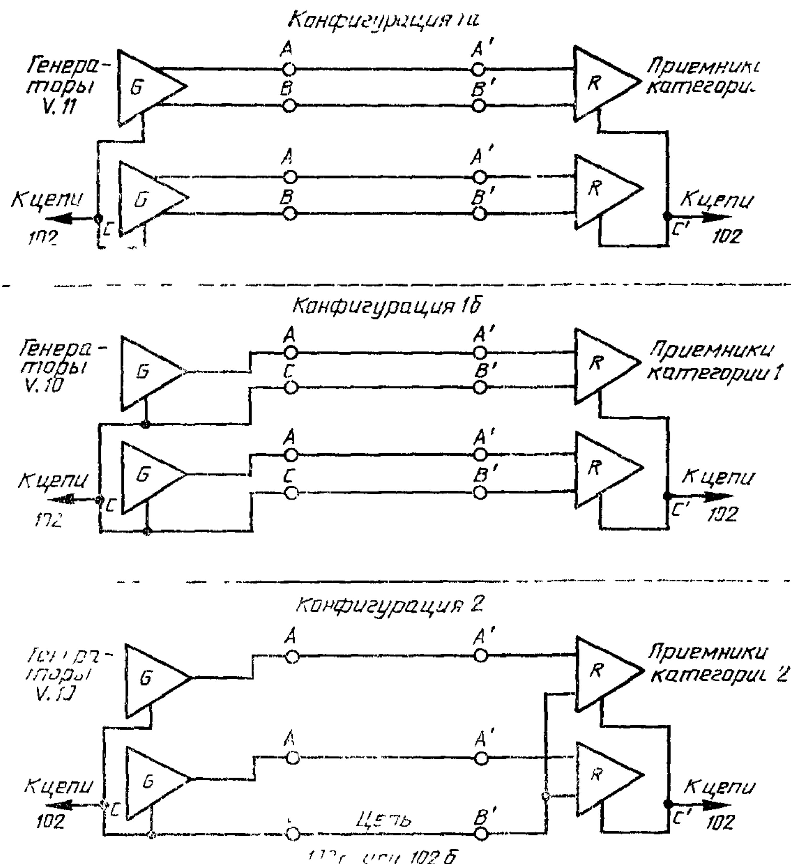
Рисунок Е.1 — Конфигурации взаимосоединений генератор/ приемник
