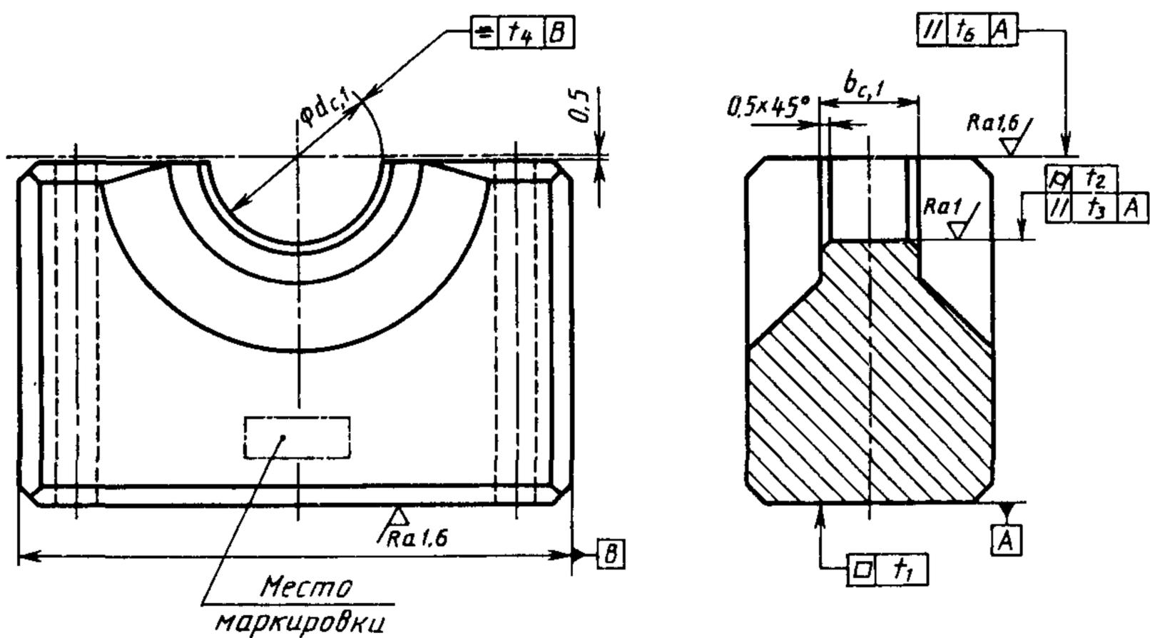
Рисунок 4 — Нижний полувкладыш контрольного блока
