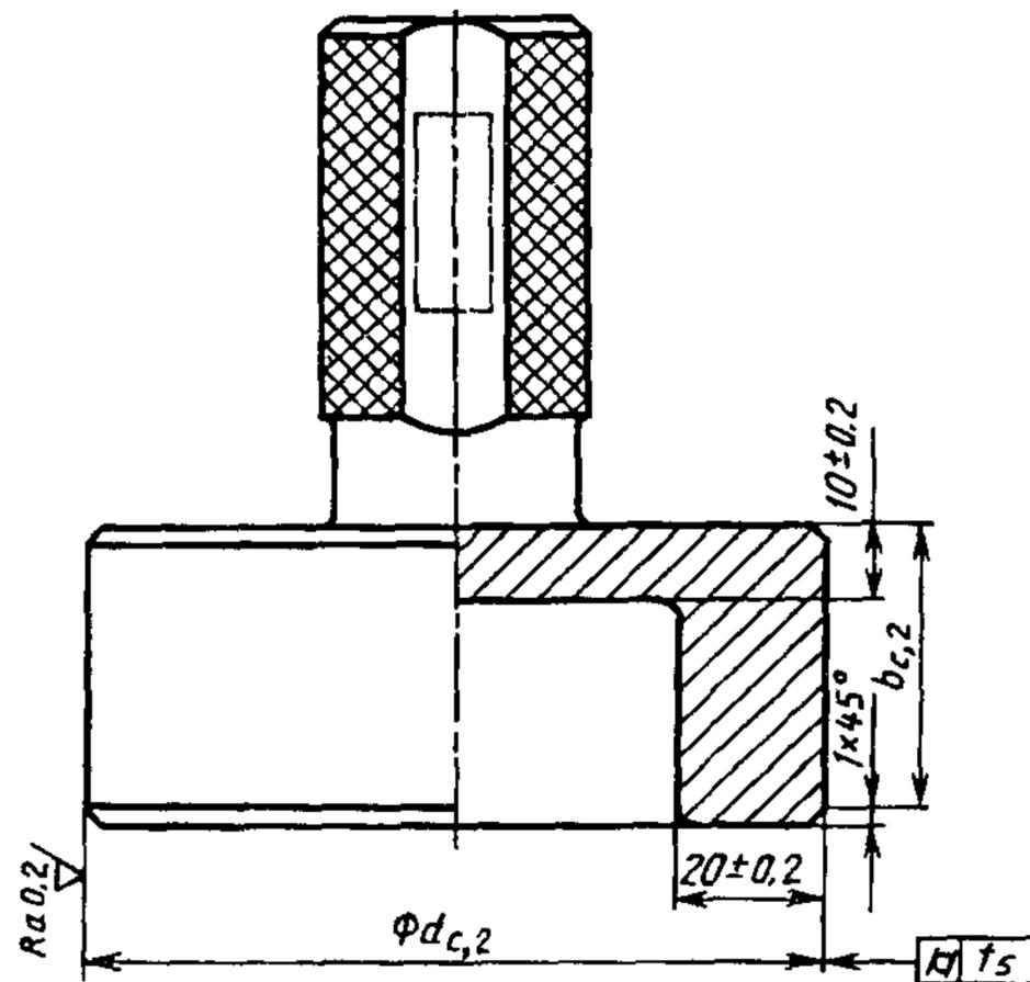
Рисунок 6 — Калибр-пробка с глухим отверстием для  $d_{c,2} > 80$  мм
