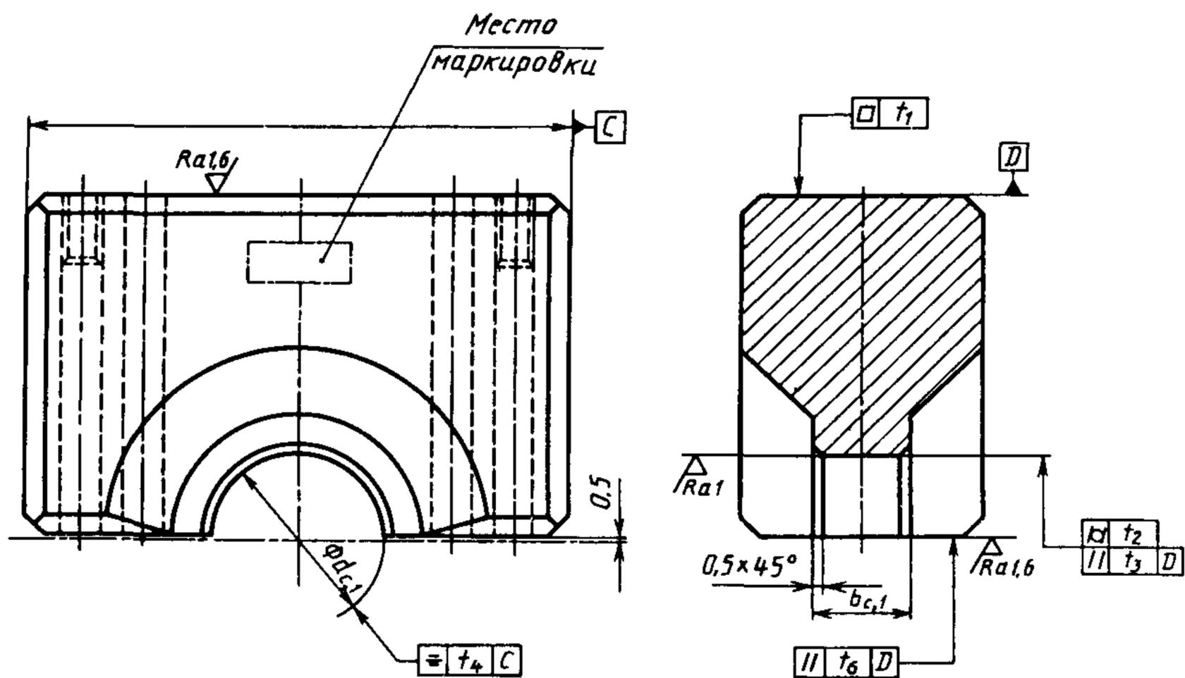
Рисунок 3 — Верхний полувкладыш контрольного блока
