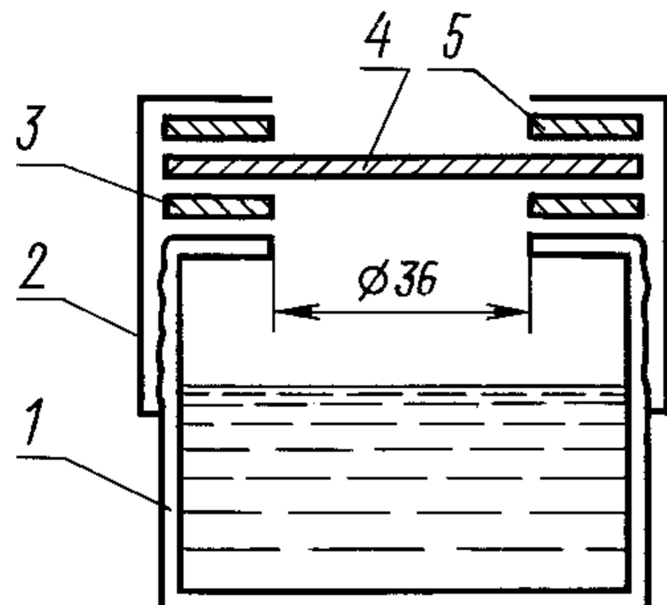
Стаканы (не более восьми) с образцами и контрольный стакан без образца помещают на подставку в эксикатор, заполненный 1 дм<sup>3</sup> серной кислоты, и выдерживают в термостате при температуре (20±3) °С 18 ч, после чего взвешивают каждый стакан. После взвешивания стаканы помещают в тот же эксикатор и выдерживают в тех же условиях 6 ч. Затем взвешивают каждый стакан.
