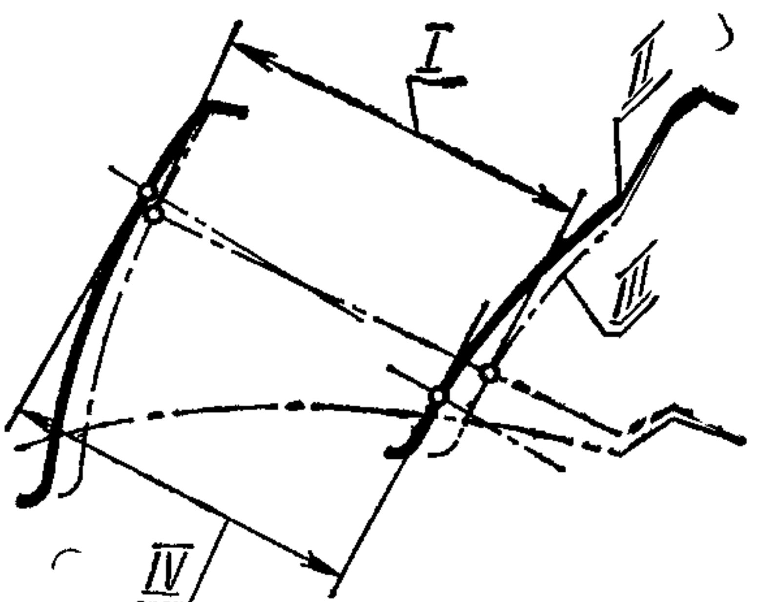
I—номинальный шаг зацепления; II—действительный профиль зуба; III—номинальный профиль зуба; IV—действительный шаг зацепления на примере конического прямозубого колеса
