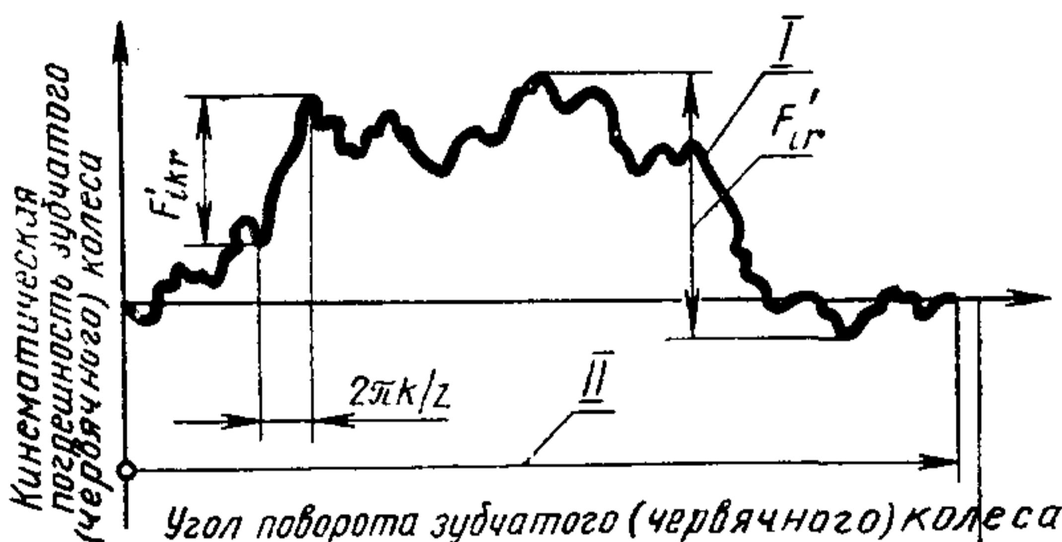
I—кривая кинематическая погрешность зубчатого колеса,
