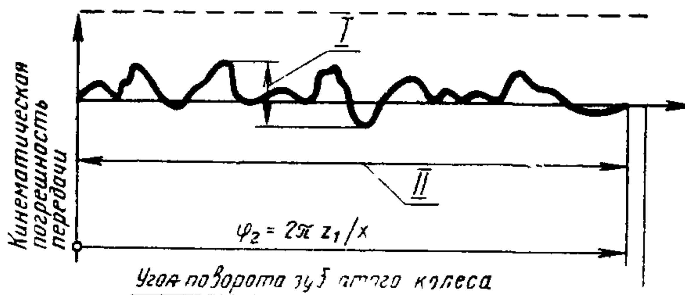
$\varphi_2$ —угол поворота большего колеса,  $x$ —общий наибольший делитель чисел зубьев  $z_1$  и  $z_2$ , соответственно шестерни и колеса,
