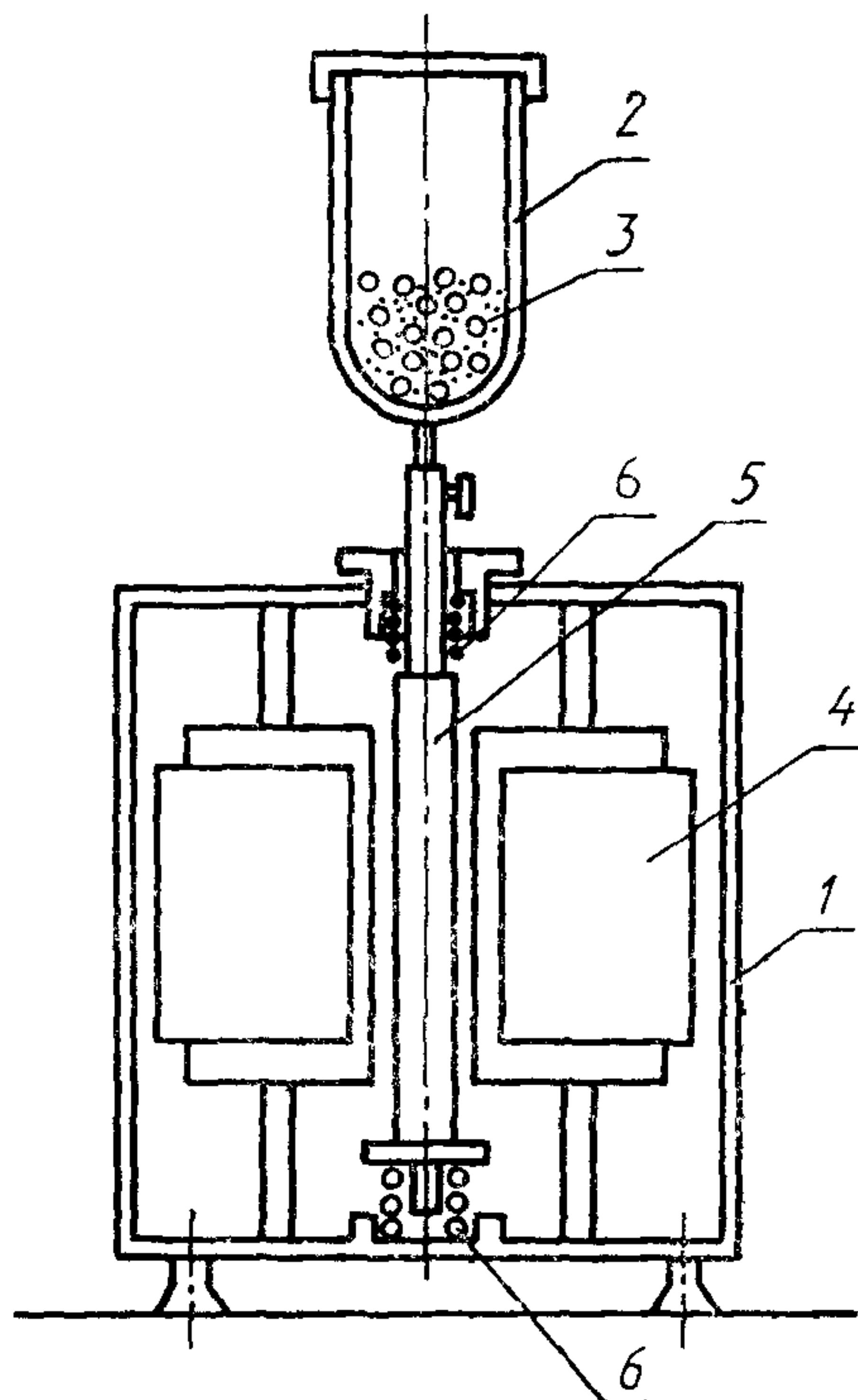
1 — вибрационный узел; 2 — разборная гильза, 3 — измельчающие тела, 4 — электромагнит, 5 — стержень, 6 — пружины
