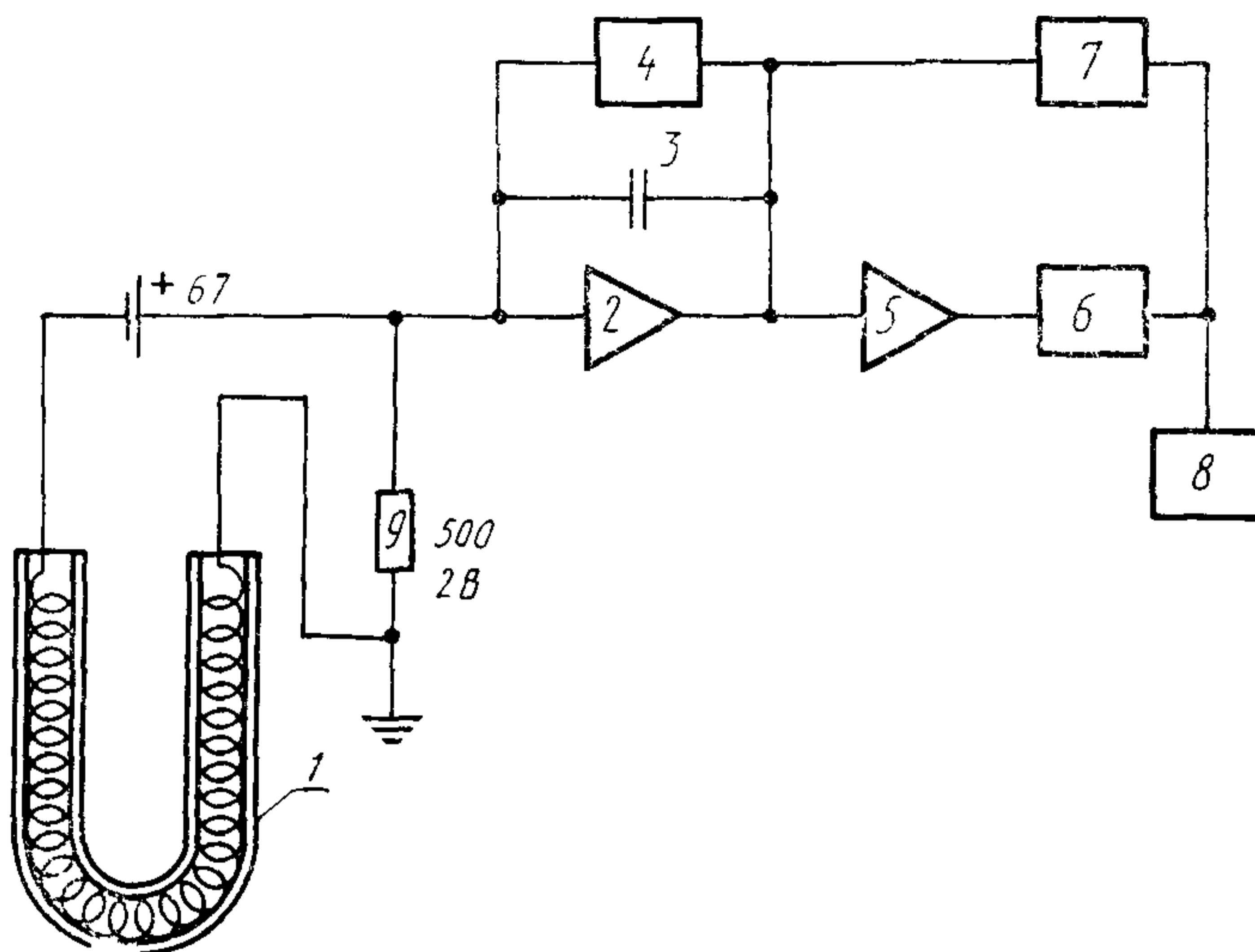
1 — электролитическая ячейка; 2 — интегратор; 3 — конденсатор; 4 — разрядное устройство; 5 — компаратор; 6 — мультивибратор; 7 — триггер; 8 — цифровой дисплей; 9 — сопротивление
