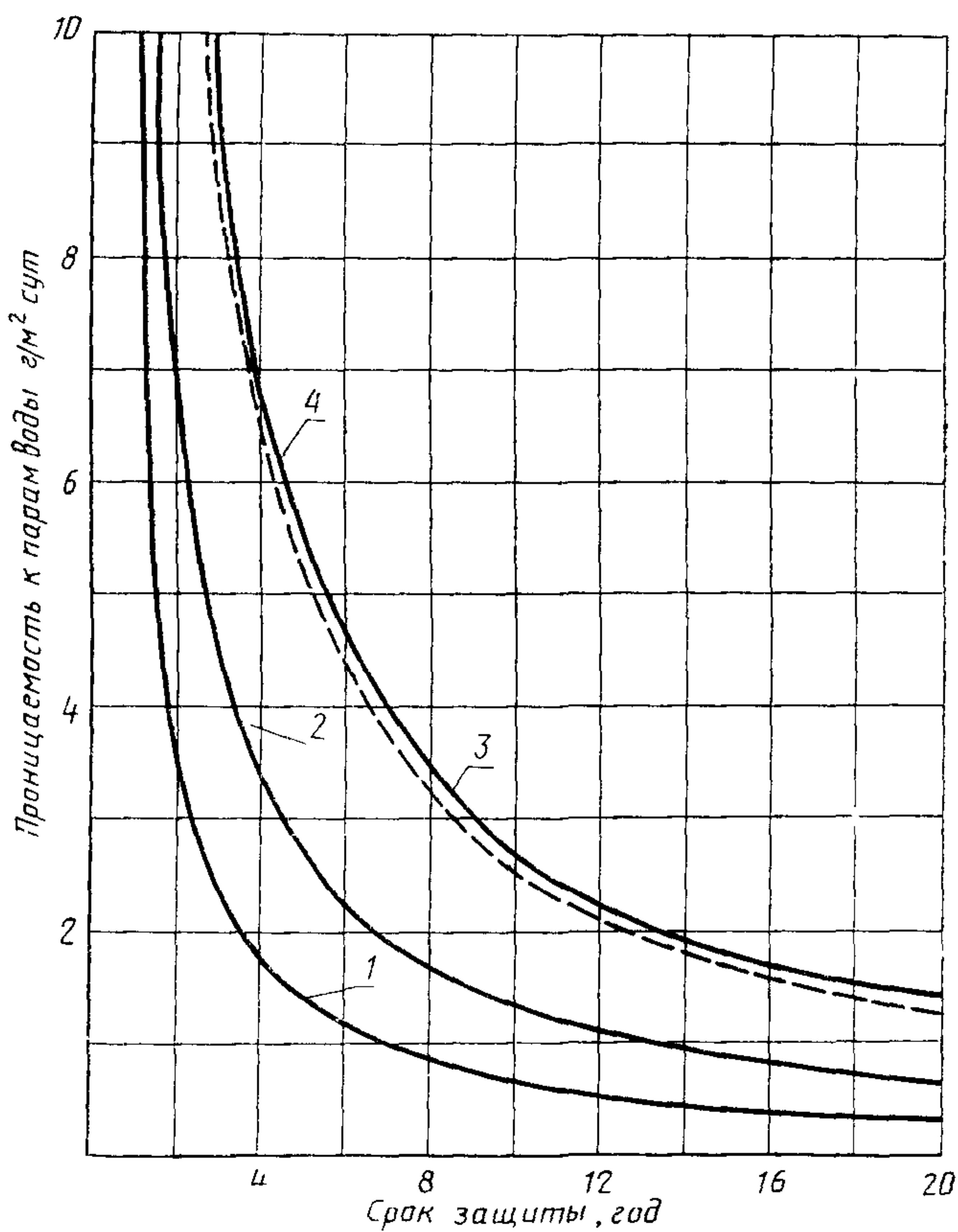
1, 2, 3, 4—номограммы для норм закладки силикагеля 1—0,5 кг/м<sup>2</sup>, 2—1,0 кг/м<sup>2</sup> ( $t=15$  °C), 3—1,0 кг/м<sup>2</sup> ( $t=5$  °C), 4—2,0 кг/м<sup>2</sup>
