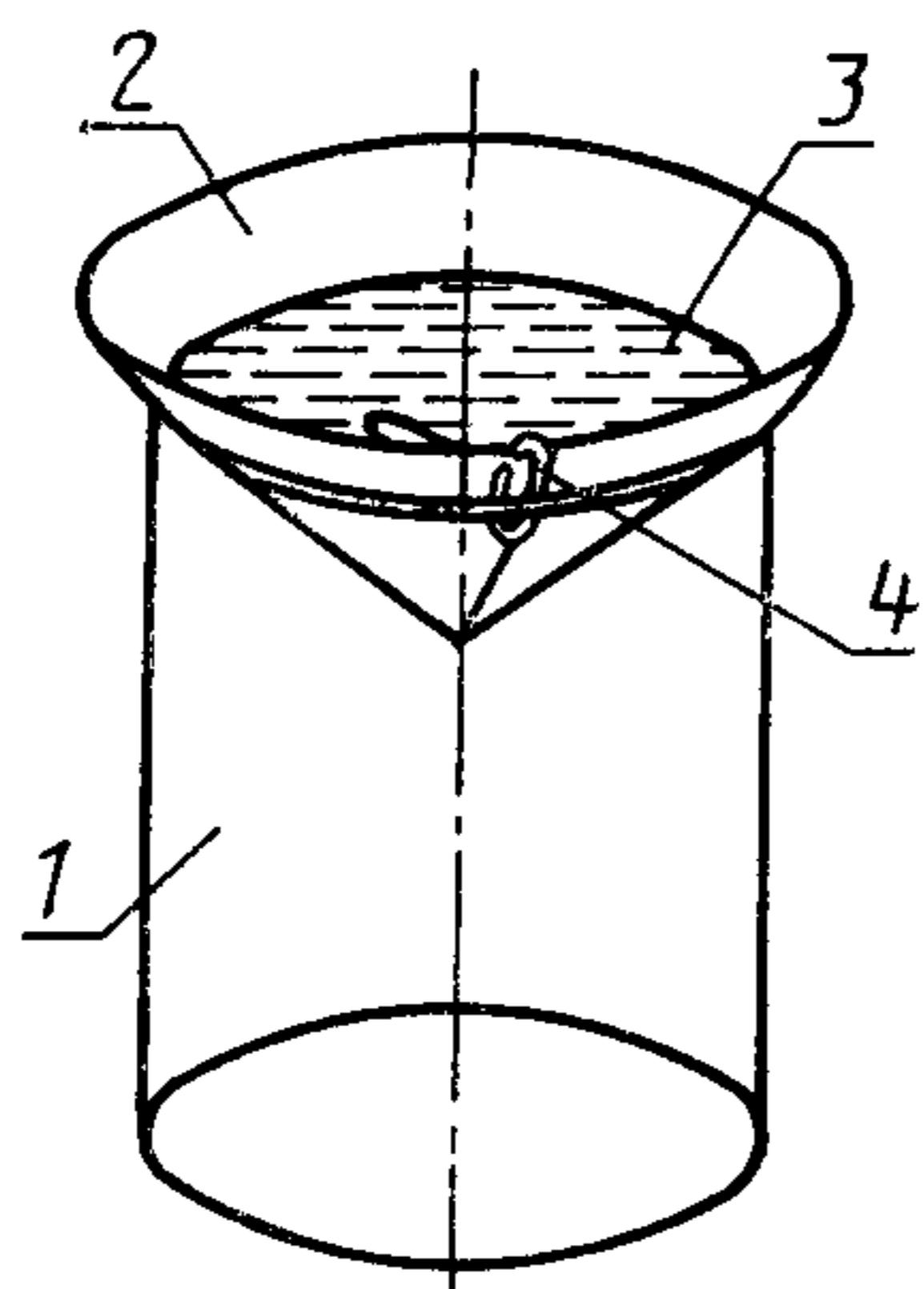
1—стеклянный стакан; 2—образец; 3—дистиллированная вода, 4—скрепка
