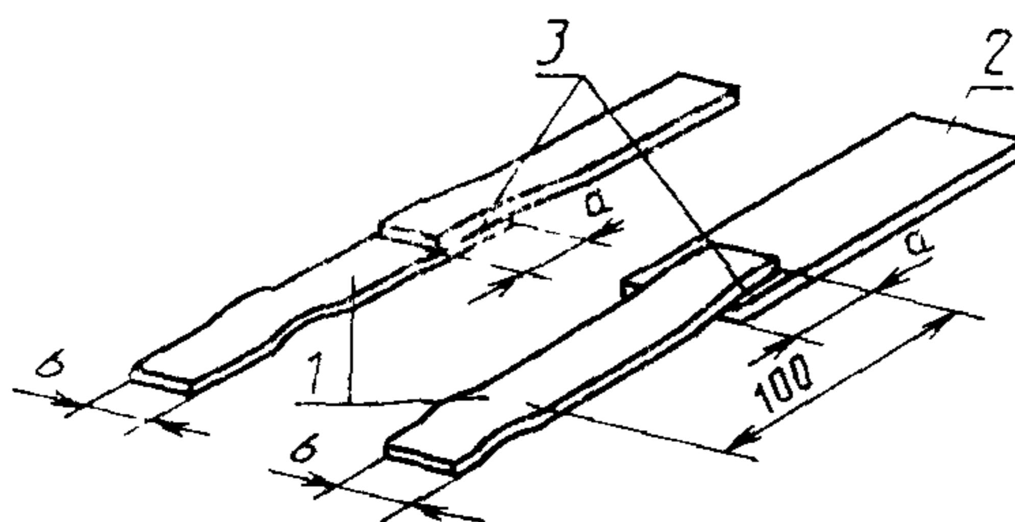
1—образцы или пробы; 2—металлическая пластина; 3—слой клея
