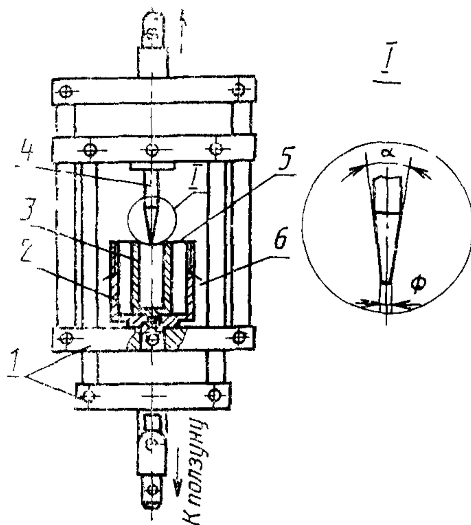
1—приспособление для испытания на сжатие, 2—стакан; 3—опора, 4—наконечник, 5—образец или гроба; 6—стяжная лента
