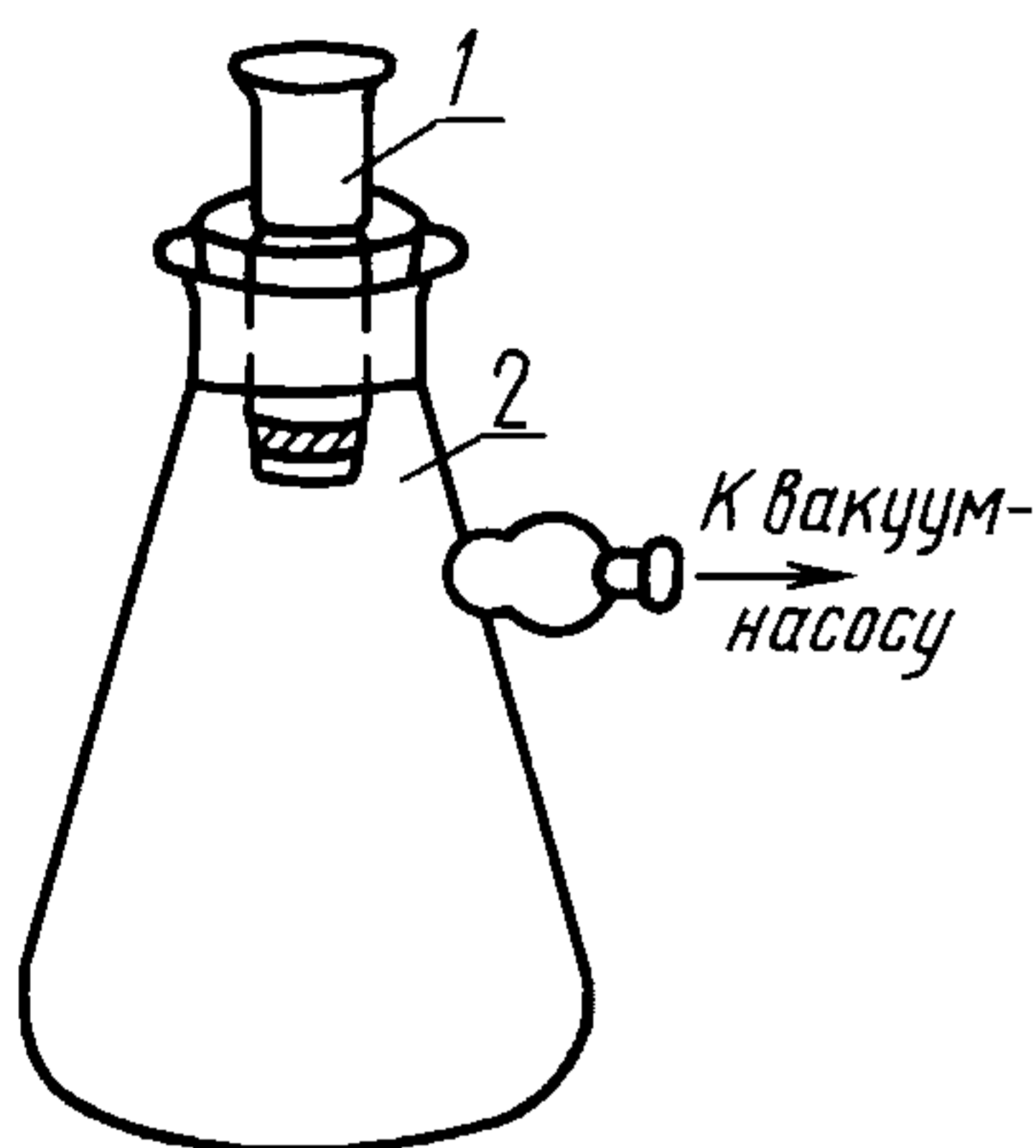
1 — тигель или воронка стеклянные фильтрующие; 2 — колба для фильтрования под вакуумом
