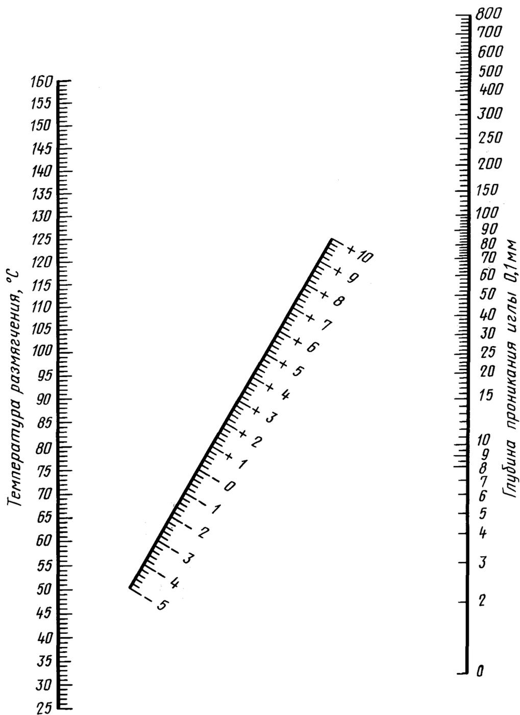
ТАБЛИЦА ОПРЕДЕЛЕНИЯ ИНДЕКСОВ ПЕНЕТРАЦИИ БИТУМОВ
