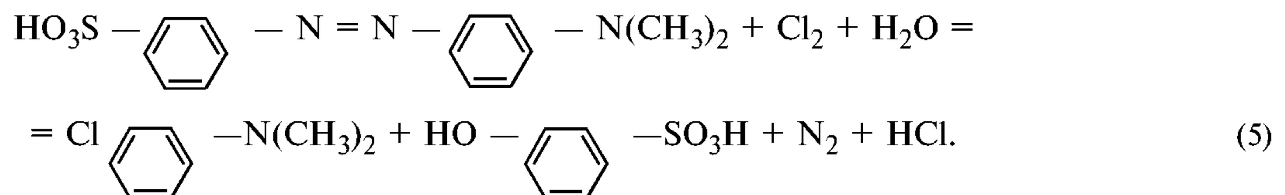
В результате окисления метилового оранжевого окраска его растворов становится менее интенсивной. Интенсивность окраски зависит от порядка смешивания растворов, поэтому анализируемую соляную кислоту добавляют последней при перемешивании. Метод отличается избирательностью, железо (III) мешает определению. Диапазон измерения  $5 \cdot 10^{-4} — 8 \cdot 10^{-3} \%$ .
