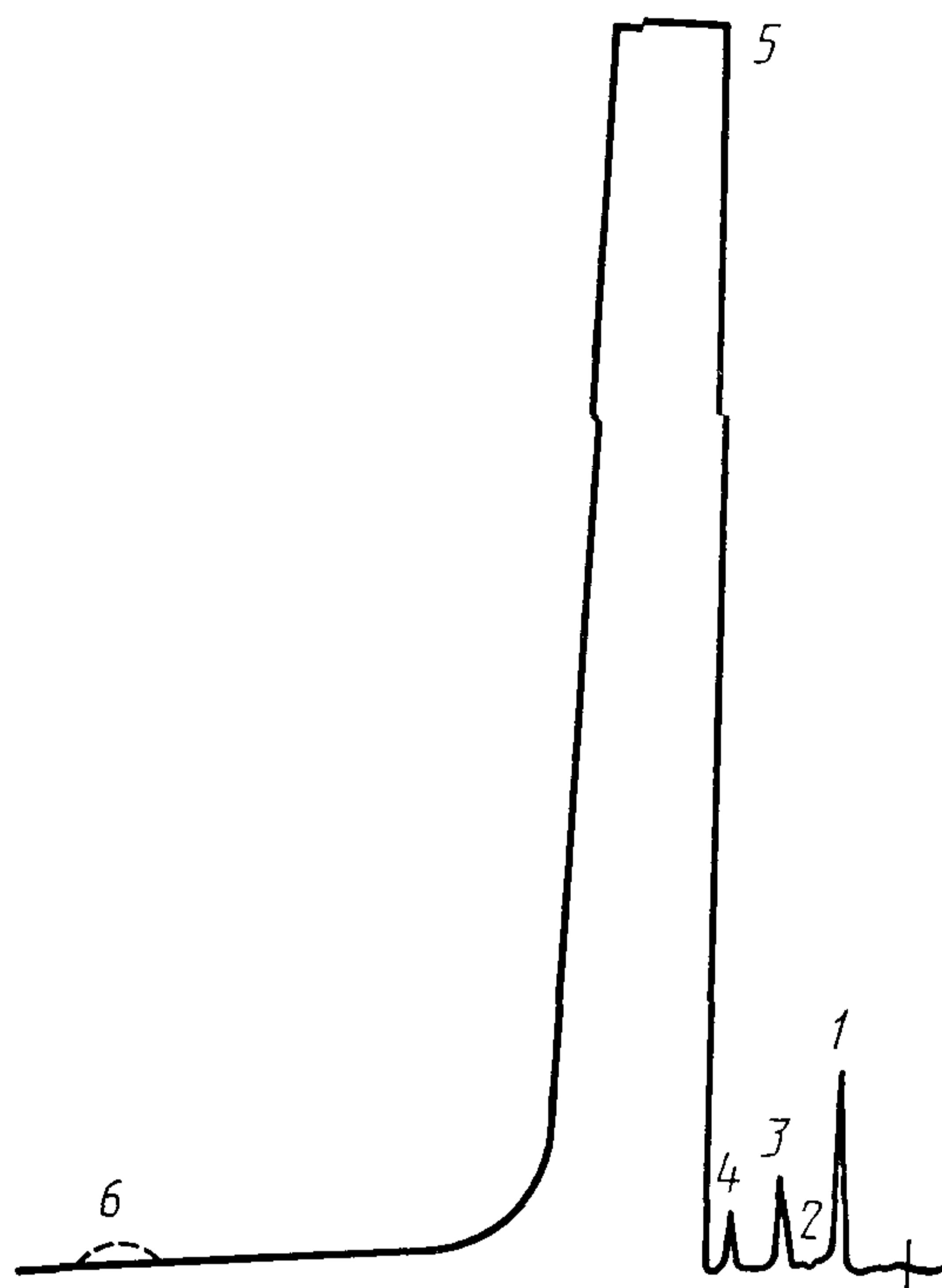
1—воздух; 2—двуокись углерода; 3—трифторметан, 4—дифтордихлорметан, 5—дифторхлорметан; 6—фтордихлорметан
