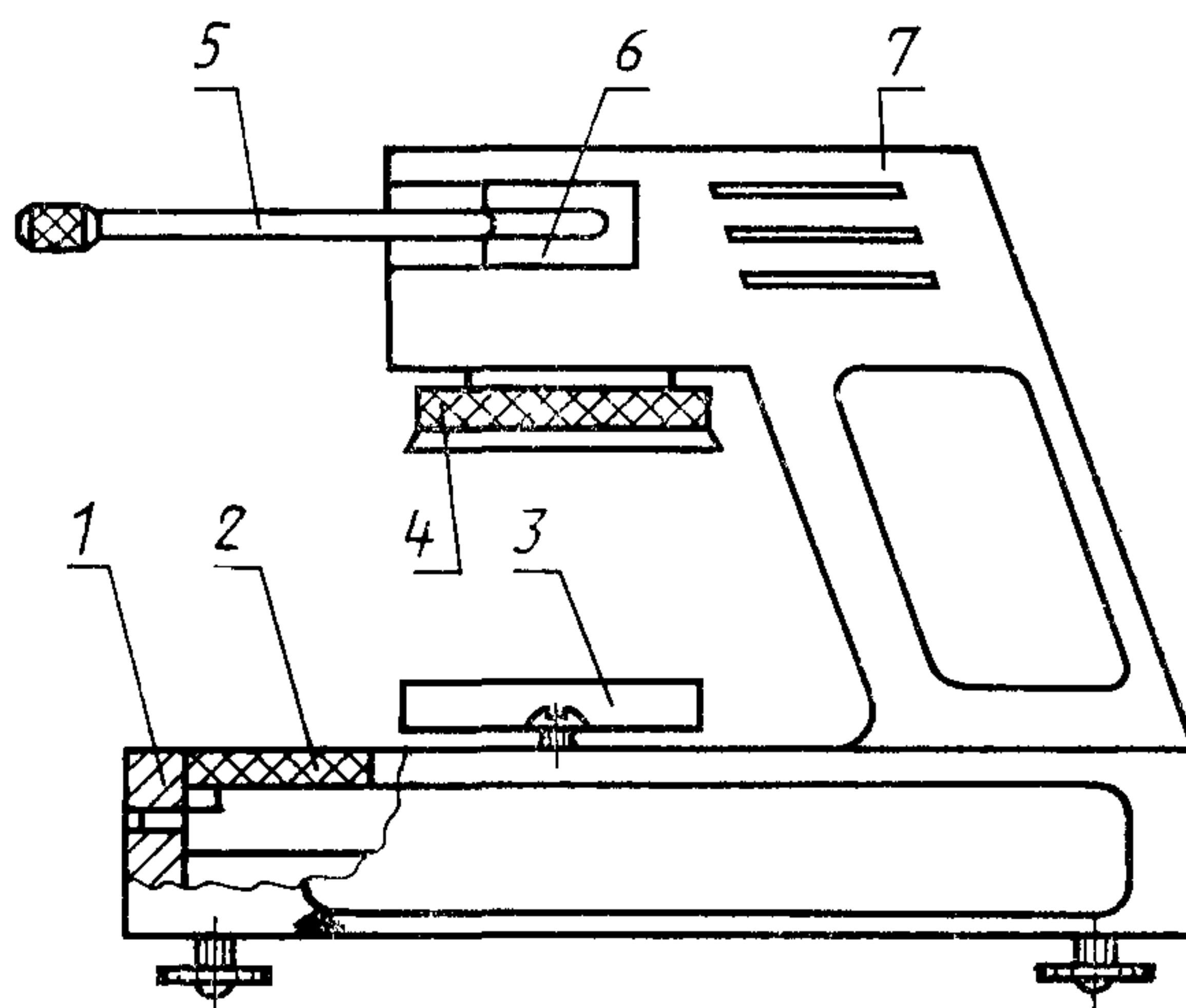
1—основание; 2—часовой индикатор; 3—платформа; 4—плавающая прижимная платформа; 5—ручка управления; 6—винтовая пара; 7—корпус
