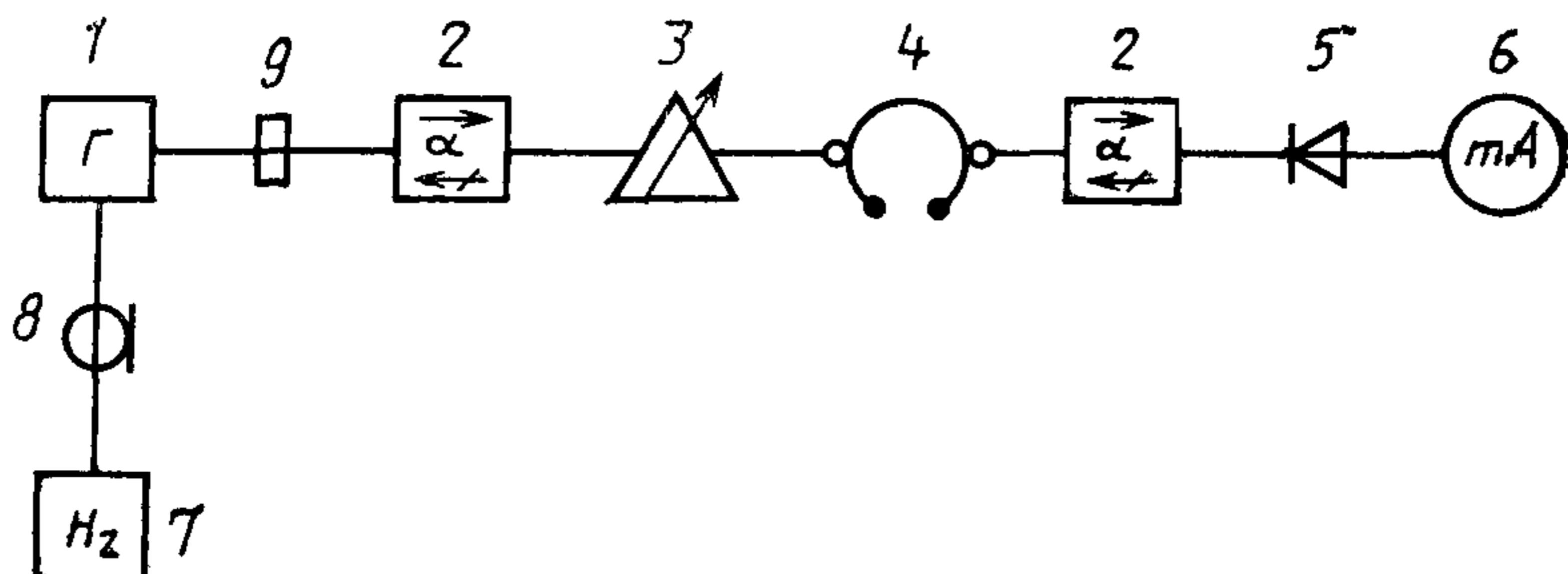
1—генератор СВЧ типа Г4—83; 2—ферритовый вентиль типа Э6—44; 3—волноводный поляризационный аттенюатор типа ДЗ—33А; 4—измерительная ячейка типа ОР-2М; 5—детекторная головка типа Э7—6; 6—микроамперметр типа М95 (10 мкА); 7—электронно-счетный частотомер типа ЧЗ—54 с преобразователем типа ЯЗЧ-87; 8—коаксиальный проводник; 9—волновод
