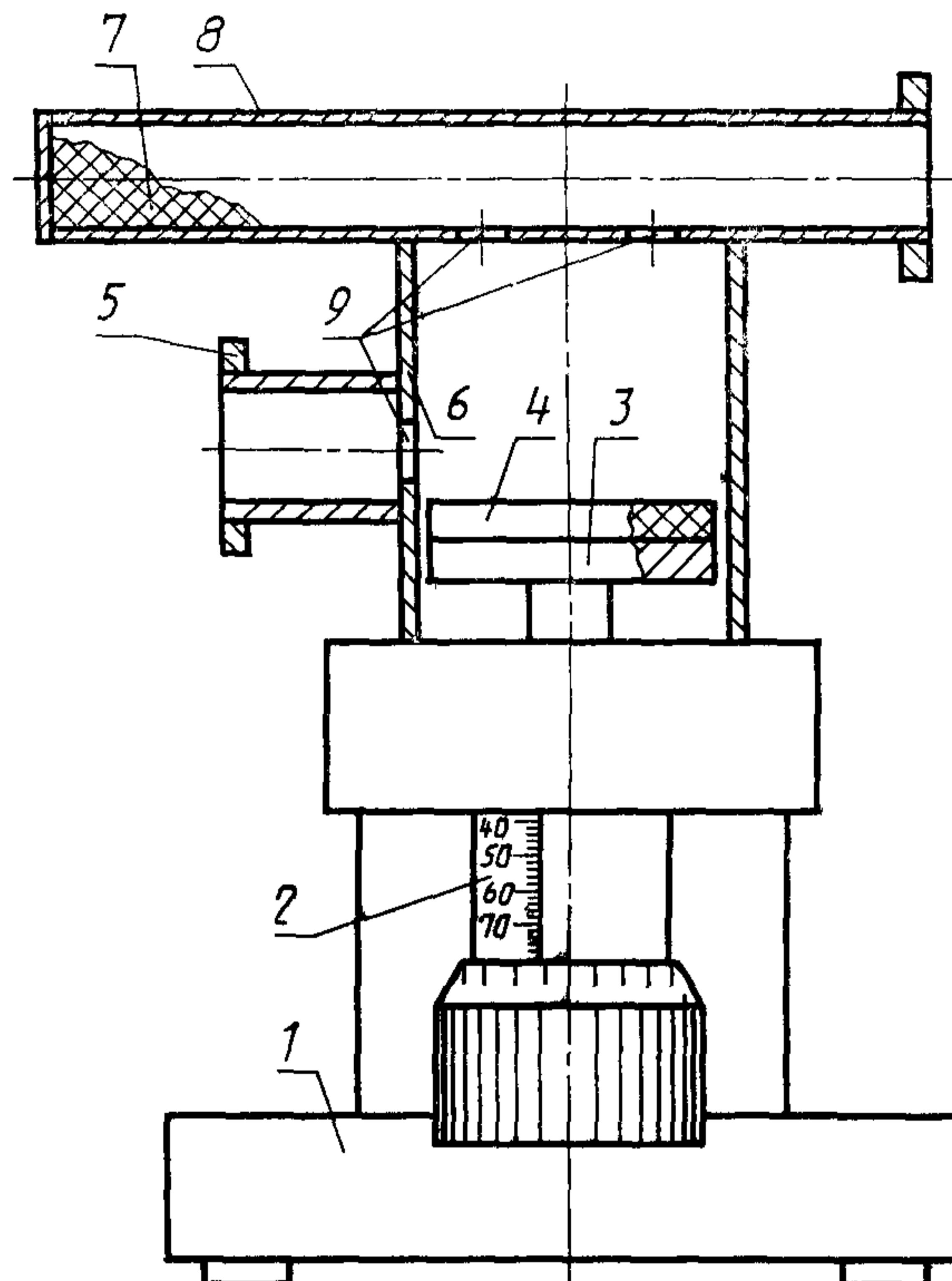
1—основание; 2—микрометрическая головка; 3—поршень; 4—образец диэлектрика; 5—фланец; 6—резонатор; 7—поглотитель; 8—волновод; 9—отверстия связи
