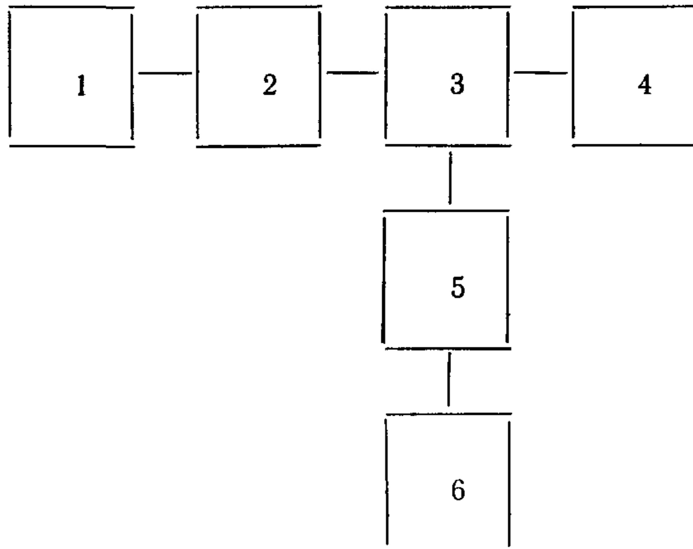
1—имитатор контролируемой среды; 2—образцовое средство измерения информативного параметра входного сигнала; 3—проверяемый плотномер; 4—источник питания плотномера; 5—средство измерения параметров питания; 6—образцовое средство измерения информативного параметра выходного сигнала
