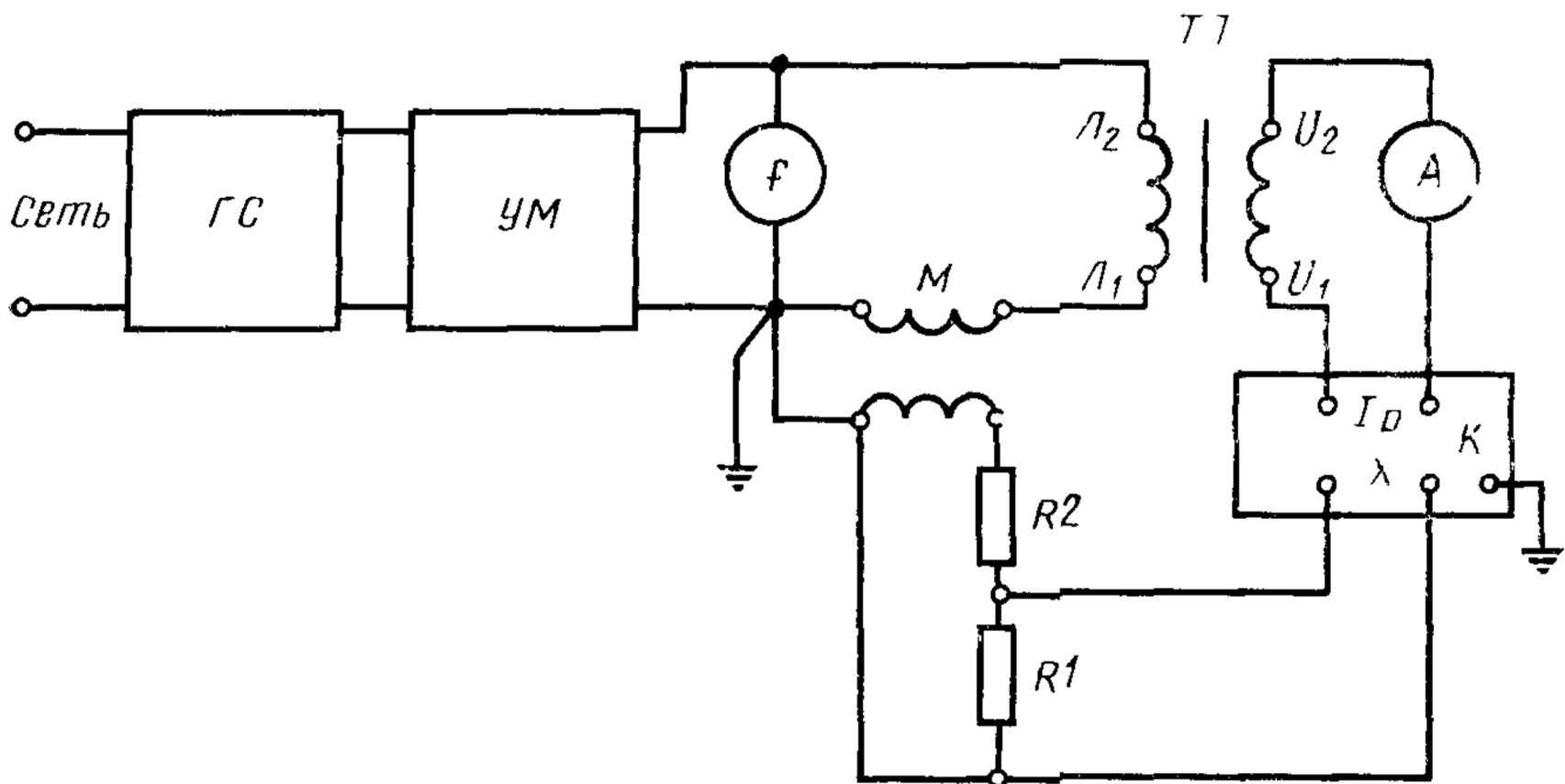
ГС—низкочастотный измерительный генератор сигналов | УМ—усилитель мощности, К—поверяемый компенсатор, М—образцовая мера взаимной индуктивности; R1, R2—образцовые меры (магазины) сопротивления, А—амперметр, ТТ—трансформатор тока, f—частотомер
