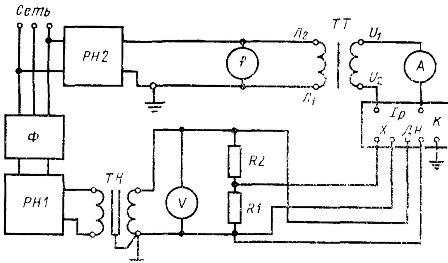
$\Phi$ —фазорегулятор;  $RН1$ ,  $RН2$ —регуляторы напряжения;  $ТН$ —трансформатор напряжения;  $V$ —вольтметр;  $R1$ ,  $R2$ —образцовые меры (магазины) сопротивления;  $ТТ$ —трансформатор тока;  $К$ —поверяемый компенсатор;  $A$ —амперметр;  $f$ —частотометр
