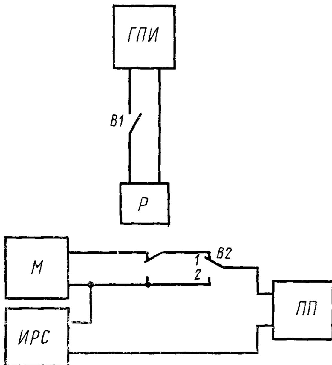
ГПИ—генератор прямоугольных периодических импульсов, М—мера входного сигнала ИРС—источник регулируемого сигнала, Р—реле, В1—однополюсный переключатель, В2—двухполюсный переключатель
