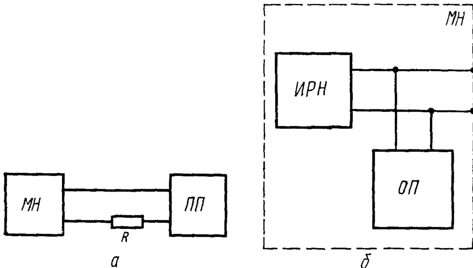
$MH$ —мера напряжения,  $R$ —резистор;  $ИРН$ —источник регулируемого напряжения;
