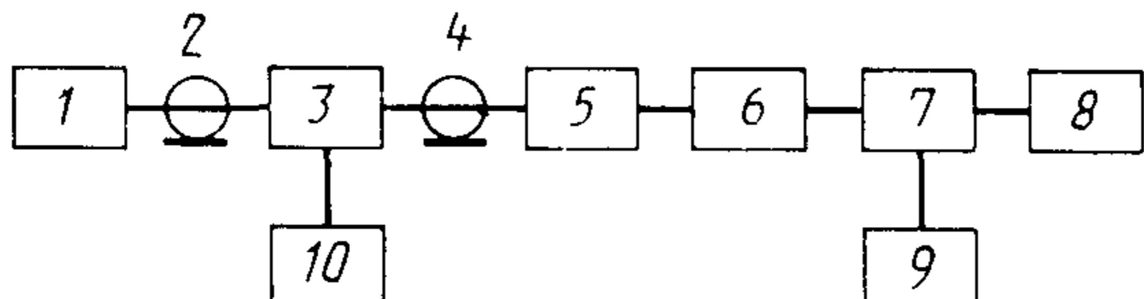
1—измерительный генератор, 2, 4—коаксиальный кабель; 3—коаксиальный переключатель 5—фильтр, 6—коаксиальный соединитель, 7—образцовый делитель напряжения; 8—проверяемый вольтметр; 9—образцовый вольтметр, 10—нагрузочный резистор
