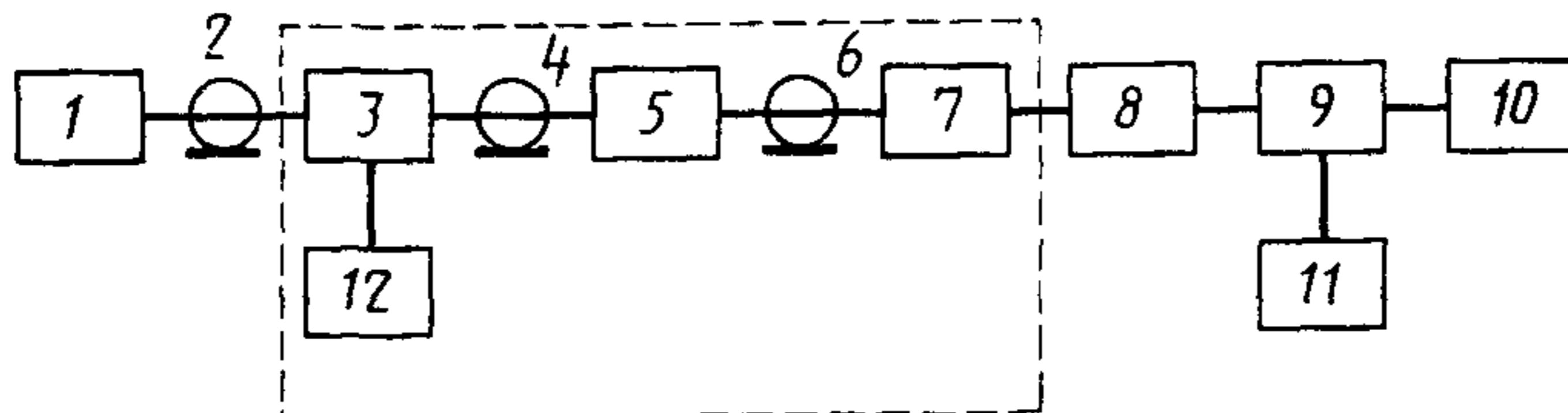
1—измерительный генератор; 2, 4, 6—коаксиальный кабель; 3—коаксиальный переключатель; 5—фильтр; 7—согласующее устройство; 8—коаксиальный соединитель; 9—коаксиальный измерительный соединитель-тройник (например элемент № 11—1 из комплекта вольтметра типа ВЭ—24); 10—проверяемый вольтметр; 11—образцовый вольтметр; 12—нагрузочный резистор
