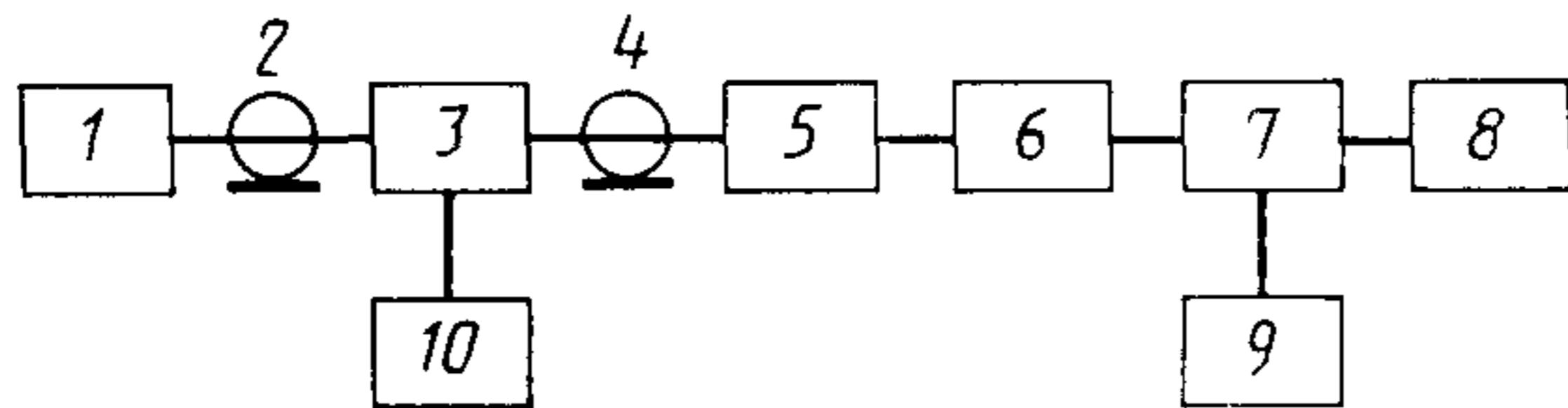
1—измерительный генератор, 2, 4—коаксиальный кабель; 3—коаксиальный переключатель; 5—фильтр, 6—коаксиальный соединитель; 7—коаксиальный измерительный соединитель-тройник (например элемент № 11 из комплекта вольтметра типа В3—24); 8—проверяемый вольтметр, 9—образцовый вольтметр, 10—нагрузочный резистор
