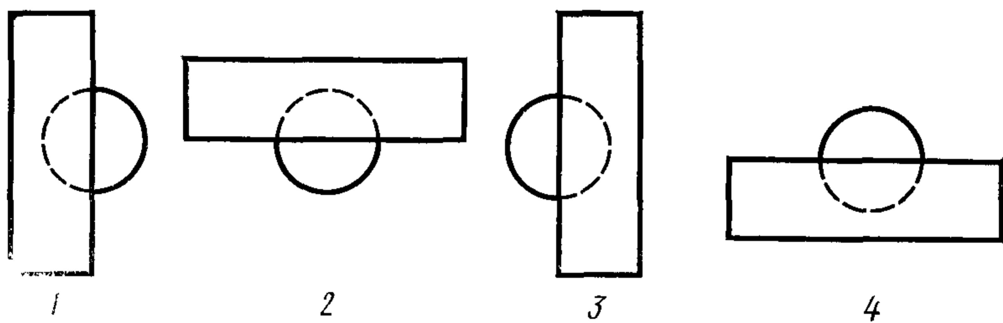
Регулировочными винтами добиваются такого положения стола, при котором наибольшая разность между показаниями прибора при указанных выше положениях меры не превысит 0,0005 мм.
