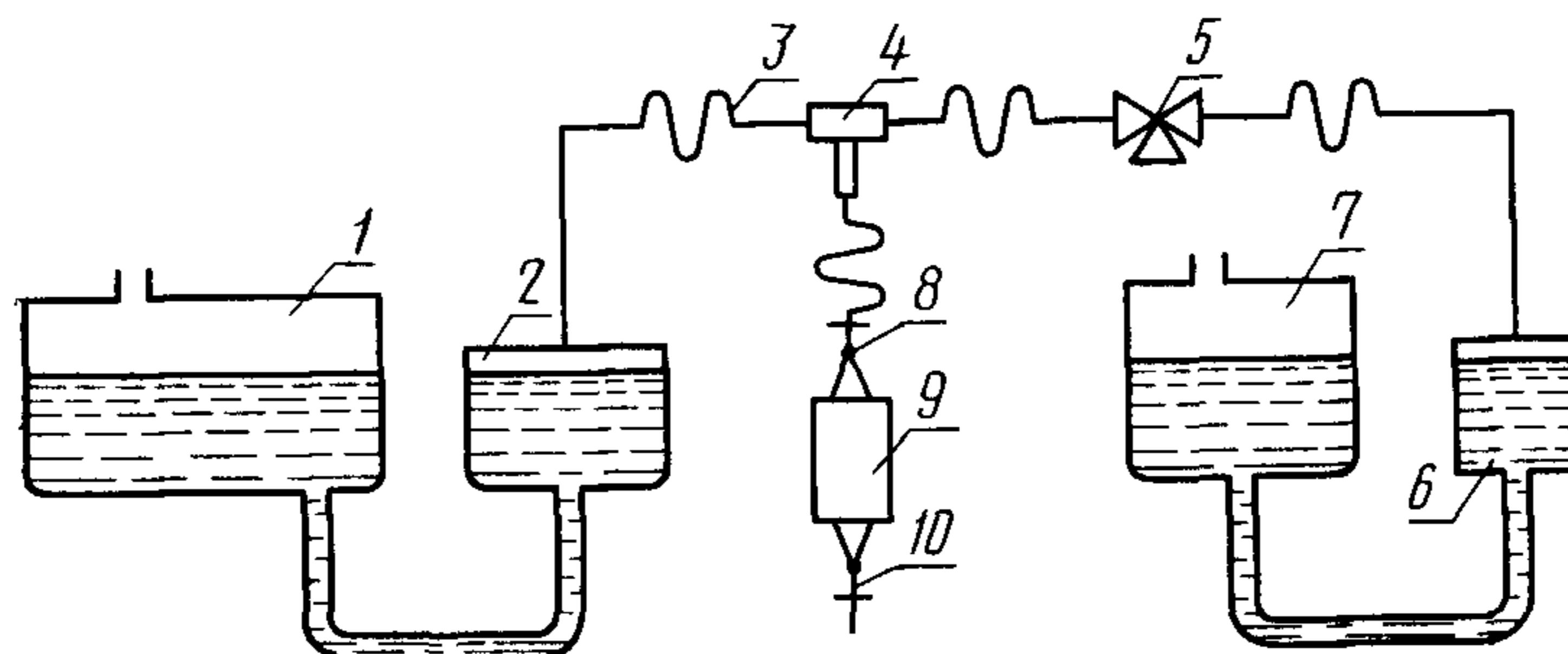
1, 2—подвижный и неподвижный сосуды рабочего эталона; 3—резиновые трубы; 4—треугольник; 5—пробковый трехходовой кран; 6, 7—неподвижный и подвижный сосуды проверяемого микроманометра; 9—сильфонный пресс с кранами 8, 10
