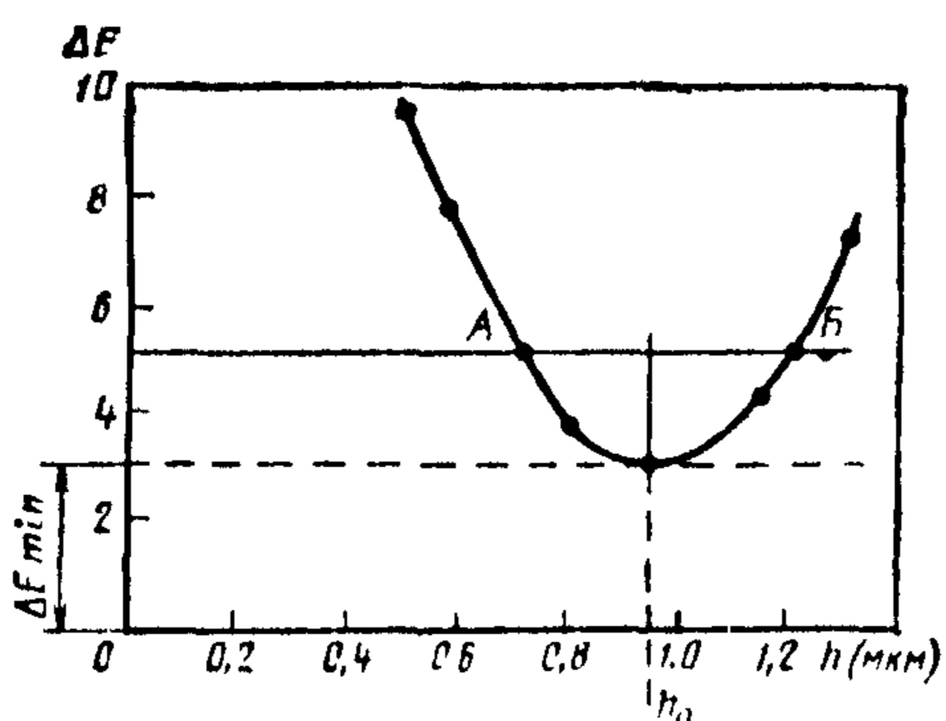
$\Delta E_{\min}$  — минимальное цветовое различие;  $h_0$  — оптимальная толщина красочного слоя, соответствующая минимальному цветовому различию, мкм
