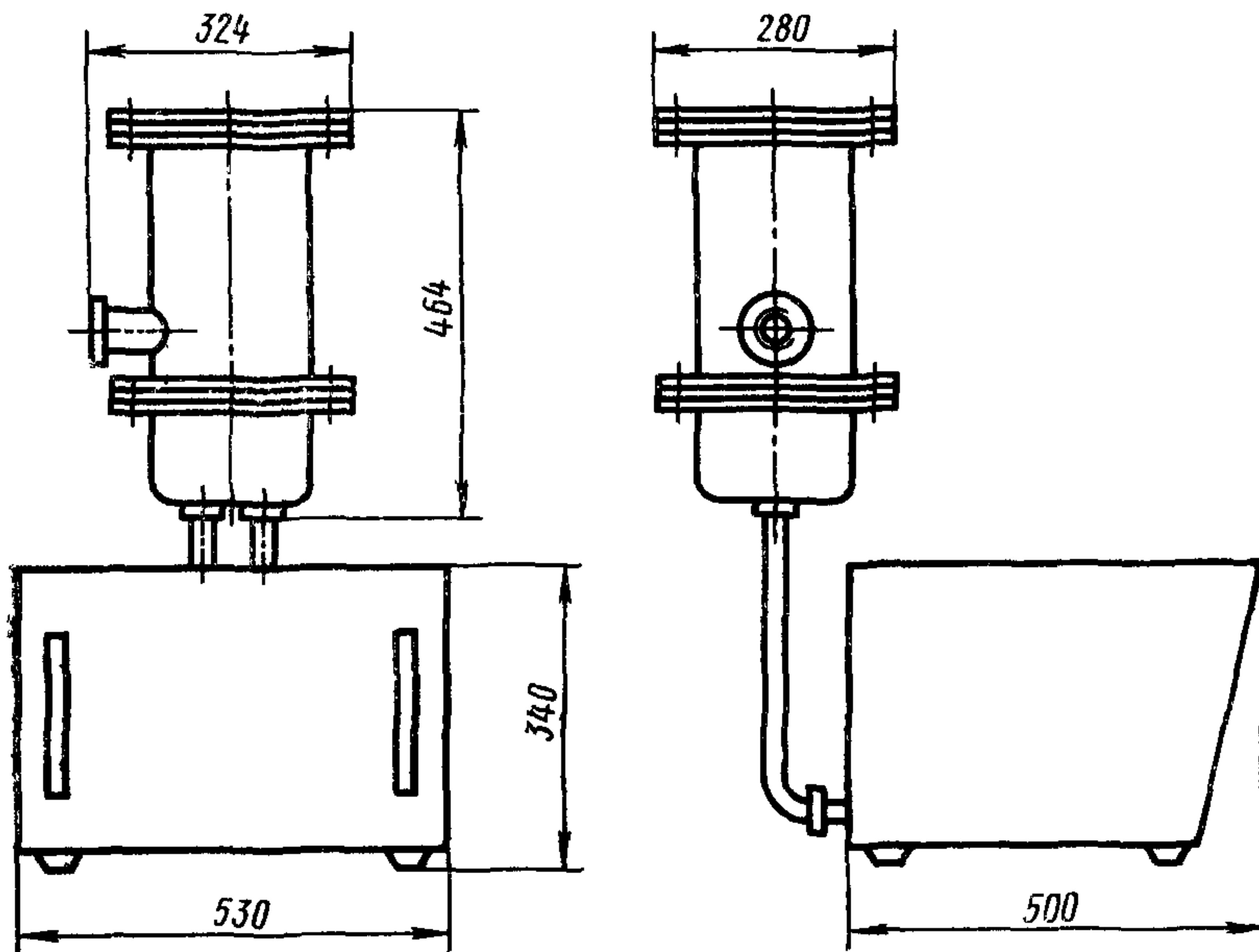
Пример условного обозначения насоса геттерно-ионного:
