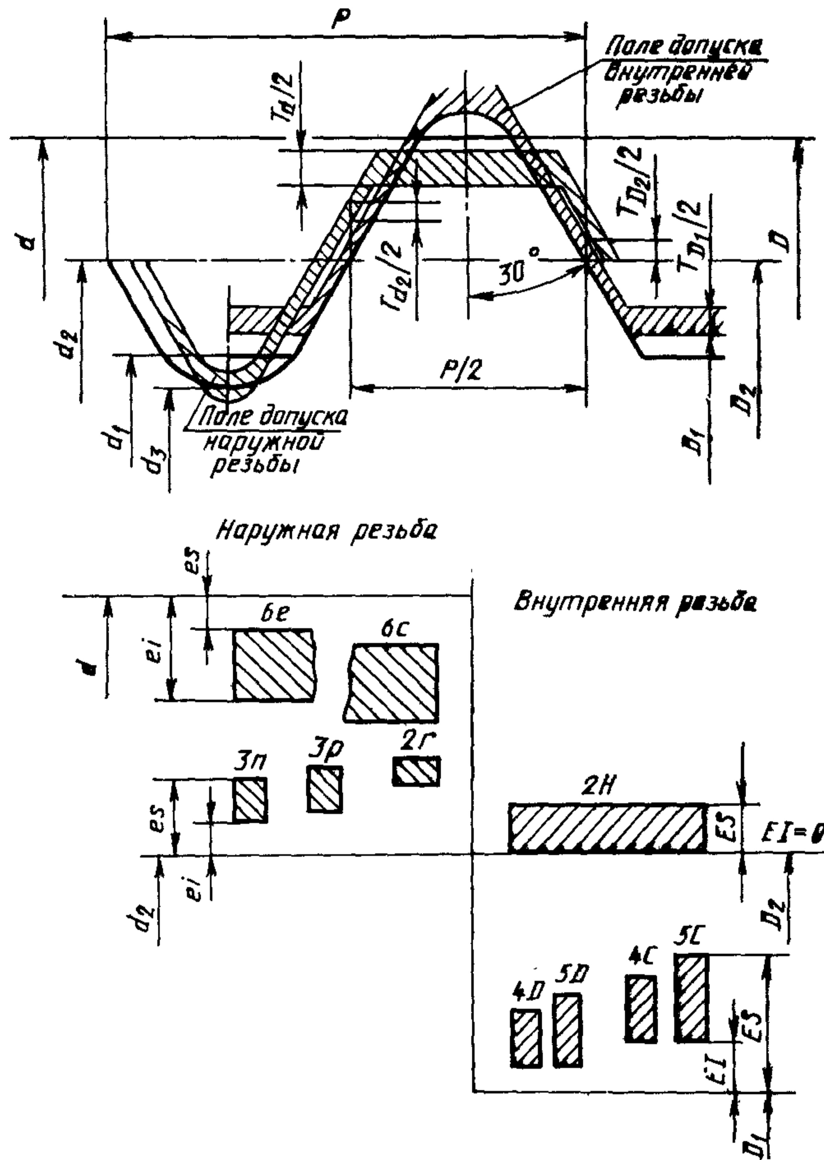
$e_i$  — нижнее отклонение диаметров наружной резьбы;  $EI$  — нижнее отклонение диаметров внутренней резьбы;  $e_s$  — верхнее отклонение диаметров наружной резьбы;  $ES$  — верхнее отклонение диаметров внутренней резьбы;  $T$  — допуск диаметров резьбы (диаметр резьбы дается в индексе)
