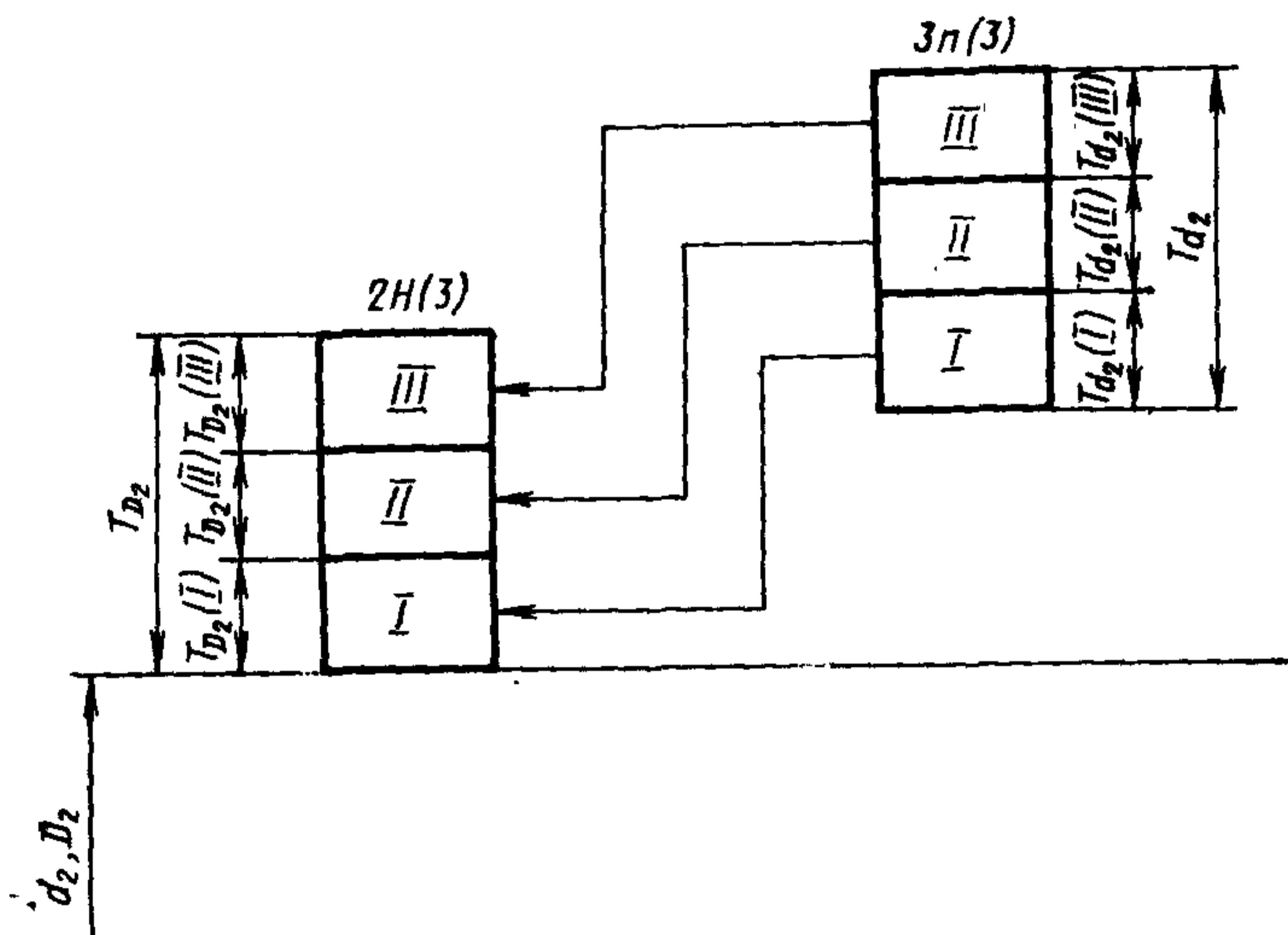
$T_{d_2}$  — поле допуска среднего диаметра наружной резьбы;  $T_{D_2}$  — поле допуска среднего диаметра внутренней резьбы;  $T_{d_2}(I)$ ,  $T_{d_2}(II)$ ,  $T_{d_2}(III)$  — поля допусков групп наружной резьбы;  $T_{D_2}(I)$ ,  $T_{D_2}(II)$ ,  $T_{D_2}(III)$  — поля допусков групп внутренней резьбы, I, II, III — номера сортировочных групп
