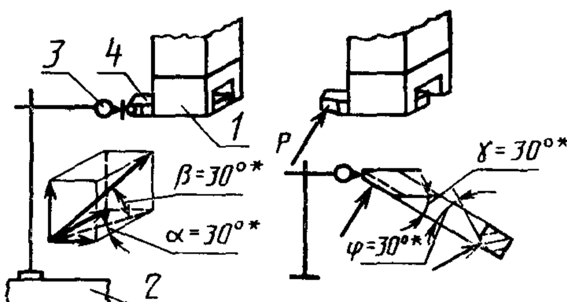
\* $\alpha$  — угол между проекцией нагружающей силы  $P$  на горизонтальную плоскость и следом вертикальной плоскости, перпендикулярной плоскости портала;
