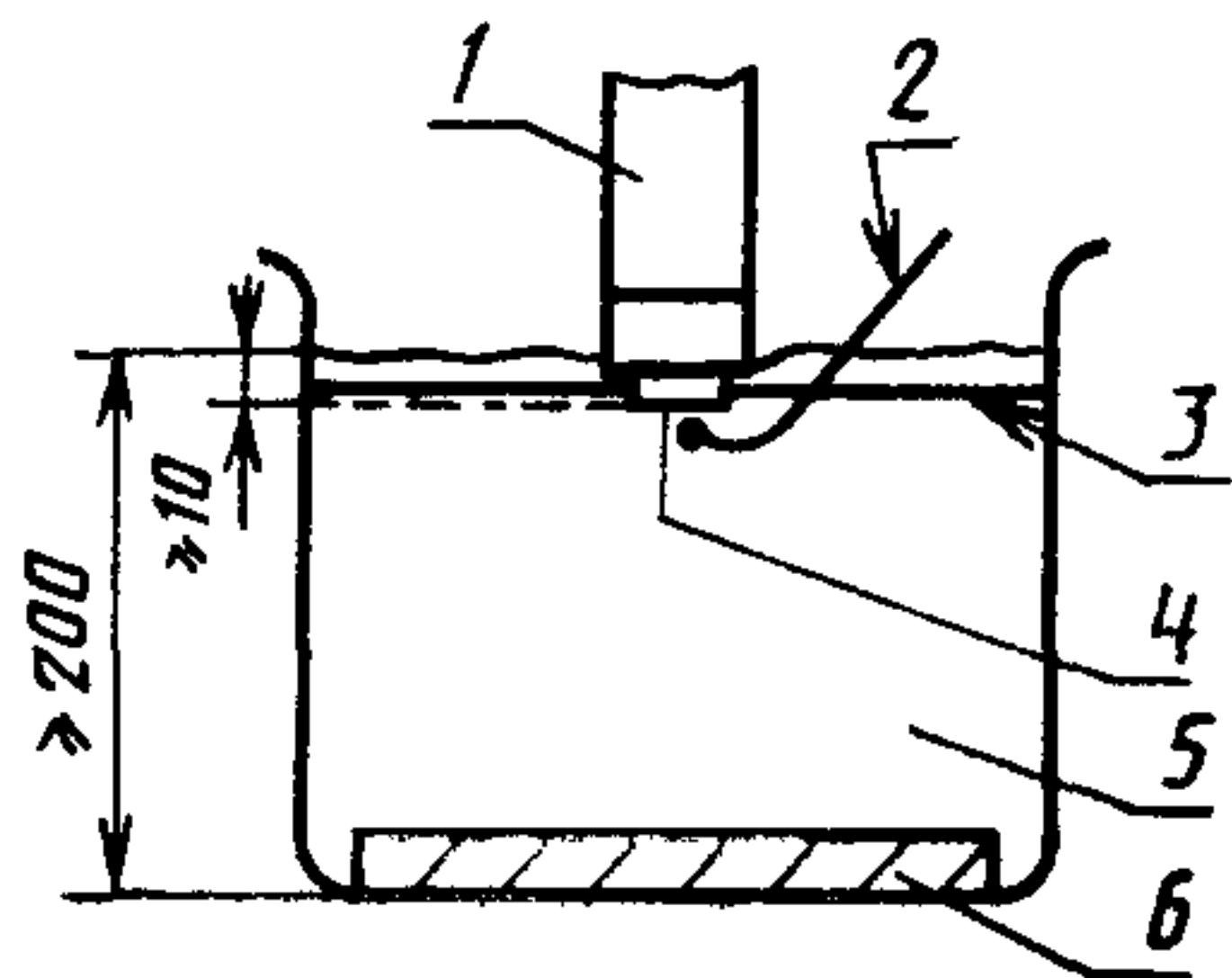
1 — ЛЕЧЕБНАЯ ГОЛОВКА; 2 — устройство для измерения температуры (может быть приложено к головке после изъятия ее из воды), 3 — опора для ЛЕЧЕБНОЙ ГОЛОВКИ; 4 — излучающая поверхность; 5 — вода начальной температурой  $(25 \pm 1)^\circ\text{C}$ , 2 л; 6 — материал, поглощающий ультразвук
