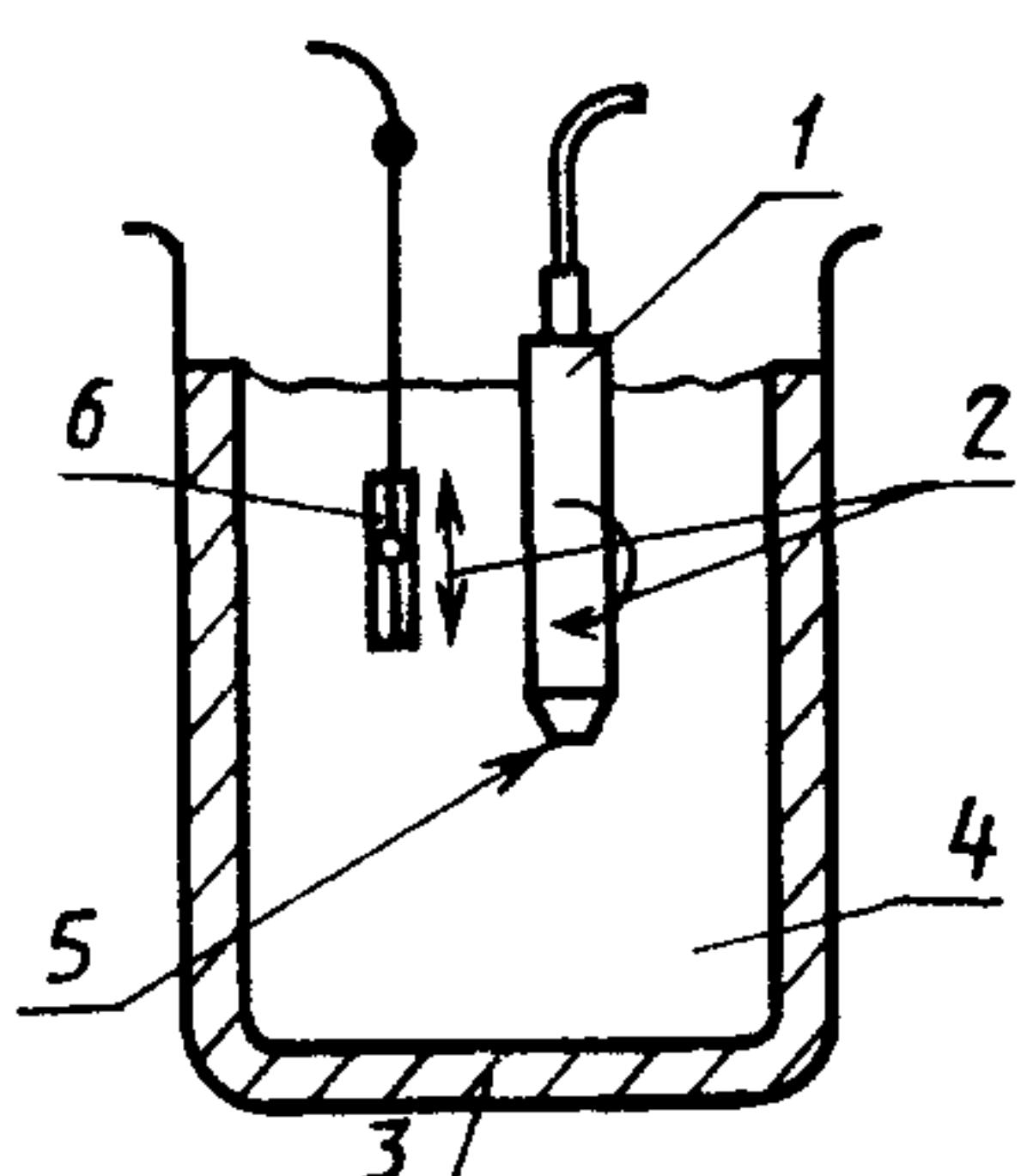
1 — ЛЕЧЕБНАЯ ГОЛОВКА; 2 — движение гидрофона и/или ЛЕЧЕБНОЙ ГОЛОВКИ; 3 — материал, поглощающий ультразвук; 4 — вода температурой  $(25 \pm 3)^\circ\text{C}$ ; 5 — излучающая поверхность; 6 — калиброванный гидрофон
