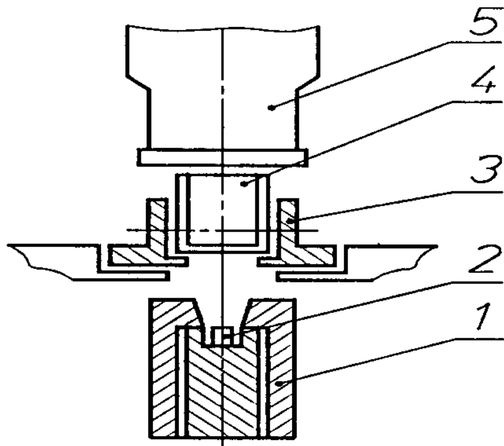
1 — контейнер-коллиматор; 2 — источник излучения; 3 — свинцовый прободержатель; 4 — измерительная кювета; 5 — блок детектирования
