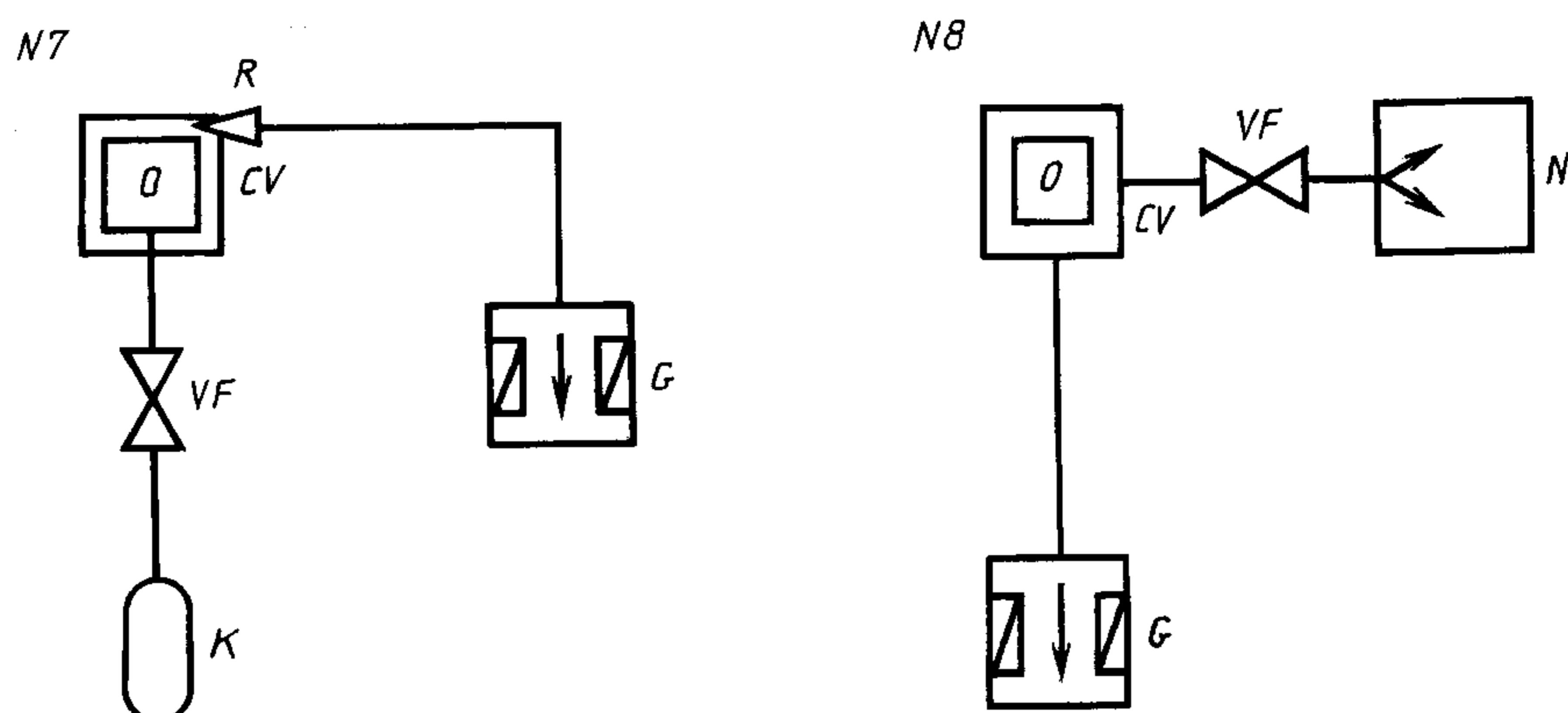
Пояснения к схемам 1—8: *O* — испытуемый объект; *G* — течеискатель; *R* — шуп; *VF* — клапан регулировочный; *N* — насос; *K* — баллон с пробным газом; *D* — обдуватель; *C* — камера, наполненная пробным газом; *CV* — вакуумная камера
