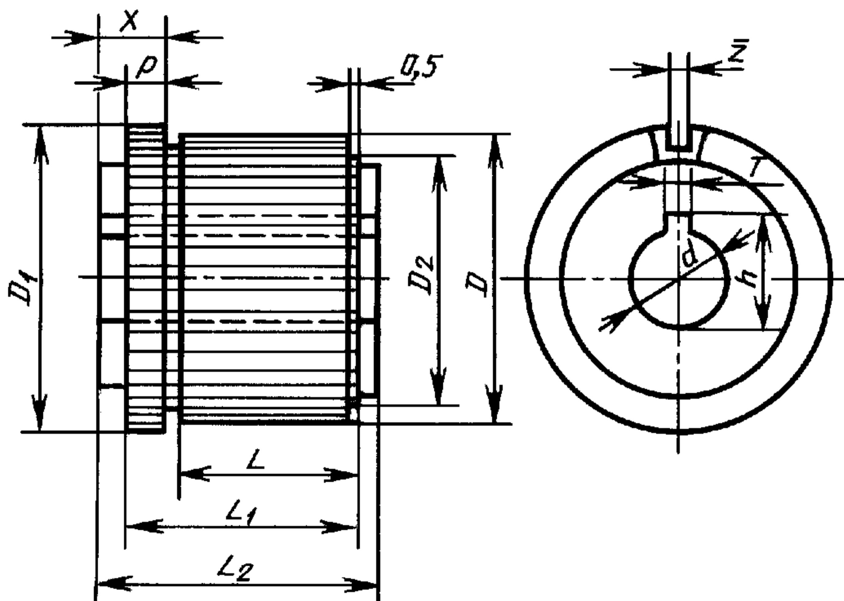
2.2. Номинальные размеры изоляции коллекторных пластин — по ГОСТ 24680. В обоснованных случаях можно выбирать изоляцию коллекторных пластин других размеров.
