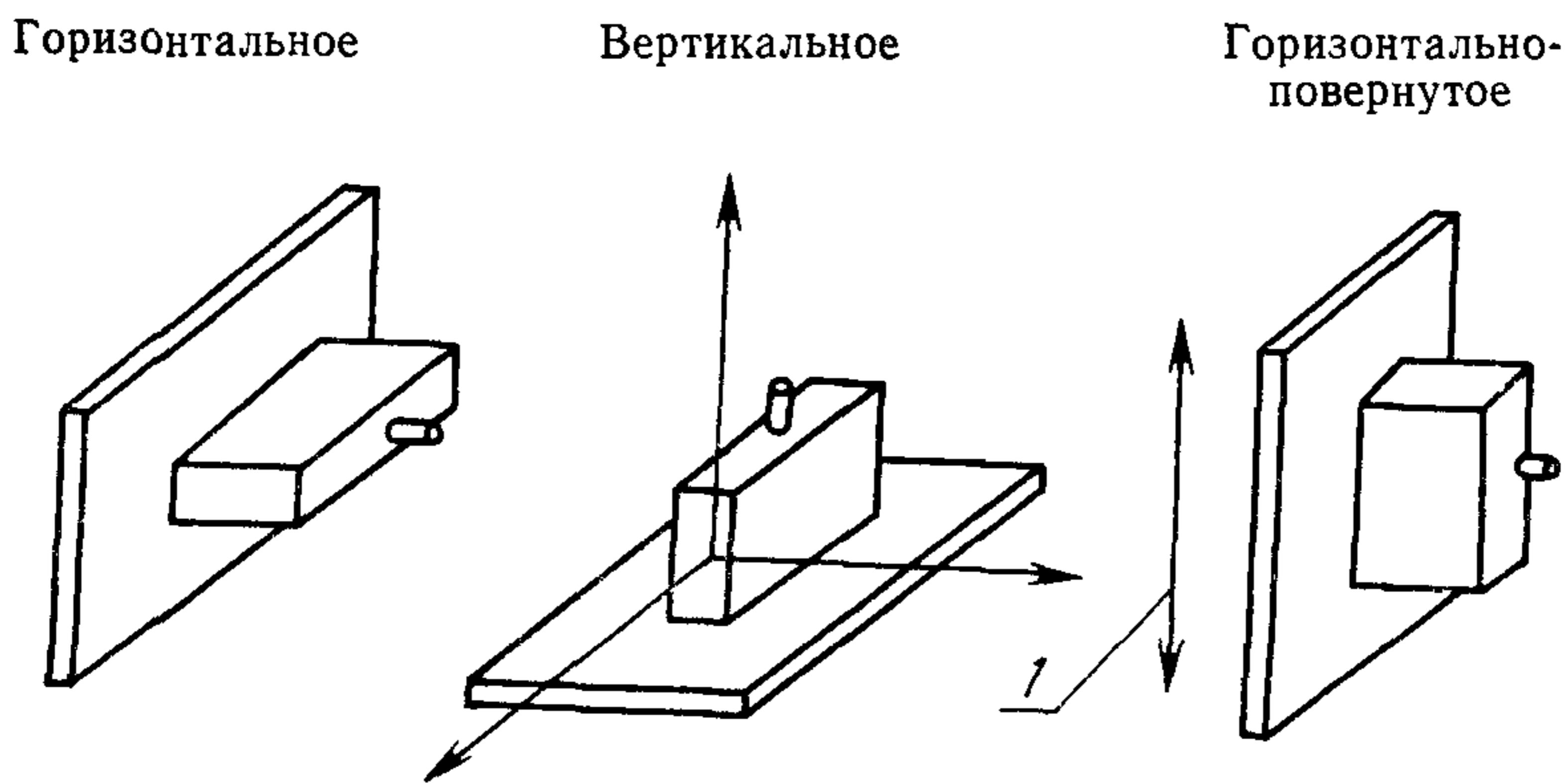
1—направления движения стола вибростенда или ударного стенда
