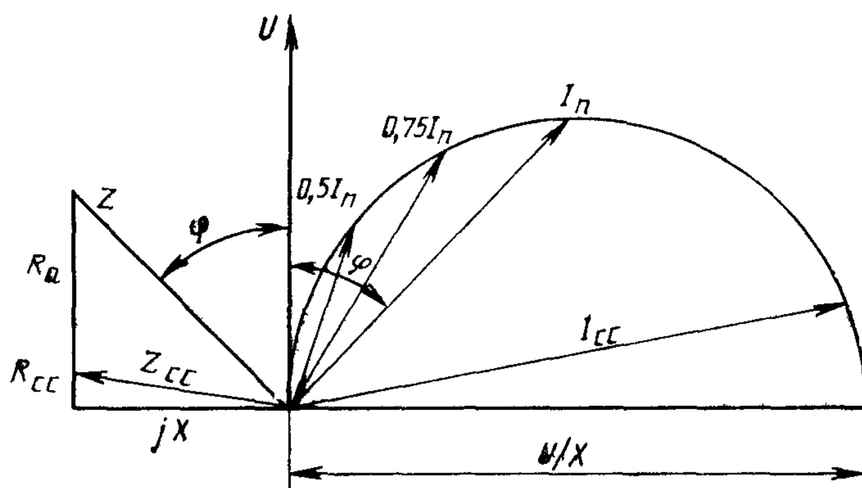
$R_d$  — дуговое сопротивление;  $R_{CC}$  — сопротивление вторичной силовой цепи;  $Z_{CC}$  — полное сопротивление вторичной силовой цепи;  $I_n$  — nominalnyy tok,  $I_{CC}$  — tok вторичной силовой цепи
