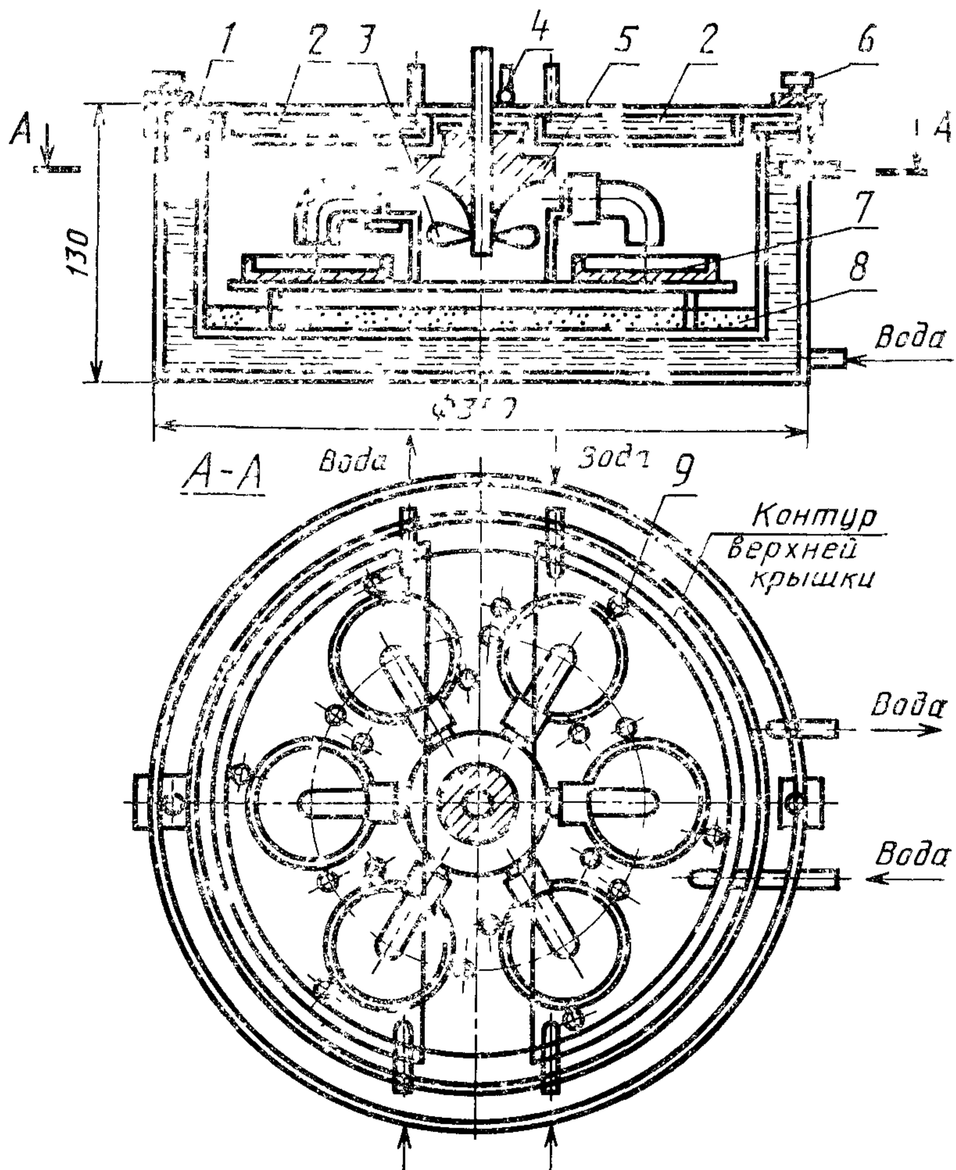
1 — сосуд с двойными стенками, 2 — крышка, состоящая из двух частей, 3 — пропеллер, 4 — термометр, 5 — бронзовый подшипник, 6 — винтовые зажимы, 7 — бюксы, 8 — гибкий резиновый раструб калия, 9 — штифты
